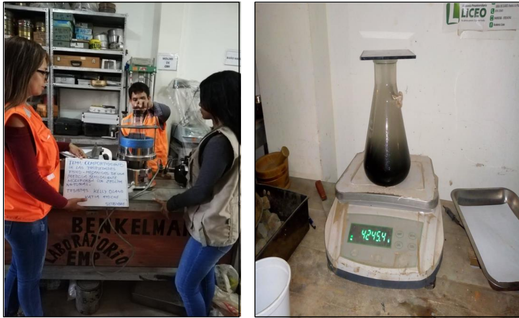
Figura 67: Ensayo para hallar el vacíos de aire en mezcla compactada
