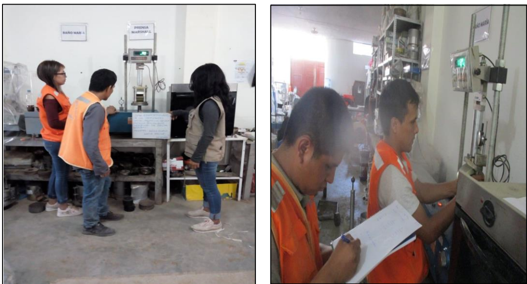
Figura 63: Ensayo de estabilidad y flujo en el Laboratorio de Chiclayo
