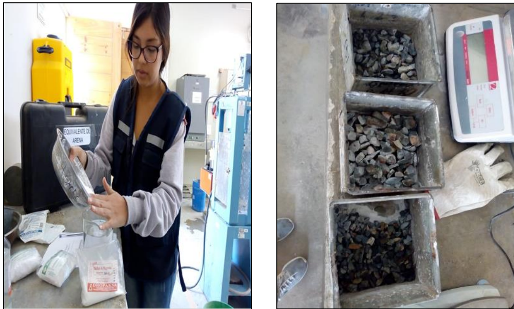
Figura 24: Ensayo de Durabilidad al Sulfato de Magnesio MTC E 209.
