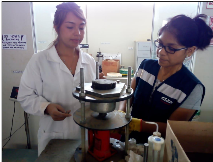
Figura 59: Retirado de muestra con gata hidráulica
