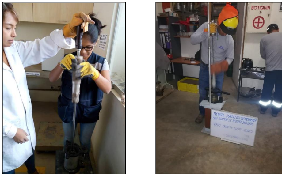
Figura 58: Compactando la mezcla para elaboración del espécimen.
