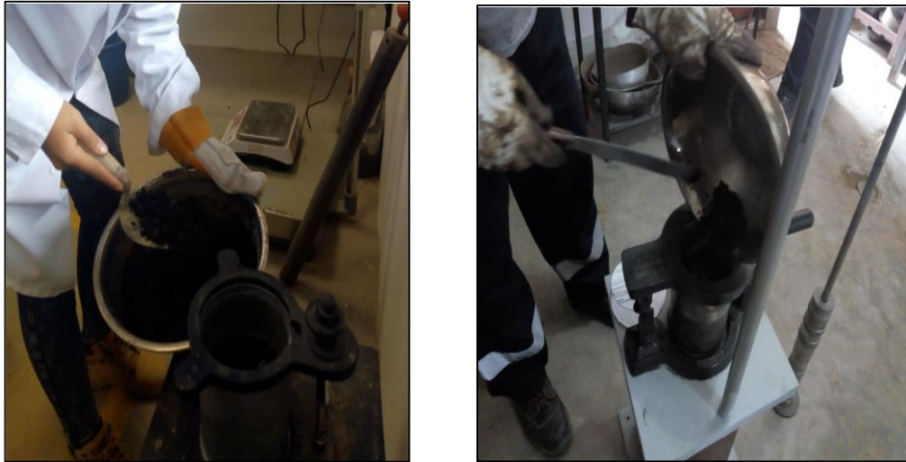
Figura 55: Vaciado de material al molde.
