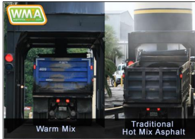
Figura 14: Diferencia de humos entre mezcla convencional y otra semicaliente
