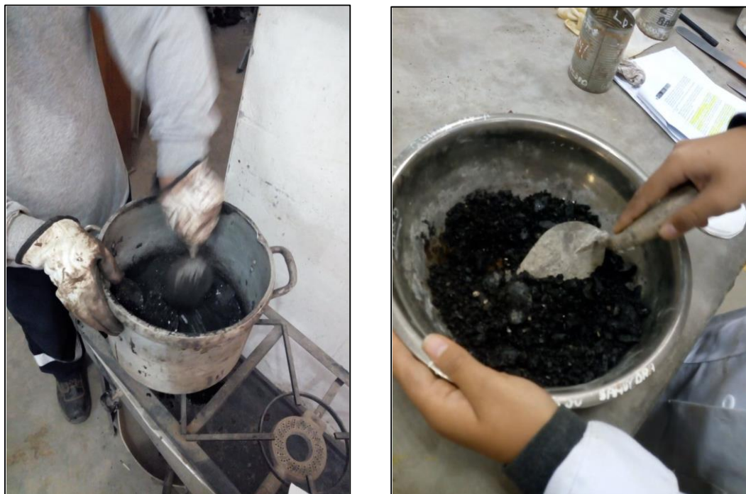
Figura 54: Mezcla de los agregados con el cemento asfáltico
