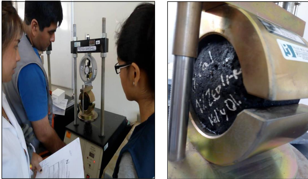
Figura 62: Ensayo de estabilidad y flujo en el Laboratorio de la UPN
