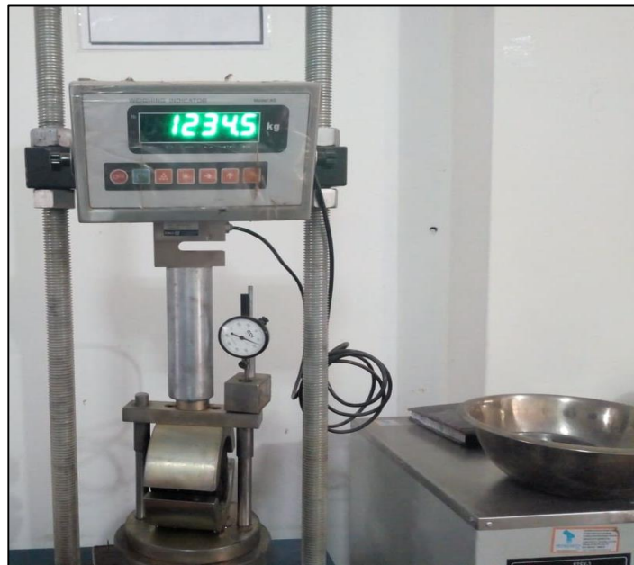
Figura 66: Ensayo de Estabilidad y flujo en la Máquina de Marshall
