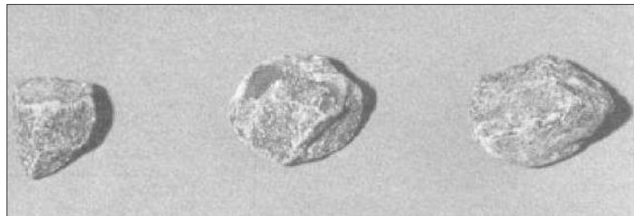
Figura 34: Partículas fracturadas bordes redondeados, superficie rugosa.
