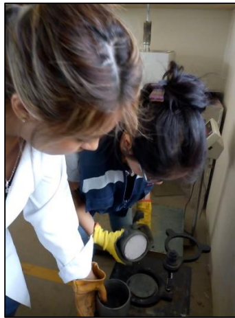
Figura 57: Cambio de base opuesta del molde para la compactación
