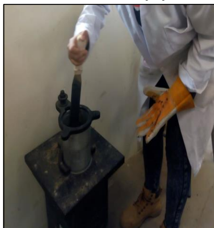
Figura 56: Chuseada con espátula a la mezcla
