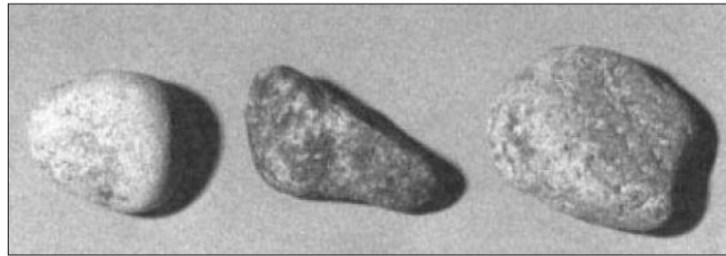
Figura 33: Partículas no fracturadas
