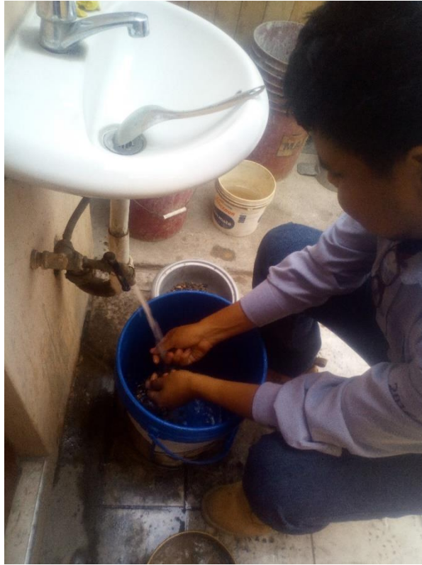
Foto 37 al 40: Pasante la malla #200
