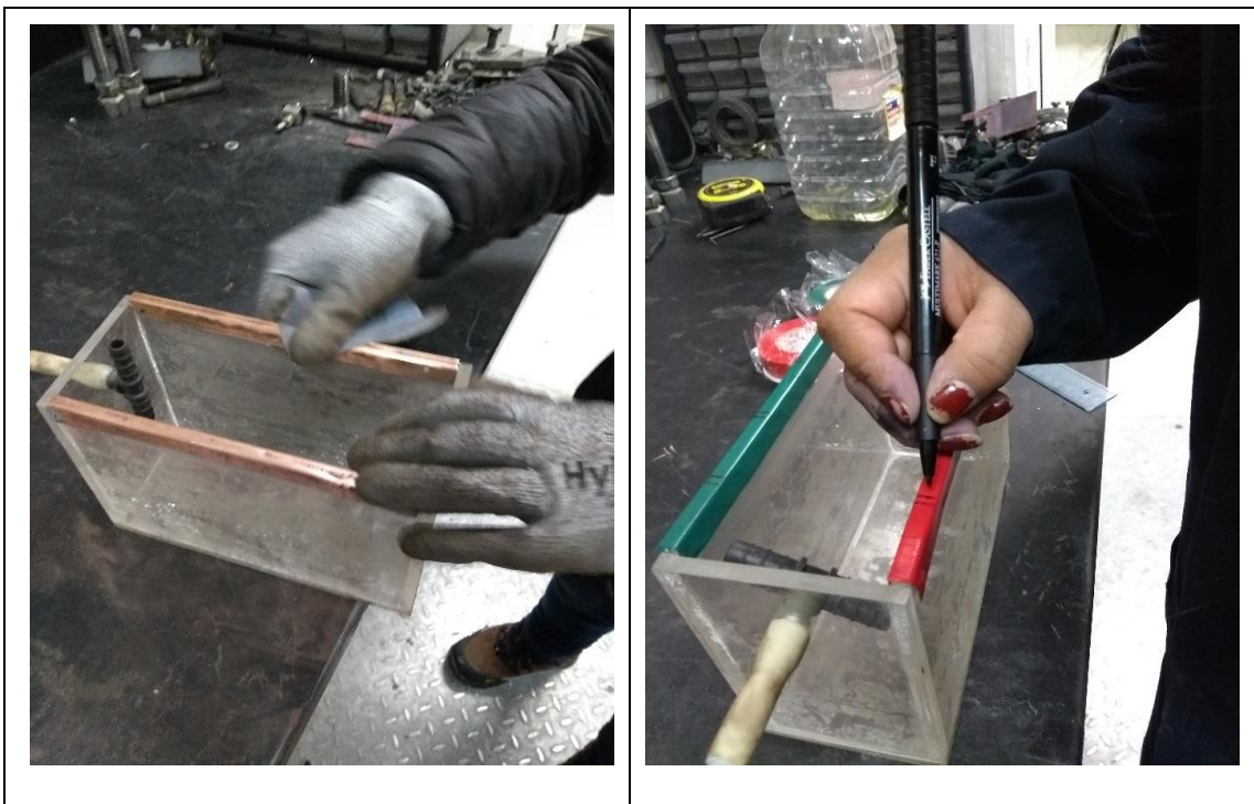
Fotografía 3. Limpieza y marcado de las pestañas de Cobre conductoras de electricidad
