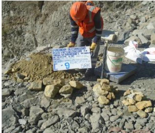
Foto N°18: En la foto izquierda se puede ver el interior de la calicata C-9 (prof. 0.80 m) y en la derecha se observa el material extraído de la misma.
