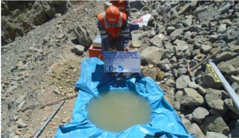
Foto N°05: Calicata y Ensayo de Densidad In Situ por método reemplazo por volumen de agua CD-3(prof. 0.50 m), realizado entre las banquetas 1(1826.99 msnm) y 2 (1852.00 msnm).
