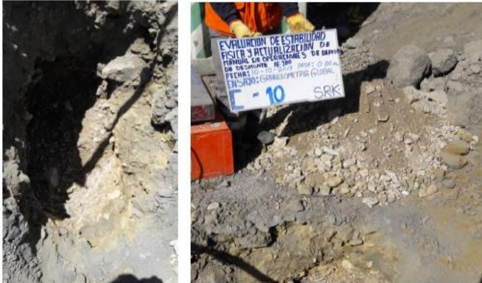
Foto N°20: En la foto izquierda se observa el interior de la calicata C-10 y en la derecha se puede ver el material extraído de la misma.
