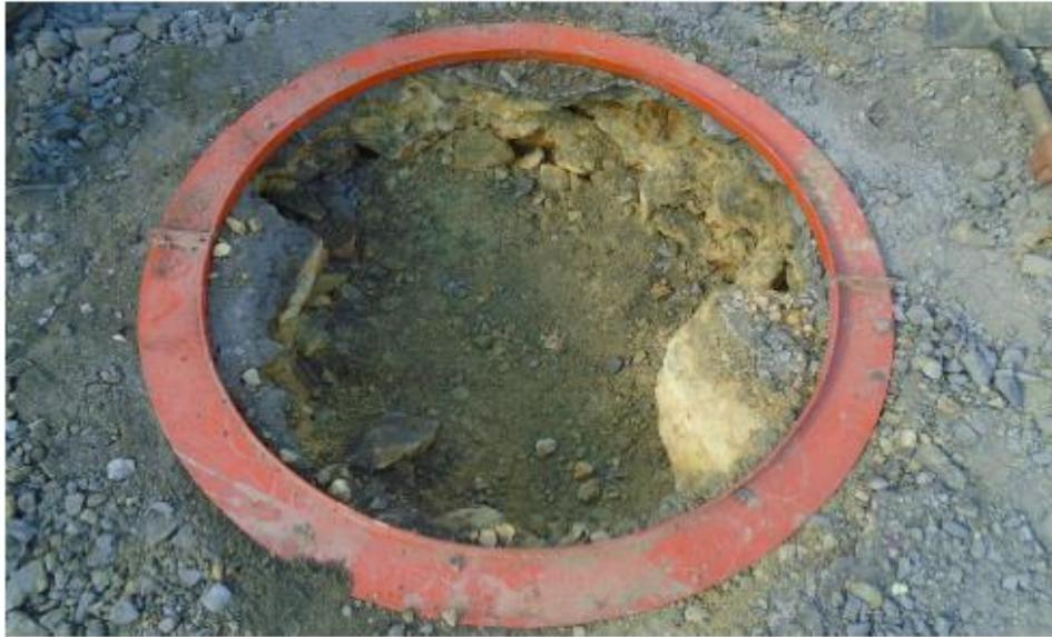
**Foto N°04:** Interior de la calicata CD-2 (prof. 0.50) realizado en la corona del depósito de Desmonte Nro. 100.
