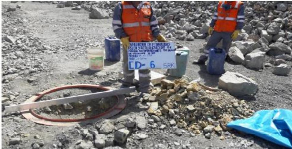
Foto N°12: En la parte izquierda de la foto se observa el interior de la calicata CD-6 y en la parte derecha el material extraído.
