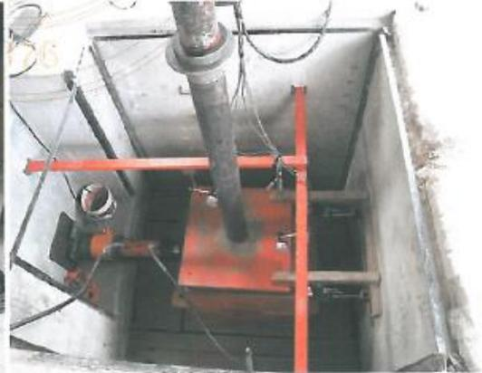
**Foto Nº 4 :** Aplicación del Esfuerzo Normal y Esfuerzo de Corte.
