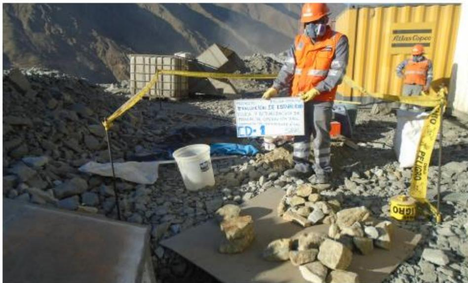
**Foto N°02:** Material obtenido de la calicata CD-1 (prof. 0.50 m), realizado en la corona del depósito de Desmonte Nro. 100.
