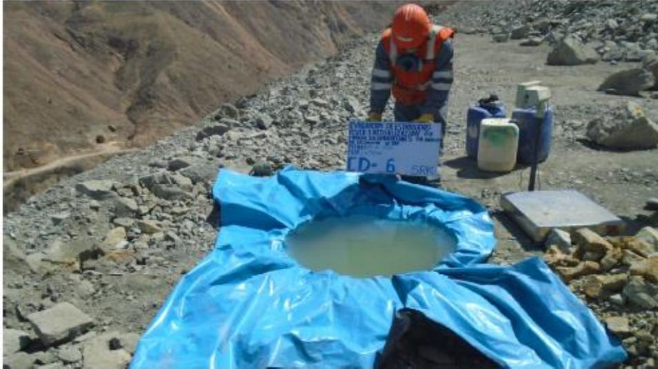
Foto N°11: Calicata y ensayo de densidad in situ por método reemplazo por volumen de agua CD-6 (prof. 0.50 m), realizado en la banqueta 4 (1902.00 msnm).
