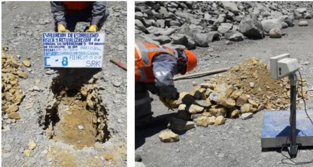
Foto N°16: En la foto izquierda se observa el interior de la calica C-8 y en la derecha se puede ver el material extraído de la misma.
