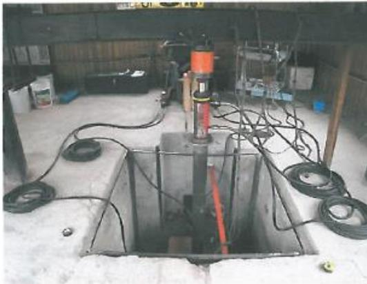
**Foto Nº 3** Se aprecia el marco de carga que sirve para aplicar el esfuerzo vertical y el sistema de adquisición de datos.
