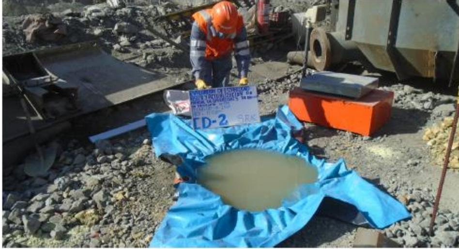
**Foto N°03:** Calicata y Ensayo de Densidad In Situ por método reemplazo por volumen de agua CD-2 (prof. 0.50 m), realizado en la corona del depósito de Desmonte Nro. 100.
