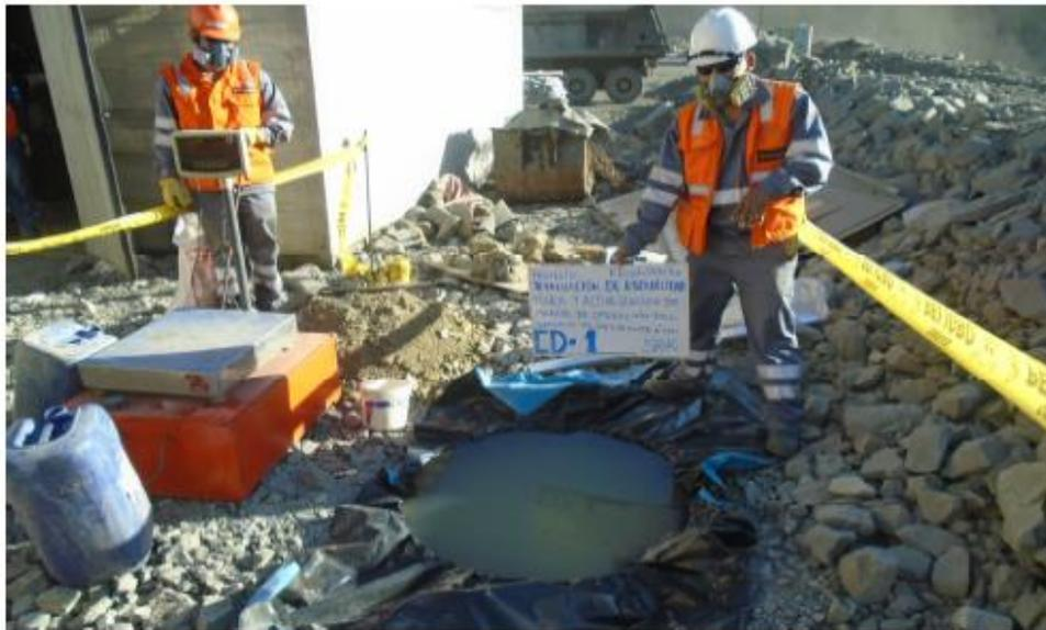
**Foto N°01:** Calicata y Ensayo de Densidad In Situ por método reemplazo por volumen de agua CD-1 (prof. 0.50 m), realizado en la corona del depósito de Desmonte Nro. 100.
