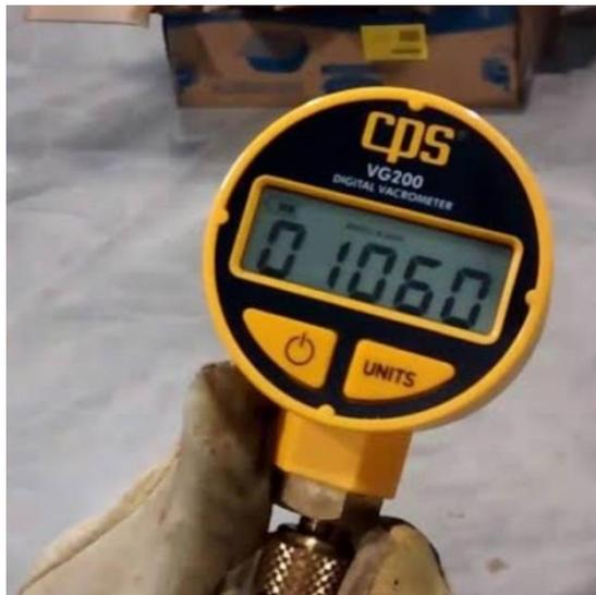
*Figura 0.9* Vacuómetro digital CPS VG200
