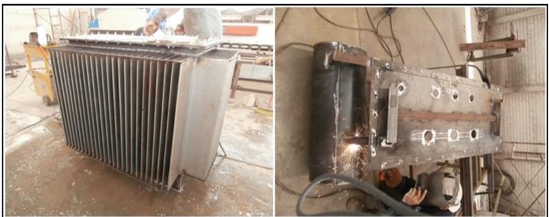
Figura n.º 3.1.1.14 Fabricación de tanque
