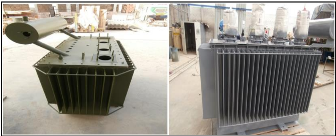
Figura n.º 3.1.1.15 Pintado de tanque
