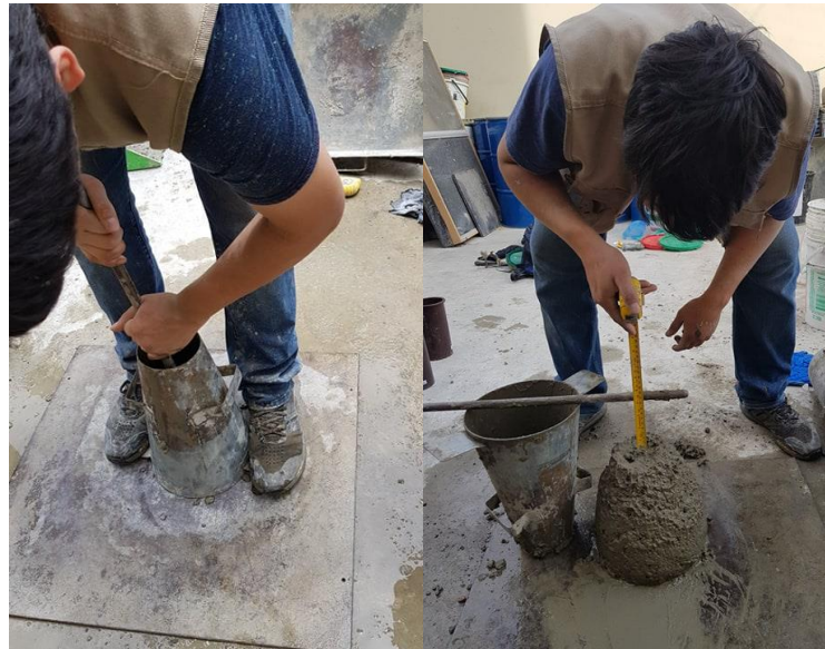
Figura 34: Ensayo de asentamiento.
