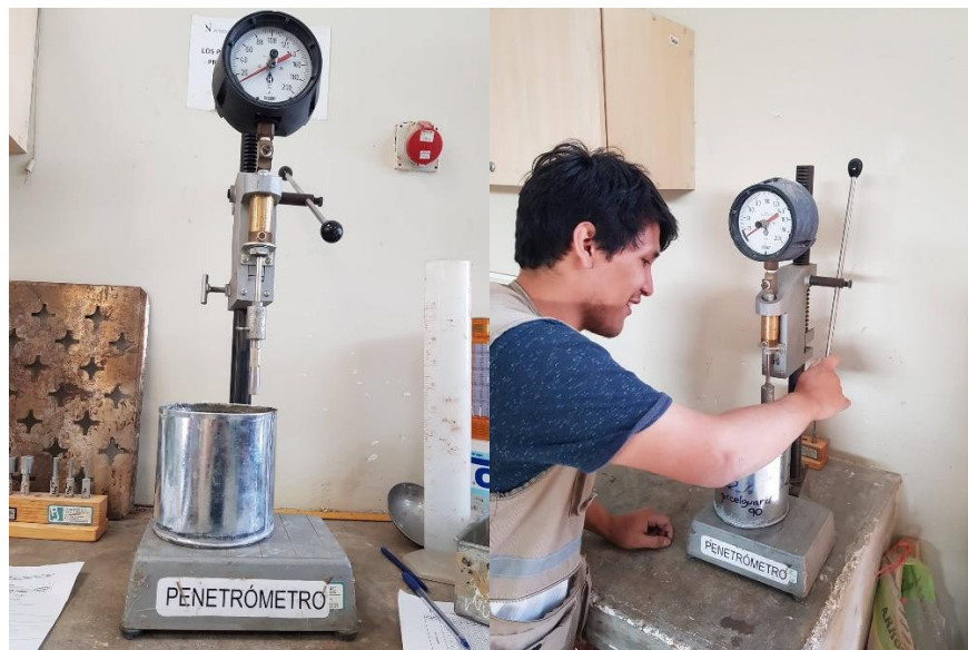
Figura 35: Penetrómetro – Ensayo de Tiempo de fraguado.
