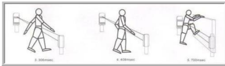
Figura N° 1.6.2.3.1. Detección de intrusión por un sensor (Barrera Fotoeléctrica)
