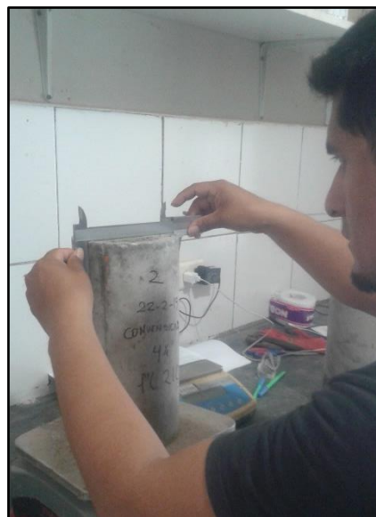
Foto n° 2.5: Medición de dimensiones de probeta
