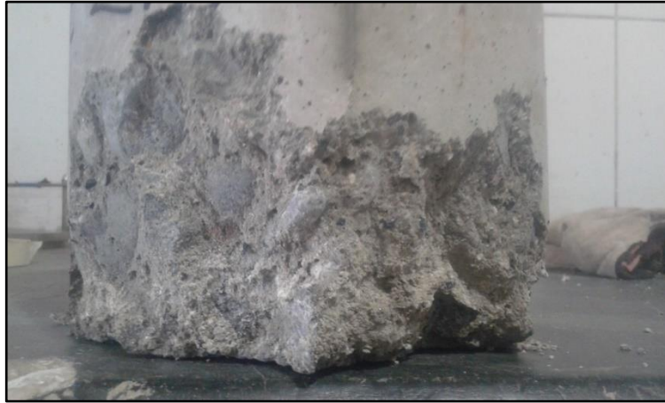
Foto n° 2.8: Imagen de tipo de falla de las probetas de concreto
