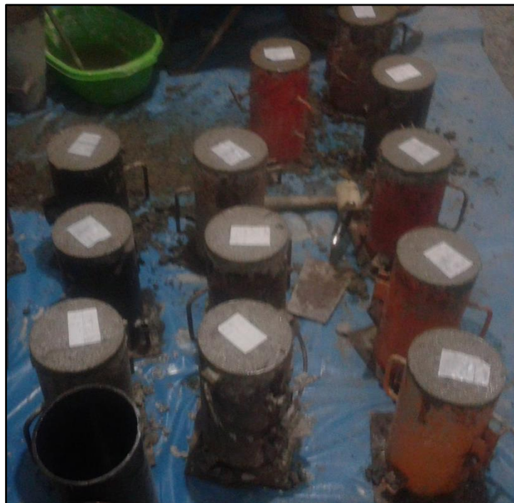
Foto n° 3.1. : Probetas a ensayar de concreto tradicional y concreto con plástico reciclado incluido
