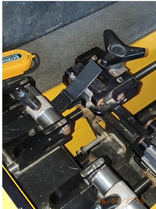
Fotografía 25 Ensayo al desgarro de las probetas
