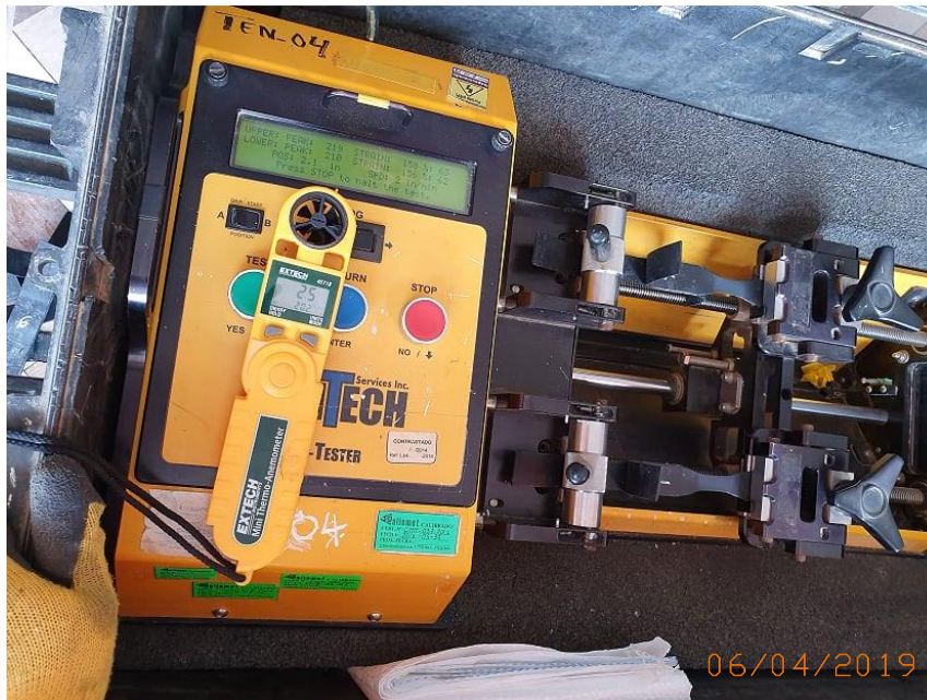
Fotografía 24 Ensayo al corte de las probetas.
