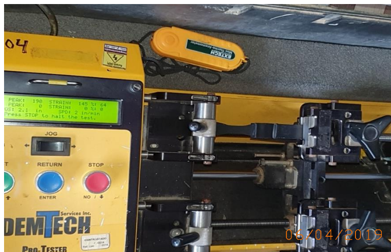
Fotografía 8 Ensayo al corte de las probetas.
