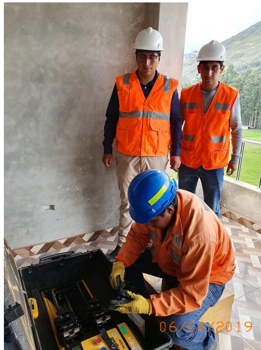
Fotografía 11 Ensayo al corte y desgarro de las probetas.
