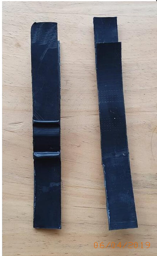
Fotografía 23 Probetas de soldadura por extrusión y fusión
