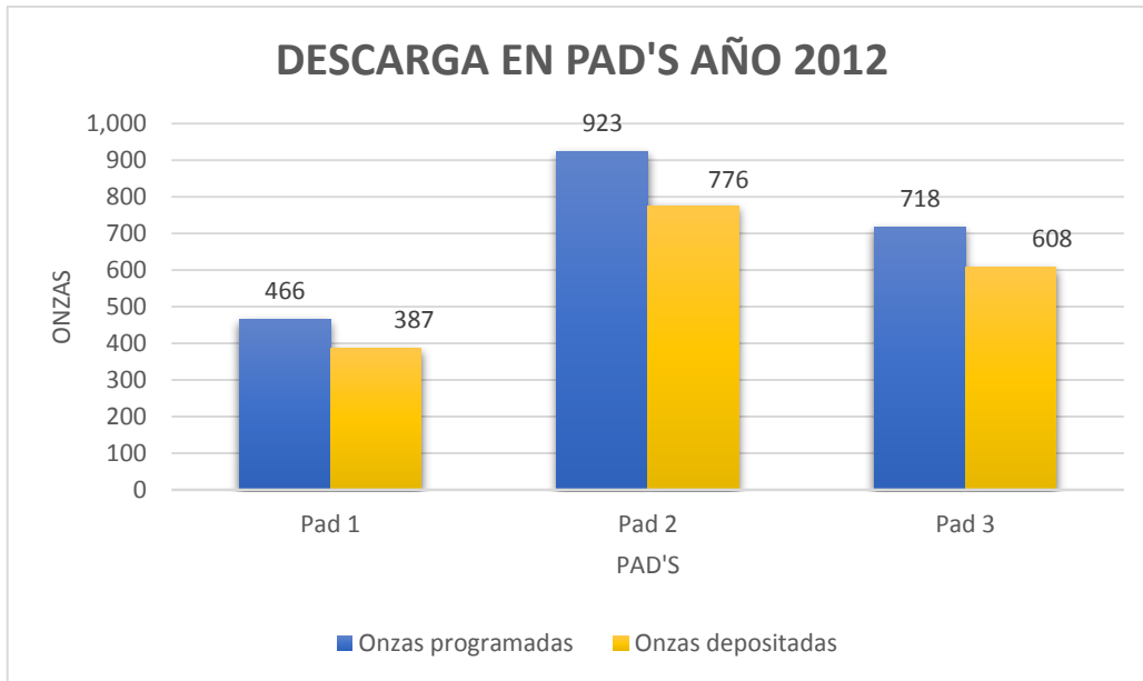
Figura 7. Antes del uso de GPS en dozer, no se depositan 335 onzas teniendo una precisión de aproximada de 88%.
