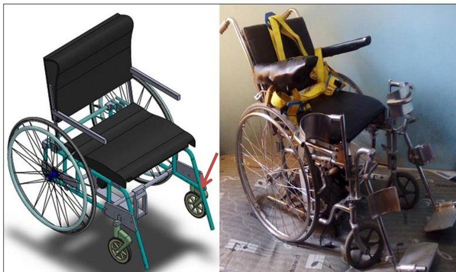
*Figura 17.* Diseño de la silla vs acabado de la silla posición de sentado.
