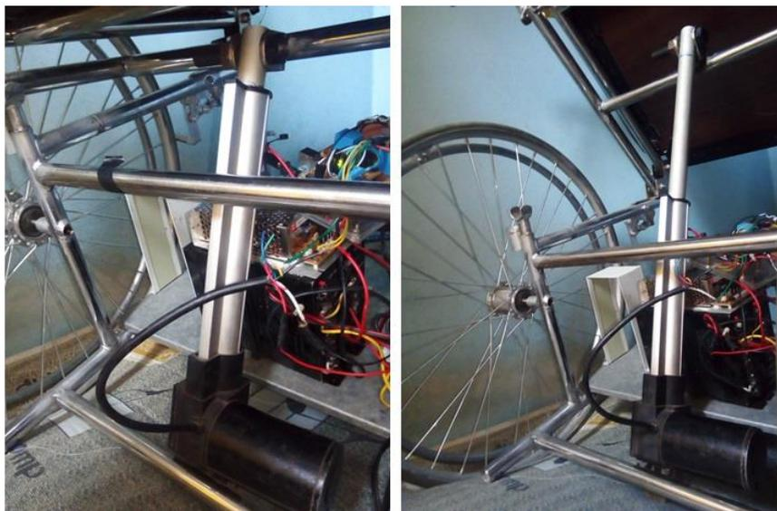
Figura 22. Ubicación del actuador lineal en el prototipo.
