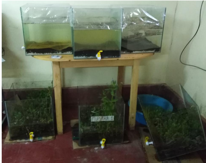
Figura 34. Maqueta combinada de ALD y Humedal.
