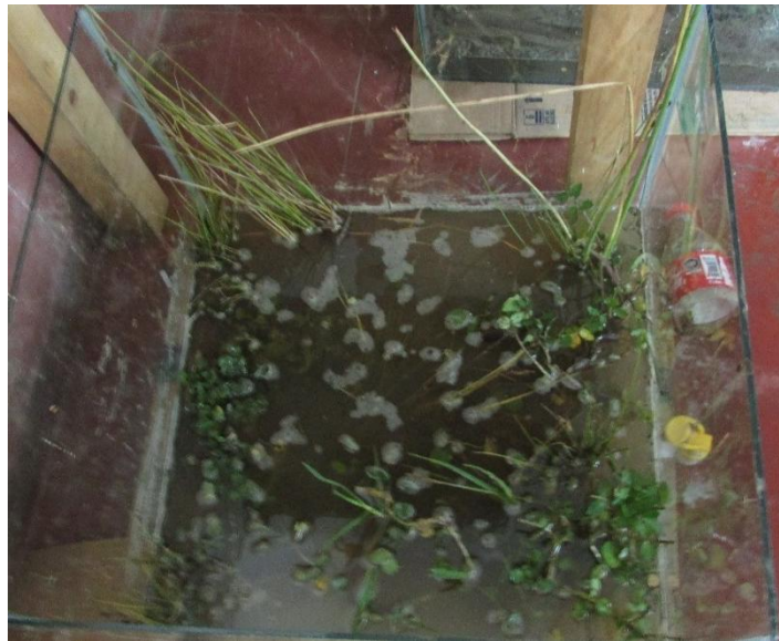
Figura 32. Maqueta de tratamiento humedal.
