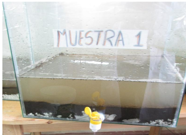
Figura 30. Caliza, Materia Orgánica y Agua Acida dentro del cubo.
