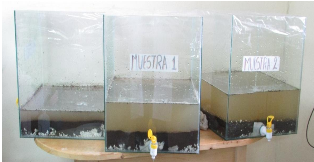
Figura 31. Tapado para condiciones anóxicas.
