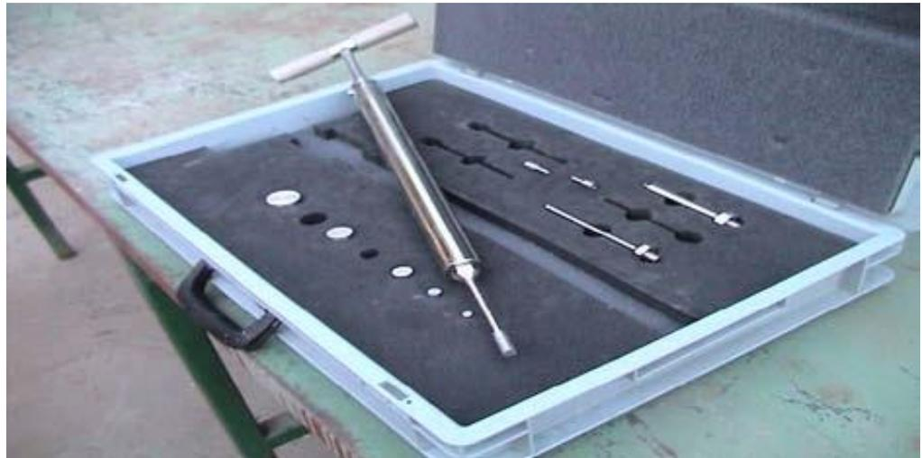
*Figura 13.* Penetrómetro.
