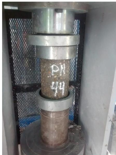
*Figura 21.* Máquina de compresión
