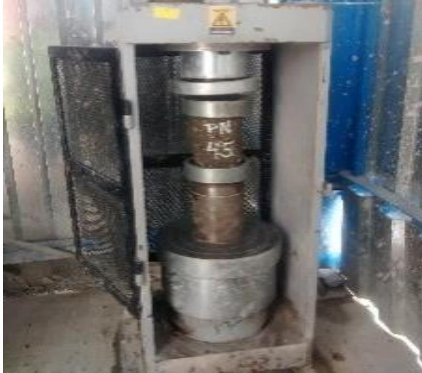
*Figura 27.* Ensayo de compresión.
