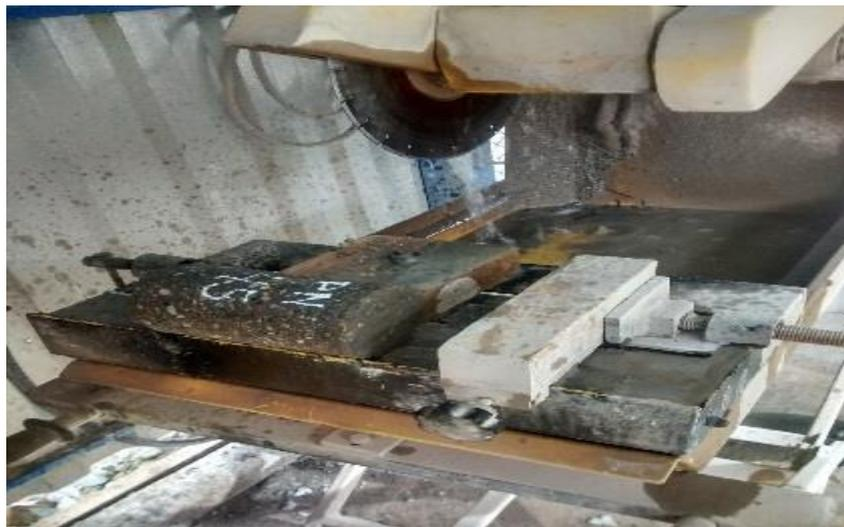
*Figura 26.* Corte de bases de testigo.
