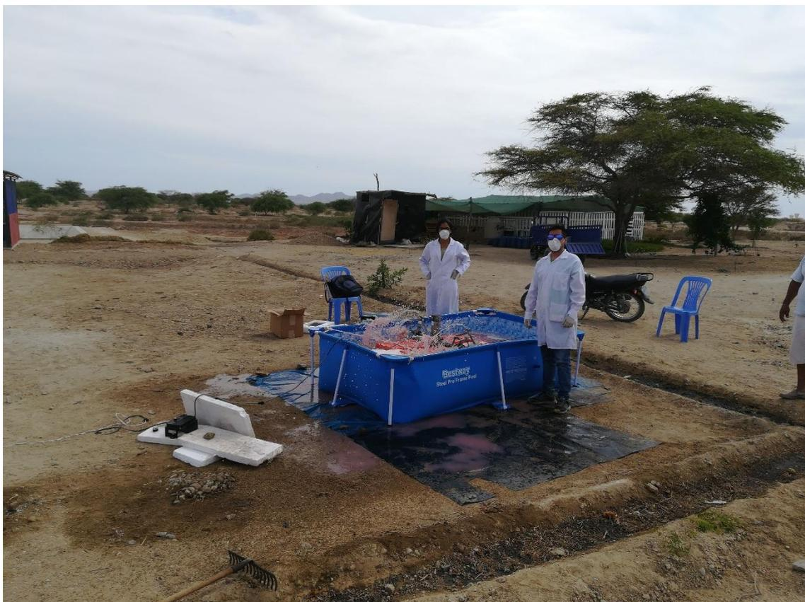
Reporte fotográfico 10- Desoxigenación del agua potable. Método de Sulfito
