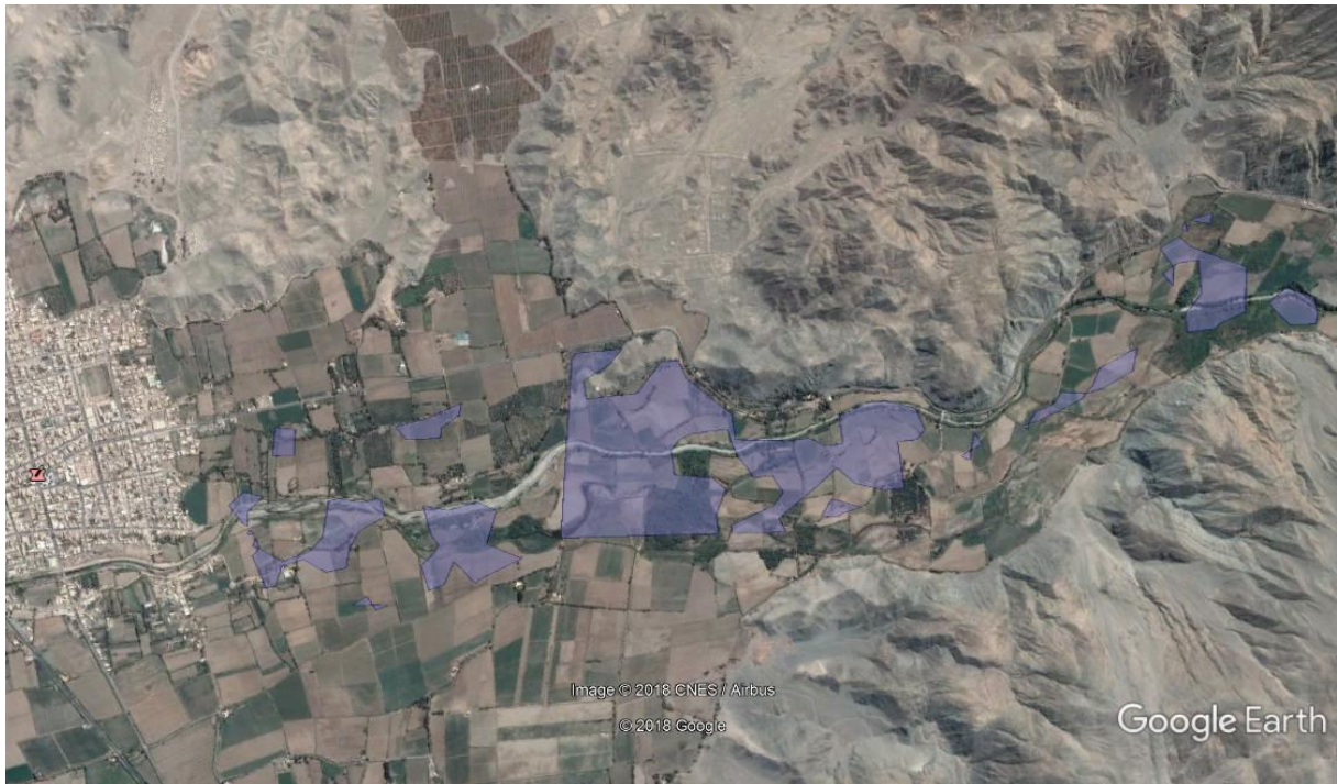
Figura 35: Resultado gráfico de las zonas inundables en la cuenca baja del Río Huarmey para un periodo de retorno de 25 años (Google Earth)
