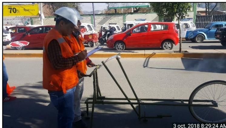
*FOTOGRAFÍA N° 18:* Lecturas de irregularidades del pavimento para el carril W(Oeste)- E(este) Externo.
