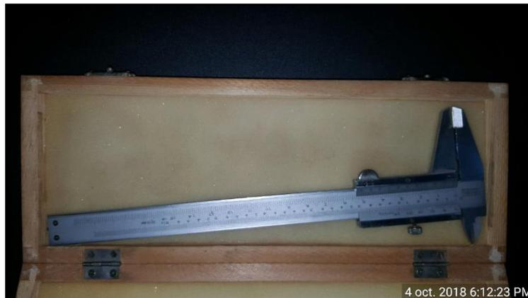
FOTOGRAFÍA N° 50: Vernier o pie de rey que sirve para medir el espesor de la pastilla o disco de bronce.
