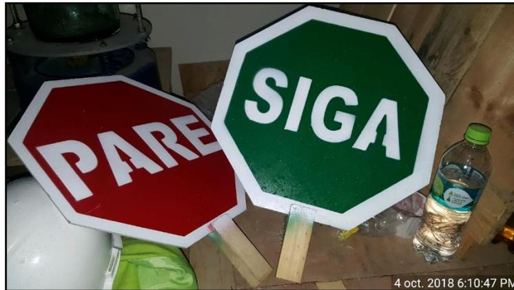
FOTOGRAFÍA N° 49: Paletas de seguridad para desviar el tráfico del lugar del ensayo.
