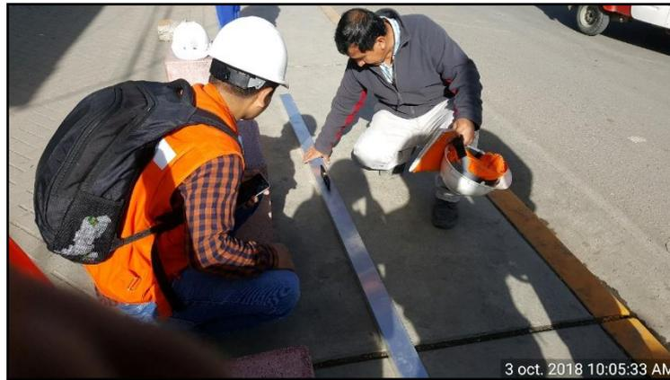
*FOTOGRAFÍA N° 10:* Se comenzó con el ensayo mediante el rugosímetro de Merlin para obtener la rugosidad. Para ello se nivela la regla metálica sobre la cual se colocó el equipo.
