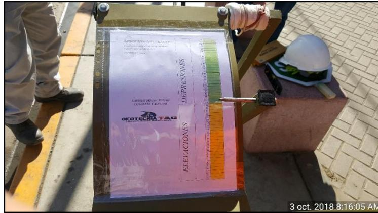
*FOTOGRAFÍA N° 13:* Tablero del rugosímetro de Merlin indicando la hoja dividida en elevaciones y depresiones.
