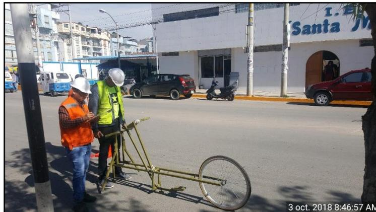
*FOTOGRAFÍA N° 23:* Lectura de la irregularidad del pavimento para el kilómetro km 00+140m.
