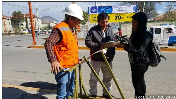
*FOTOGRAFÍA N° 15:* Calculo del factor de corrección = 0.9 con el espesor de la pastilla.
