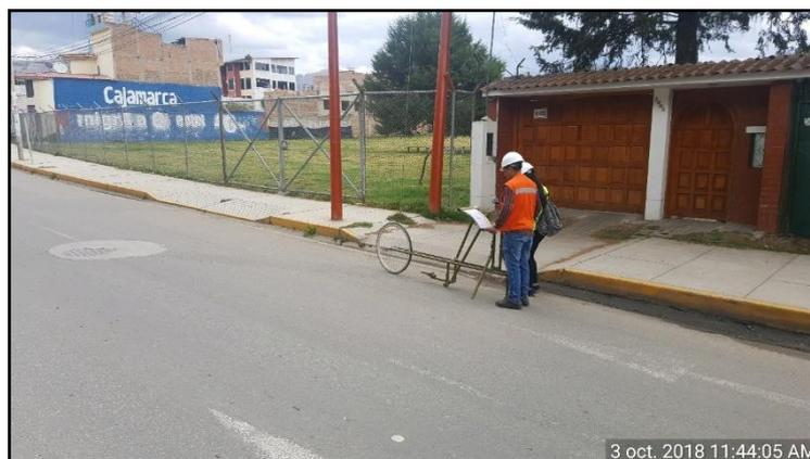
*FOTOGRAFÍA N° 34:* Irregularidades del pavimento km 00+150m del carril E(este)-W(oeste) externo.
