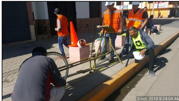
*FOTOGRAFÍA N° 14:* Verificando la distancia del rugosímetro de Merlin.
