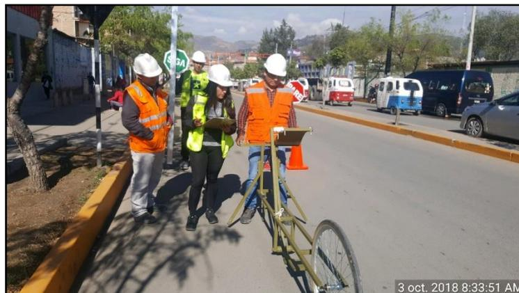
*FOTOGRAFÍA N° 21:* Lectura de la irregularidad del pavimento para el kilómetro km 00+080m
