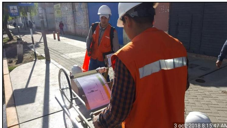
*FOTOGRAFÍA N° 12:* El rugosímetro Merlin sobre la regla metálica nivelada para calcular el factor de corrección y lectura inicial.
