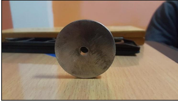
*FOTOGRAFÍA N° 52:* Pastilla o disco circular de bronce. Se colocará debajo del apoyo móvil del rugosímetro de Merlin para su nivelación.
