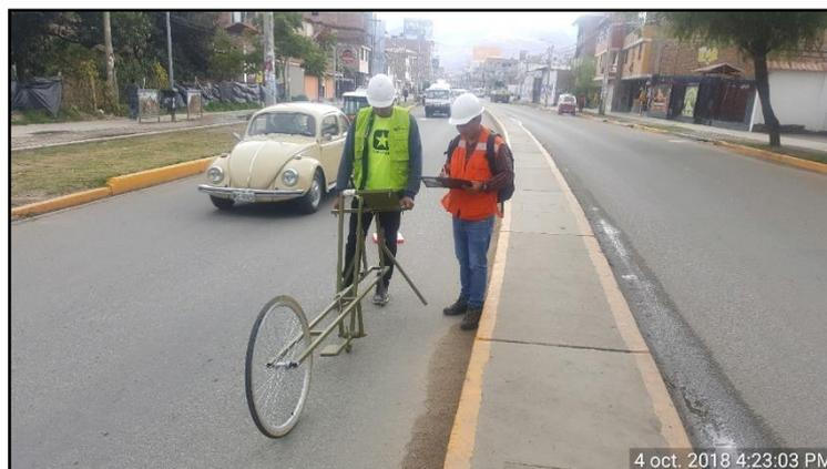
*FOTOGRAFÍA N° 42:* Irregularidades del pavimento carril W(oeste) - E(este) interno km 00+870 m.
