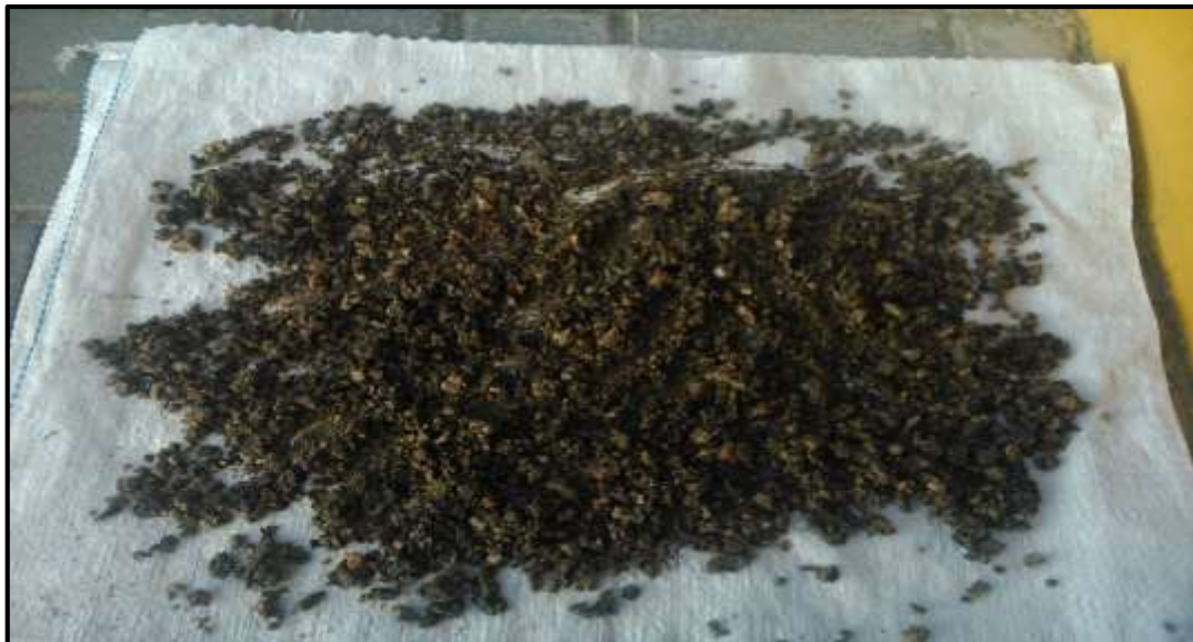
Fotografía N° 16: Ensayo del material para encontrar el peso específico del agregado fino
