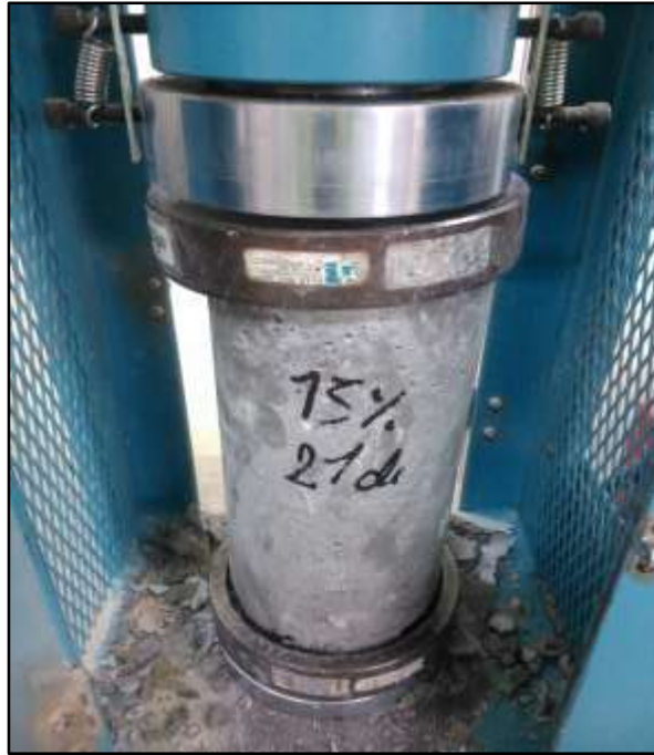
Fotografía N° 53: Fractura presentada en la probeta M4 del diseño con 15% de plástico a los 21 días (la falla es interna)
