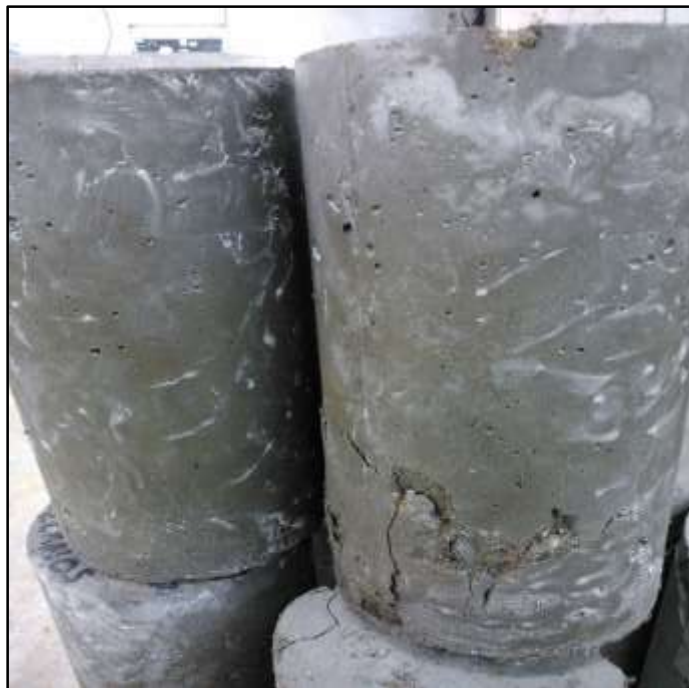
Fotografía N° 38: Fractura presentada en la probeta M14 del diseño patrón a los 21 días (fractura tipo V)
