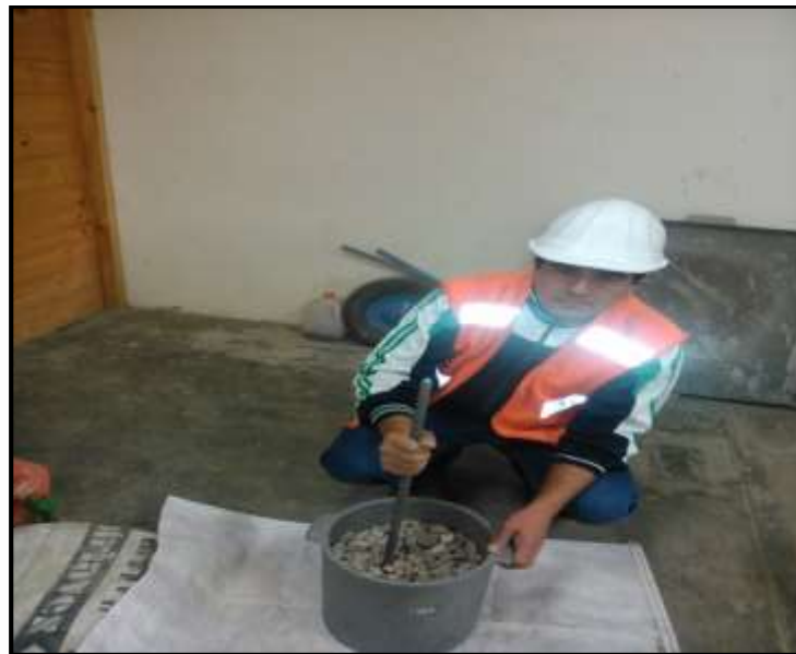
Fotografía N° 20: Densidad Aparente y contenido de vacíos del agregado grueso
