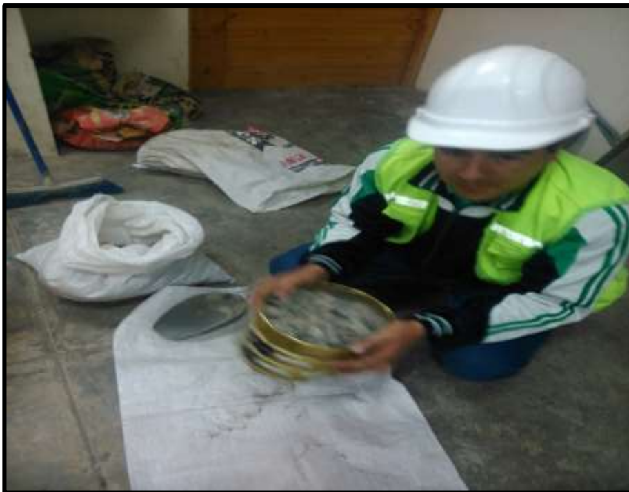
Fotografía N° 14: Realizando el análisis granulométrico del agregado grueso
