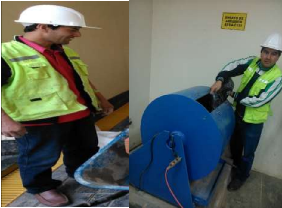
Fotografía N° 23: Ensayo de abrasión del agregado grueso
