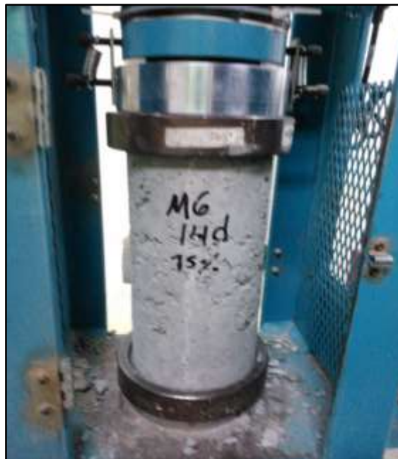
Fotografía N° 52: Fractura presentada en la probeta M6 del diseño con 15% de plástico a los 14 días (la falla es interna)
