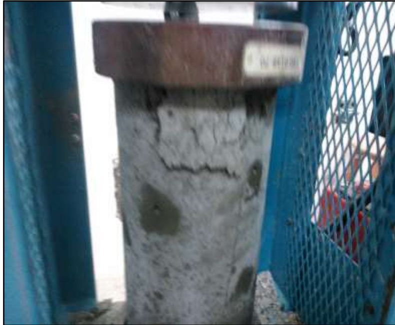
Fotografía N° 37: Fractura presentada en la probeta M9 del diseño patrón a los 14 días (fractura tipo II)
