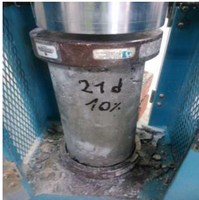
Fotografía N° 46: Fractura presentada en la probeta M4 del diseño con 10% de plástico a los 21 días (falla interna)
