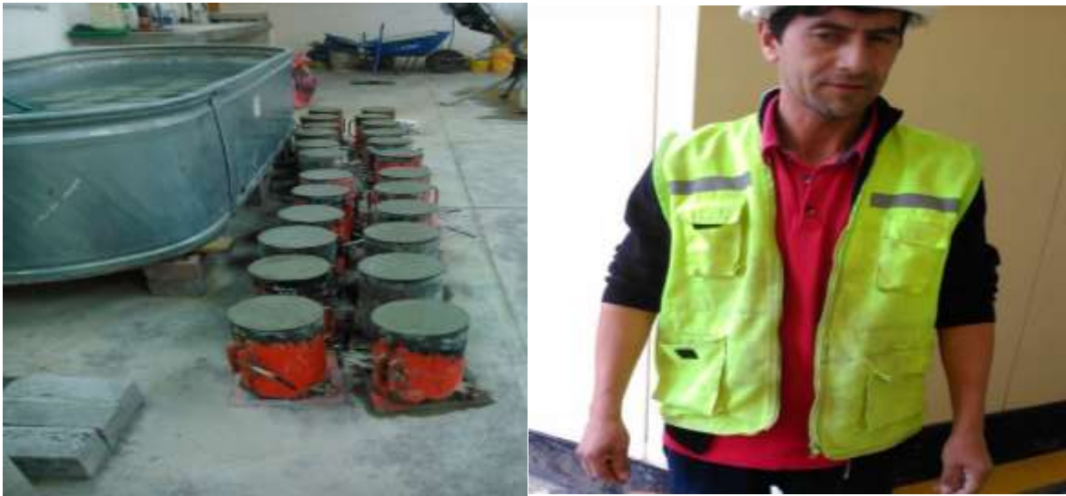
Fotografía N° 10: Desencofrado y curado de probetas de concreto
