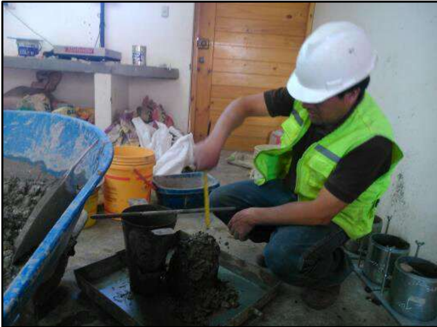
Fotografía N° 29: Midiendo el asentamiento o Slump
