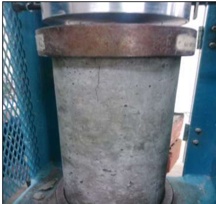
Fotografía N° 48: Fractura presentada en la probeta M2 del diseño con 15% de plástico a los 7 días (falla tipo II)
