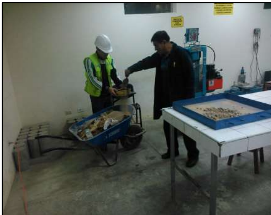
Fotografía N° 24: Ensayo de abrasión del agregado grueso.
