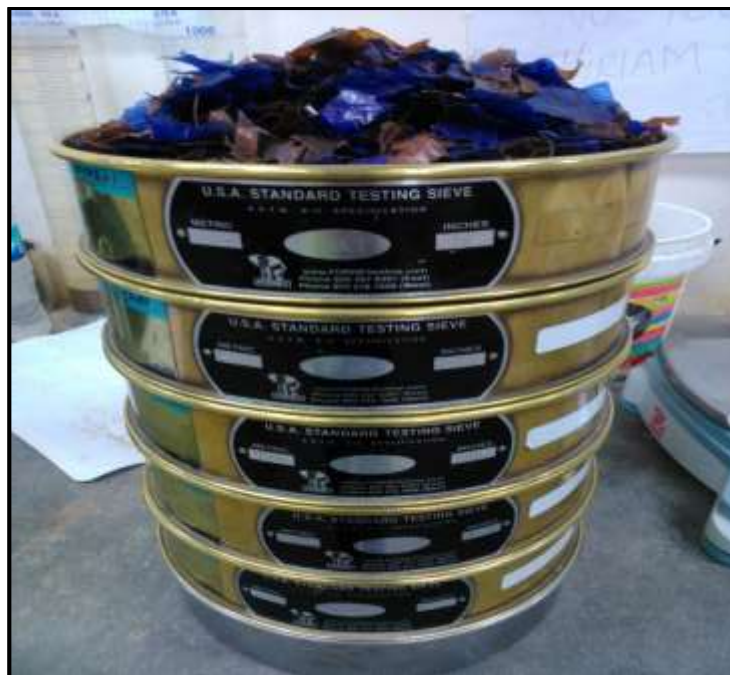
Fotografía N° 26: Realizando el análisis granulométrico del plástico
