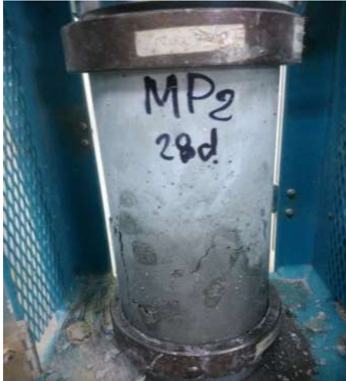
Fotografía N° 39: Fractura presentada en la probeta MP2 del diseño patrón a los 28 días (fractura tipo V)
