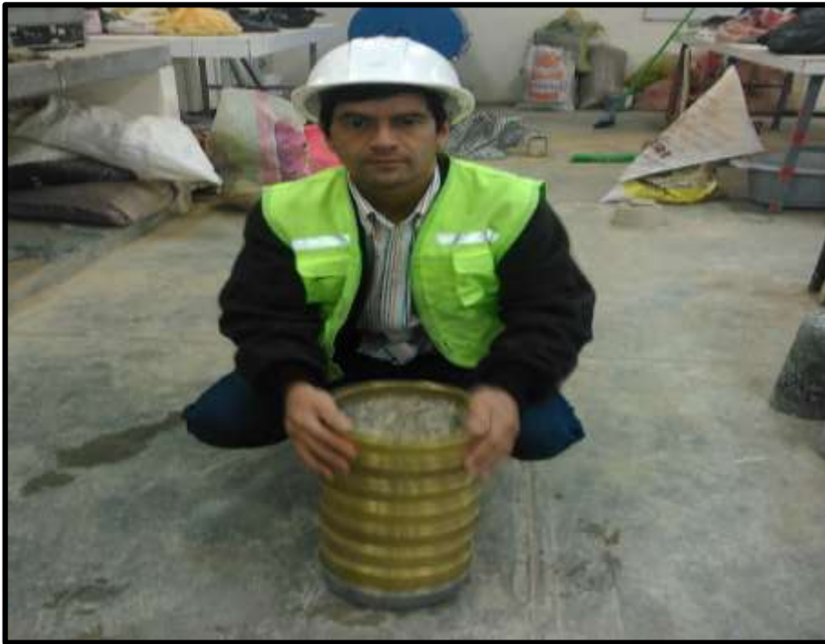
Fotografía N° 13: Realizando el análisis granulométrico del agregado fino
