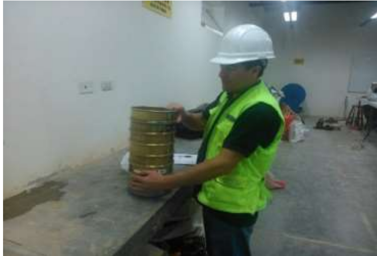
Fotografía N° 1: Granulometría del agregado fino
