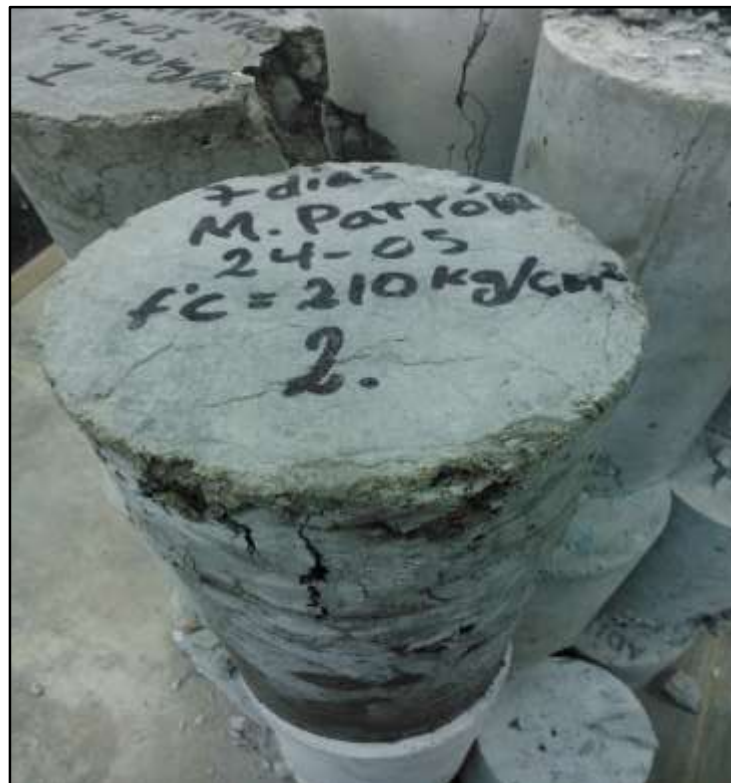
Fotografía N° 34: Fractura presentada en la probeta M2 del diseño patrón a los 7 días (fractura tipo I)
