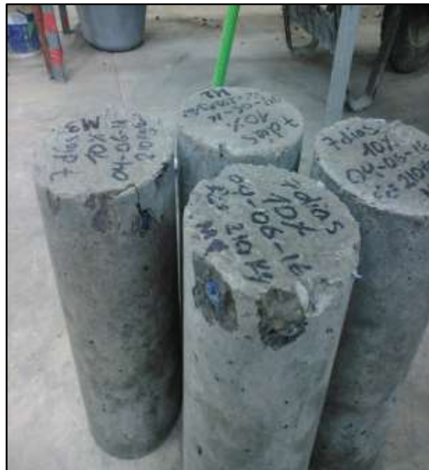
Fotografía N° 50: Fractura presentada en la probeta del diseño con 15% de plástico a los 7 días (falla tipo II)
