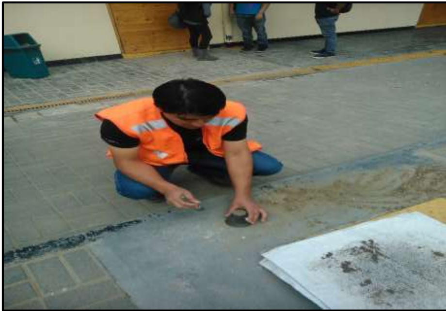
Fotografía N° 17: Ensayo del material para encontrar el peso específico del agregado fino
