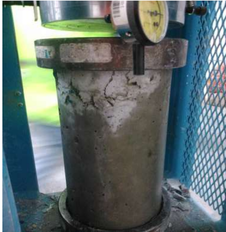
Fotografía N° 43: Fractura presentada en la probeta M5 del diseño con 10% de plástico a los 7 días (fractura tipo II)
