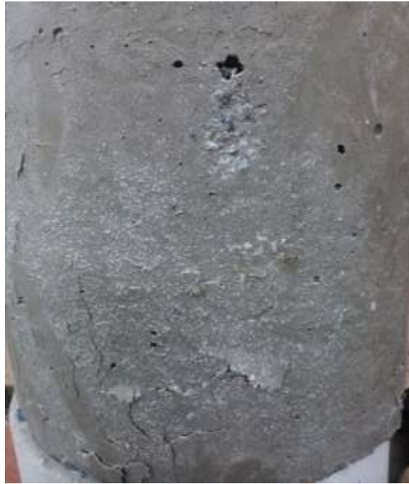
Fotografía N° 47: Fractura presentada en la probeta M3 del diseño con 10% de plástico a los 28 días (falla interna)
