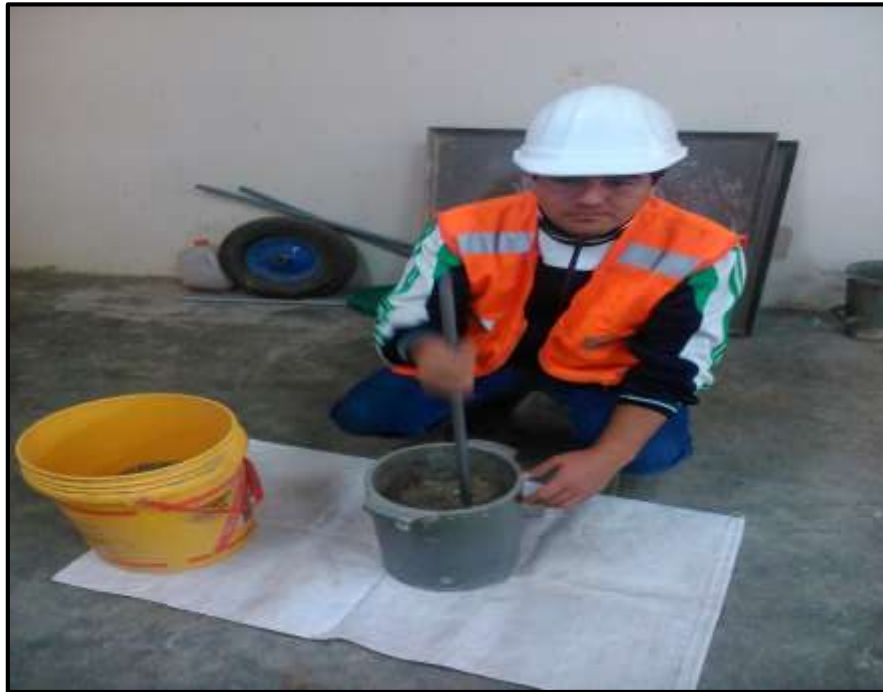
Fotografía N° 19: Densidad Aparente y contenido de vacíos del agregado fino
