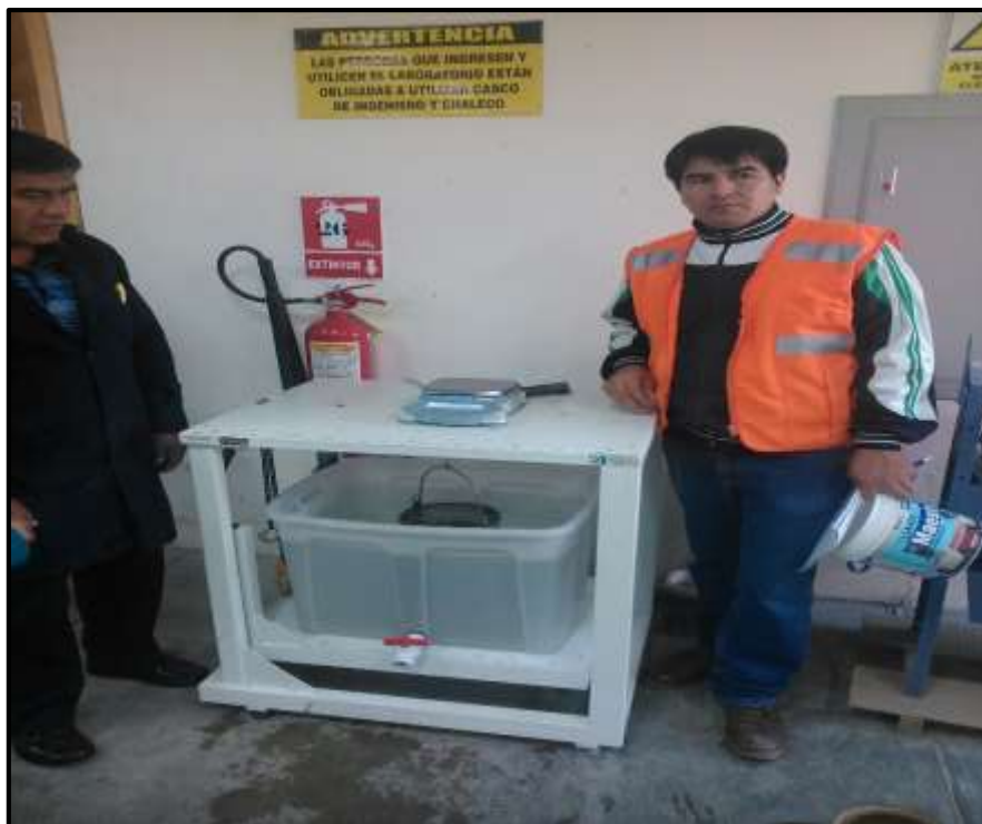
Fotografía N° 22: Ensayo peso específico del agregado grueso
