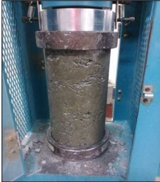
Fotografía N° 55: Fractura presentada en la probeta M2 del diseño con 15% de plástico a los 28 días (la falla es interna)
