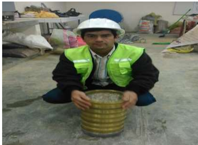
Fotografía N° 2: Granulometría del agregado grueso
