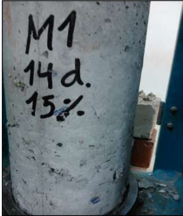
Fotografía N° 51: Fractura presentada en la probeta M1 del diseño con 15% de plástico a los 14 días (presenta fisuras muy pequeñas)
