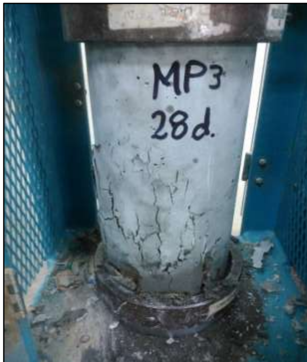
Fotografía N° 40: Fractura presentada en la probeta MP3 del diseño patrón a los 28 días (fractura tipo II)
