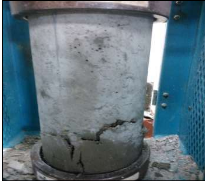
Fotografía N° 35: Fractura presentada en la probeta M4 del diseño patrón a los 7 días (fractura tipo IV)
