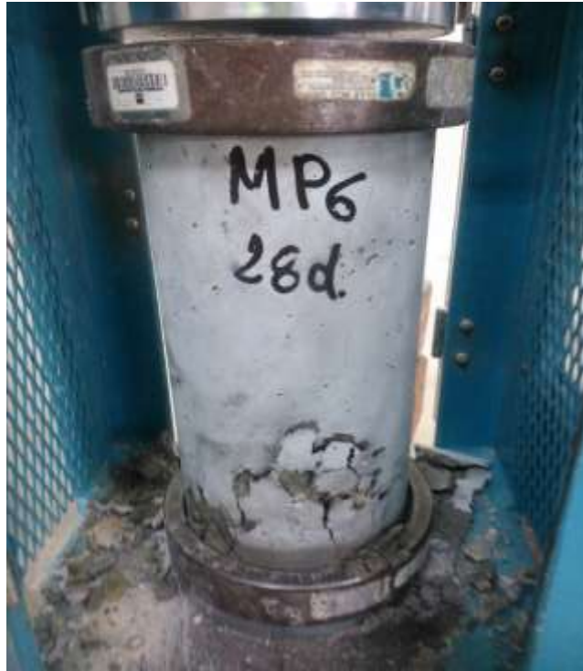
Fotografía N° 41: Fractura presentada en la probeta MP6 del diseño patrón a los 28 días (fractura tipo II)
