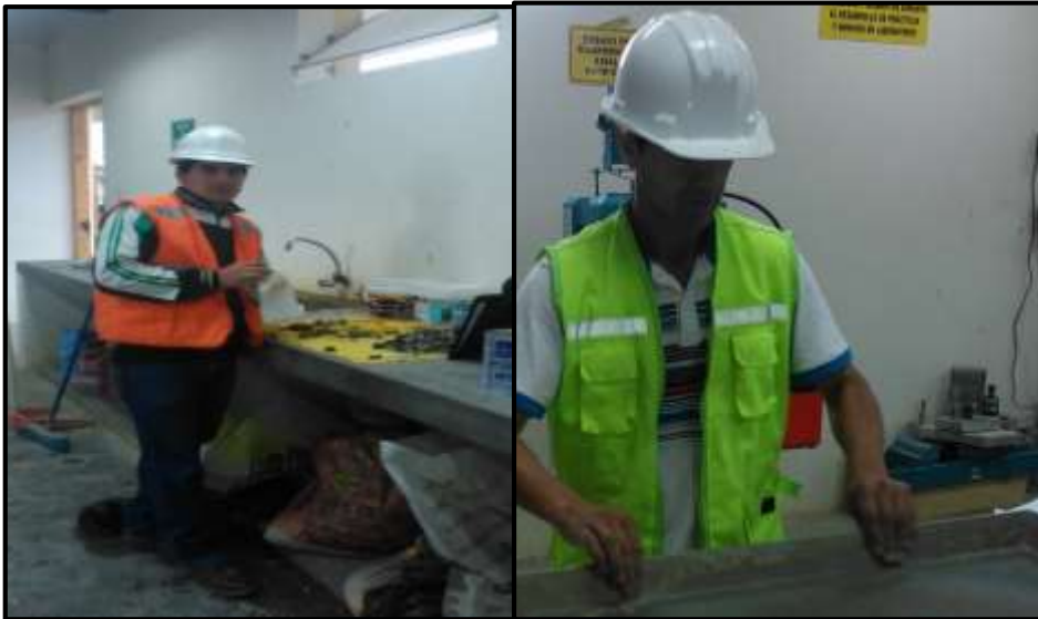
Fotografía N° 21: Ensayo peso específico del agregado grueso
