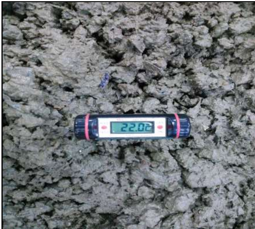
Fotografía N° 30: Ensayo para medir la temperatura del concreto fresco
