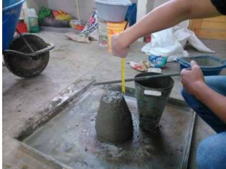
Fotografía N° 8: Midiendo el slump de la mezcla
