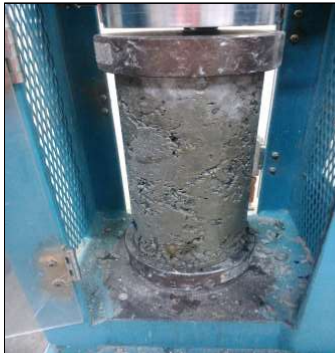
Fotografía N° 56: Fractura presentada en la probeta M2 del diseño con 15% de plástico a los 28 días (la falla es interna)
