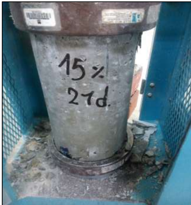
Fotografía N° 54: Fractura presentada en la probeta M2 del diseño con 15% de plástico a los 21 días (la falla es interna)
