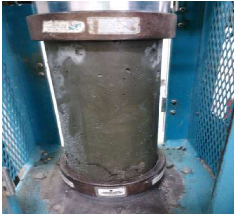
Fotografía N° 36: Fractura presentada en la probeta M7 del diseño patrón a los 14 días (fractura tipo I)
