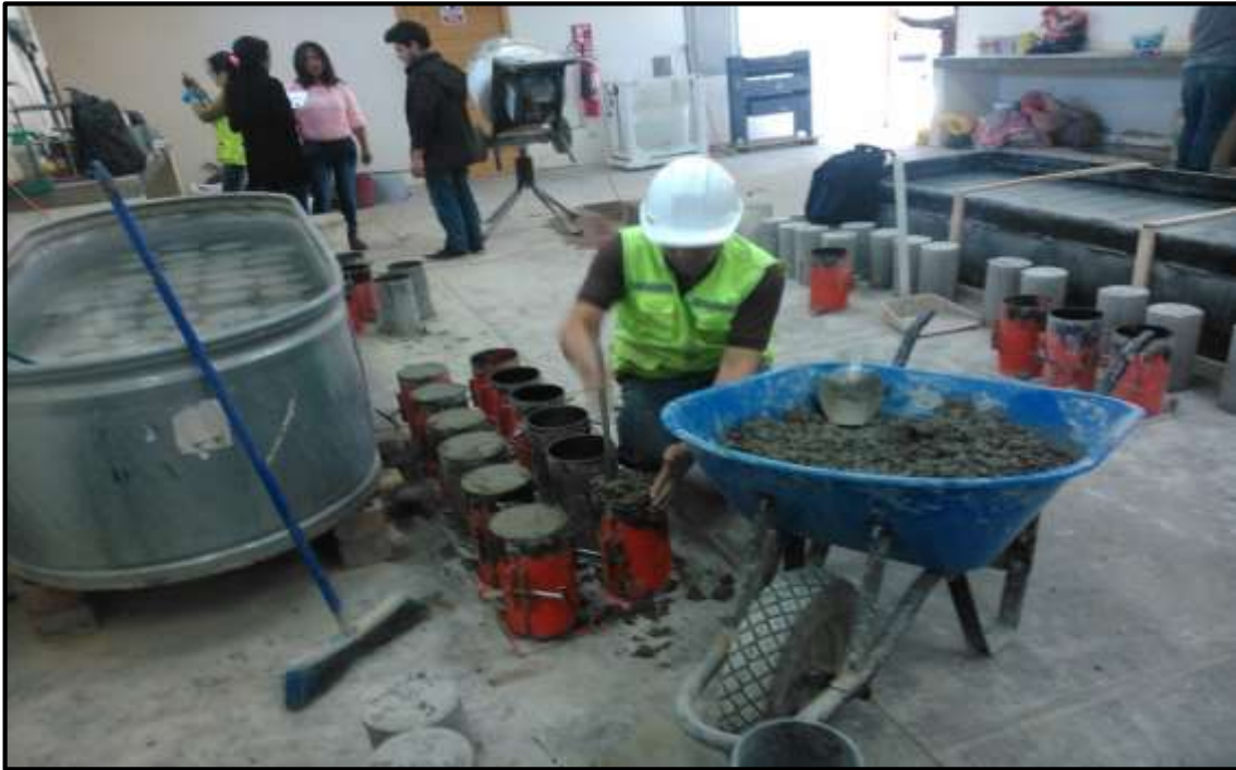
Fotografía N° 31: Realizando el llenado de las probetas
