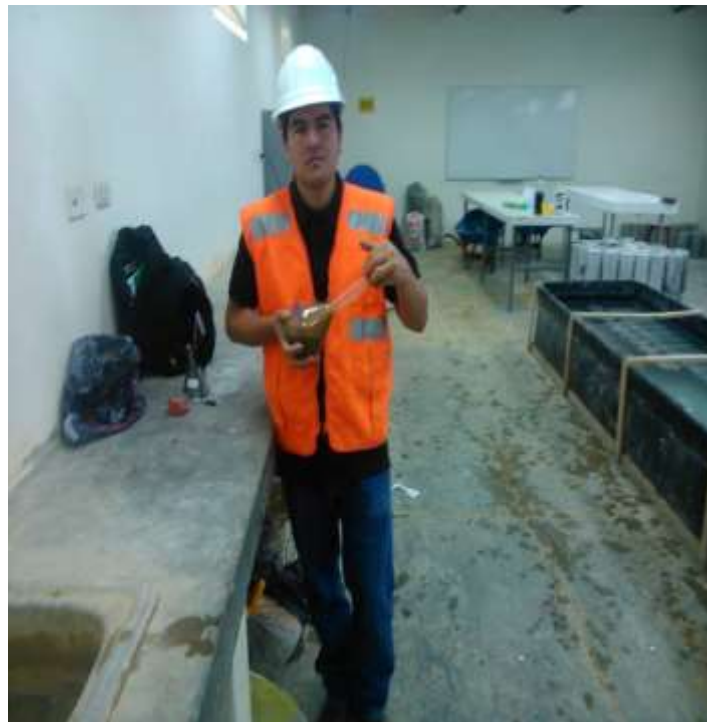
Fotografía N° 18: Ensayo del material para encontrar el peso específico del agregado fino
