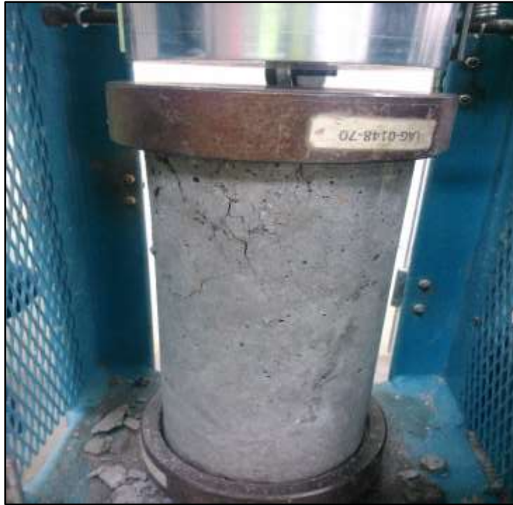
Fotografía N° 49: Fractura presentada en la probeta M4 del diseño con 15% de plástico a los 7 días (falla tipo II)
