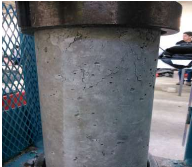
Fotografía N° 42: Fractura presentada en la probeta M3 del diseño con 10% de plástico a los 7 días (fractura tipo II)
