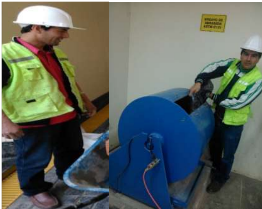
Fotografía N° 6: Colocando el agregado en la máquina de los ángeles
