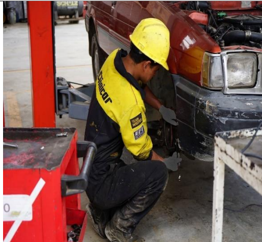
Desmontaje de discos de freno.
