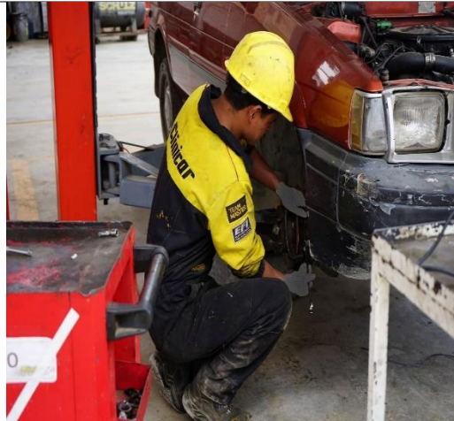
Desmontaje de discos de freno.
