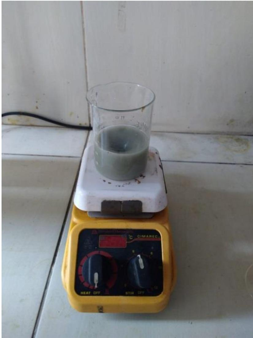
*Figura 12.* Agitación magnética de las muestras de efluente minero artificial con Dolomita
