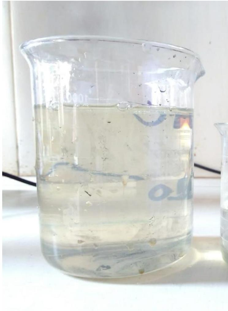
*Figura 11.* Muestras de efluente minero artificial listas para agregarles la Dolomita
