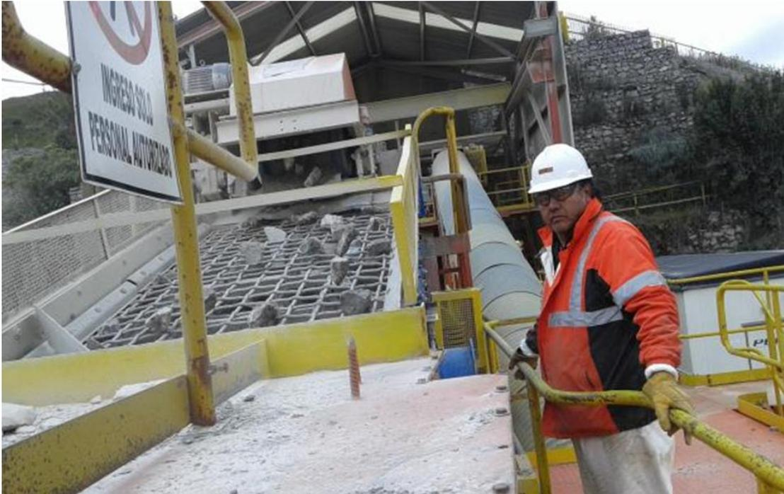
Foto 4: Zaranda 5' x 10' con mallas de 3 pisos para clasificar caliza
