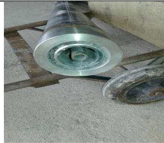
Partes del quemador refractario, tubo para aire de enfriamiento y tubing para combustión.
