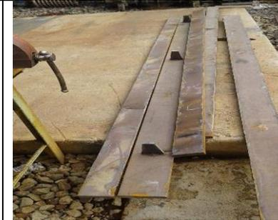
Fabricación de vigas trapecoidales para tolva de gruesos, planchas de acero de 1”.
