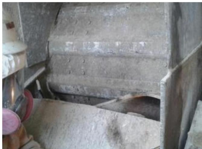
Figura 5: Plancha destrozada por polea motriz.
