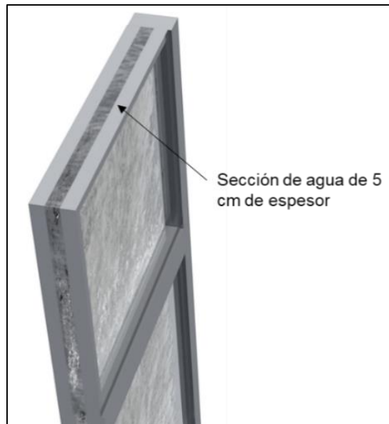
Figura 71. Sección de cámara de agua
