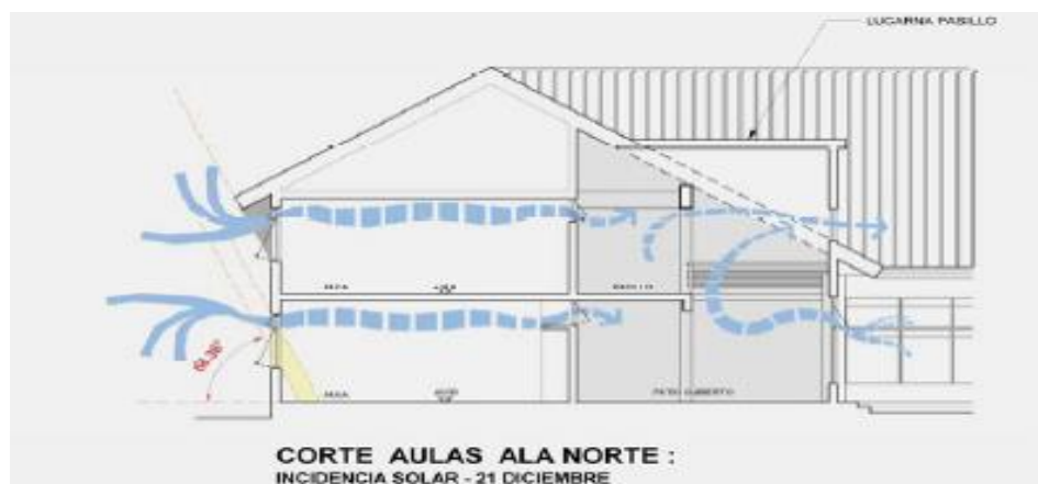
Figura n°8: Estrategia de ventilación cruzada empleada en una escuela.
