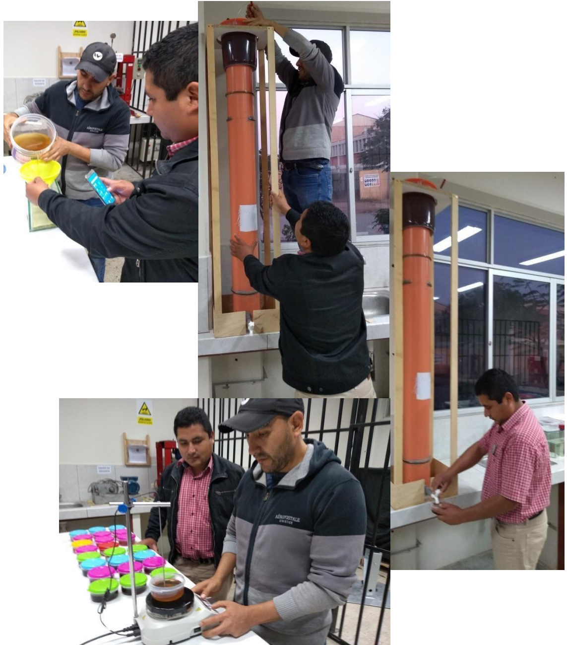
Figura A.5. Puesta a punto sistema de alcalinización en columna desarrollado
