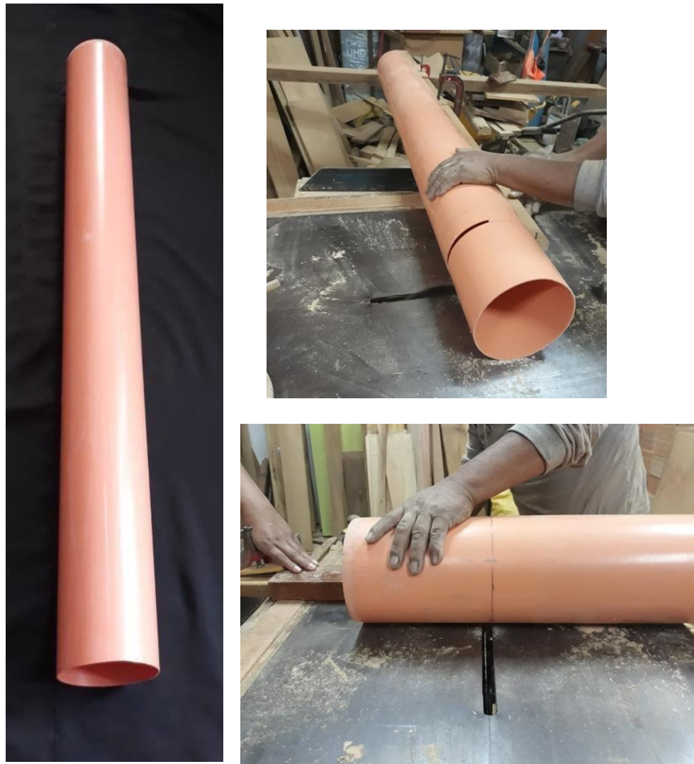
Figura A.1 Compra y acondicionamiento de tubo PVC de 6 pulgadas de diámetro.
