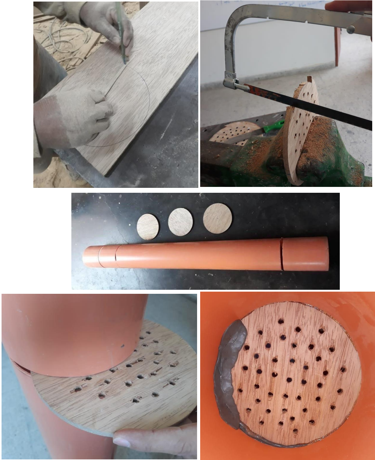
Figura A.3 Acondicionamiento de las secciones del reactor de alcalinización.
