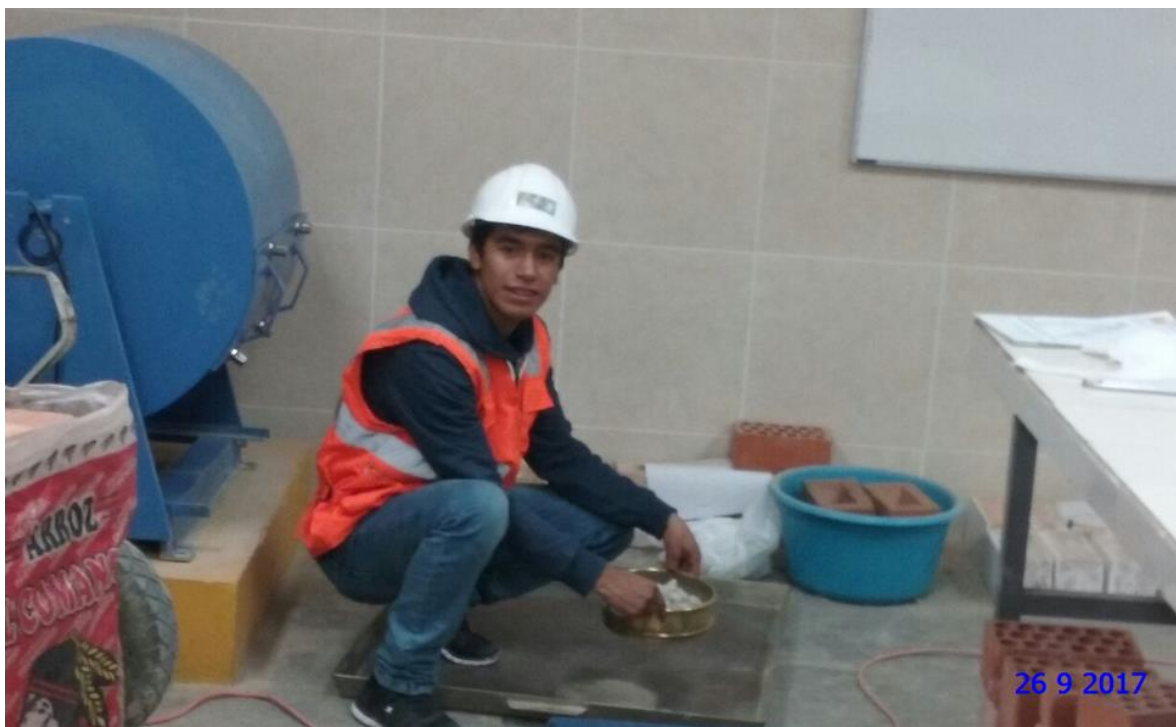
FOTO n.º 10. Tamizado de material después de 500 revoluciones en la máquina de los ángeles por la malla N°12
