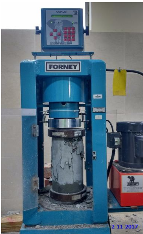
FOTO n.º 26. Ensayo de resistencia a compresión de probetas a los 14 días
