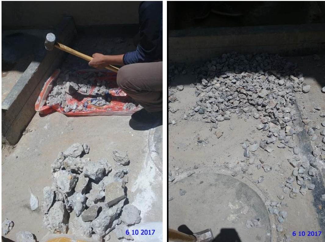
FOTO n.º 13. Triturado y tamizado del agregado reciclado.
