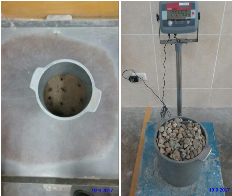
FOTO n.º 6. Ensayo para el peso unitario del agregado
