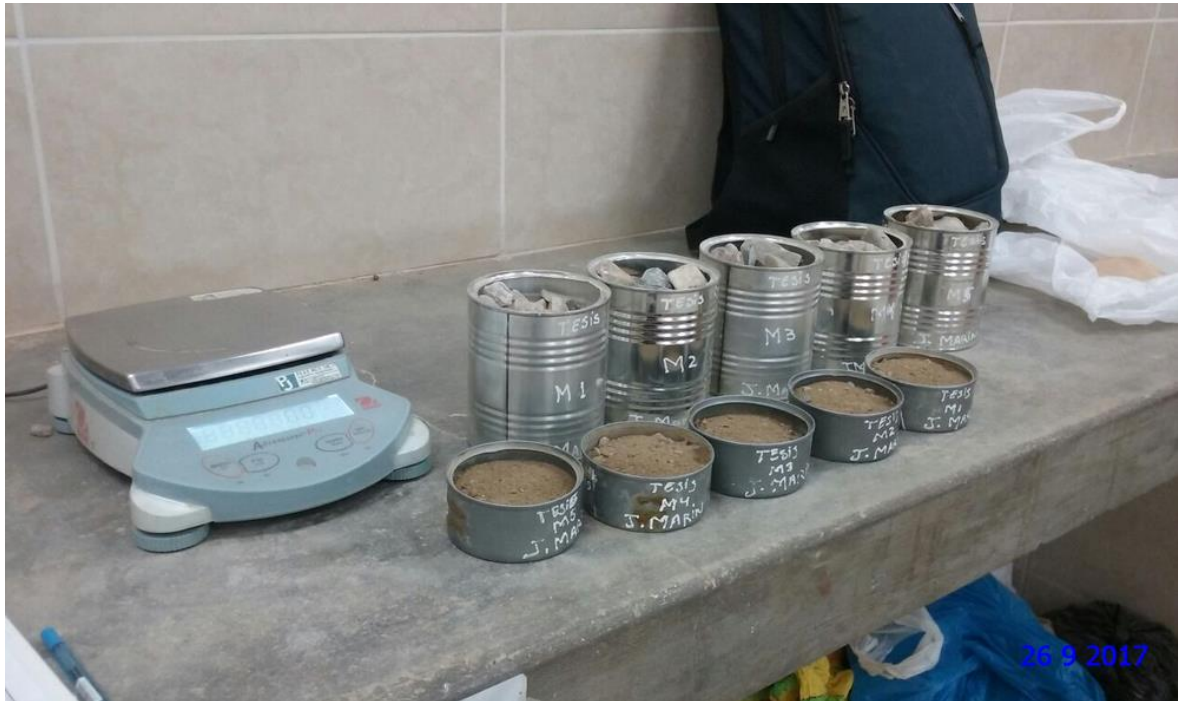
FOTO n.º 7. Peso de material húmedo para ensayo de contenido de humedad.
