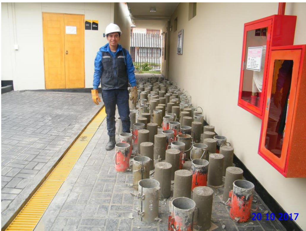
FOTO n.º 22. Desencofrado de los especímenes.
