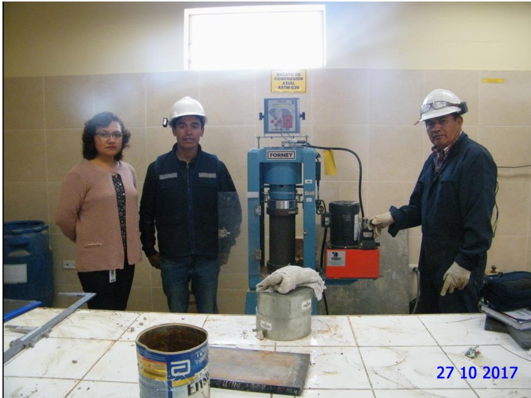
FOTO n.º 26. Ensayo de resistencia a compresión de probetas a los 14 días
