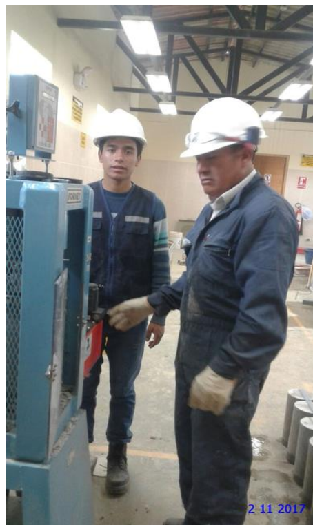
FOTO n.º 26. Ensayo de resistencia a compresión de probetas a los 14 días
