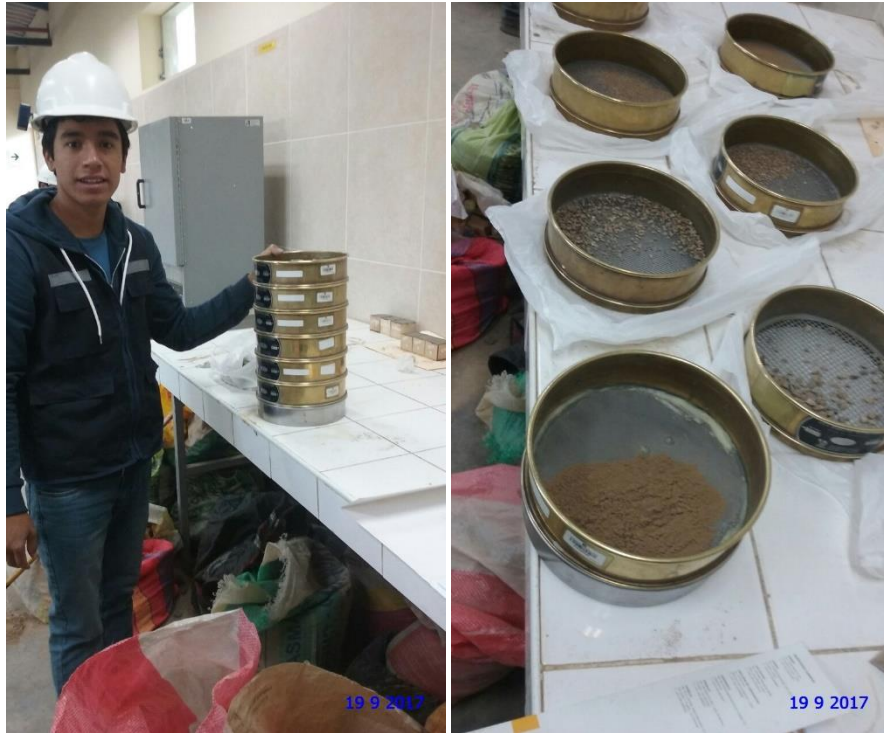
FOTO n.º 3. Análisis granulometría del agregado grueso y fino.
