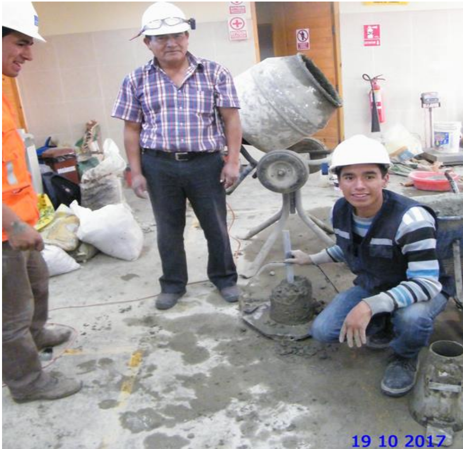
FOTO n.º 15. Ensayo para medir el asentamiento del concreto o slump.
