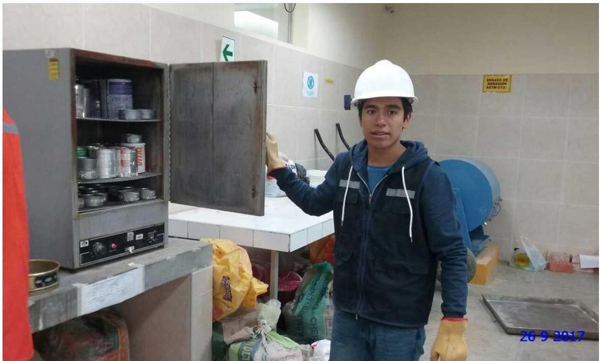
FOTO n.º 8. : Colocación de material húmedo en estufa por 24 hrs.
