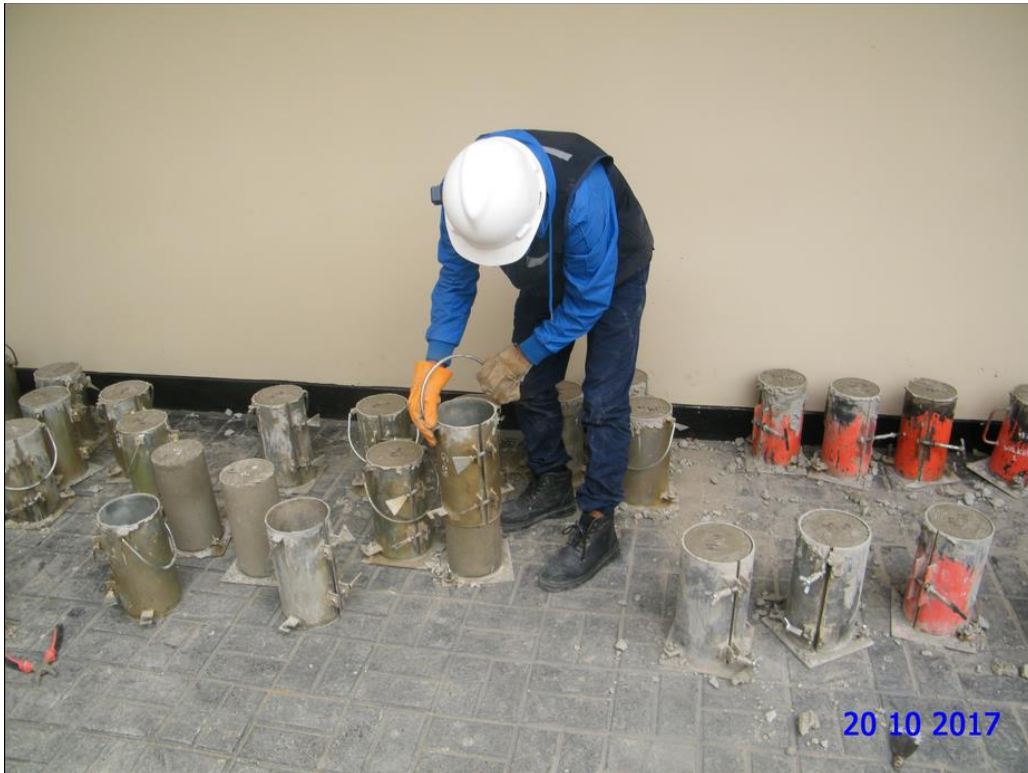
FOTO n.º 22. Desencofrado de los especímenes.
