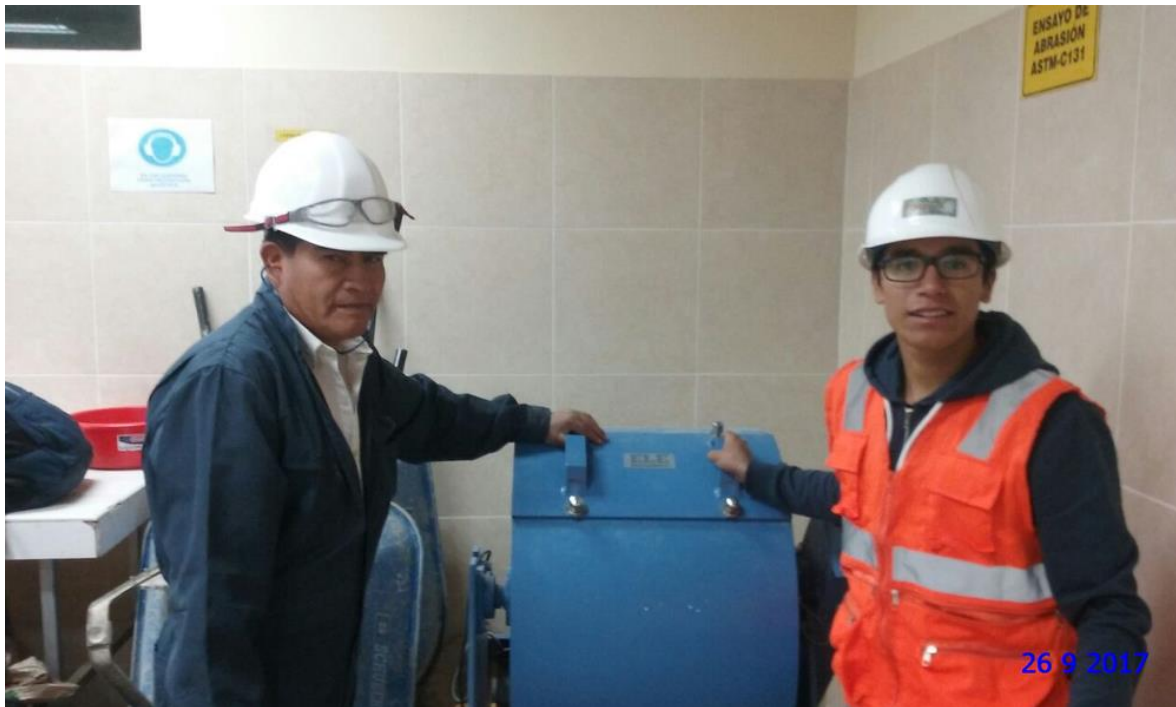
FOTO n.º 9. Colocación de material a la Máquina de los ángeles para ensayo de abrasión.
