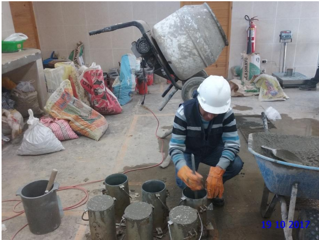
FOTO n.º 18. Colocación de concreto en moldes cilíndricos.
