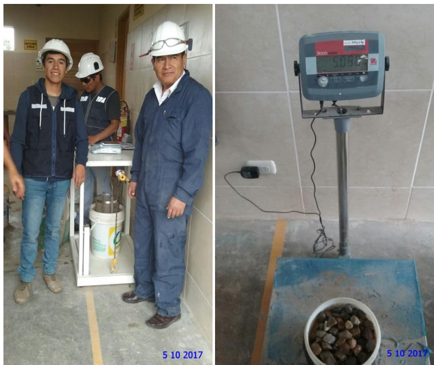
FOTO n.º 4. Ensayo para el Peso Específico del Agregado Grueso
