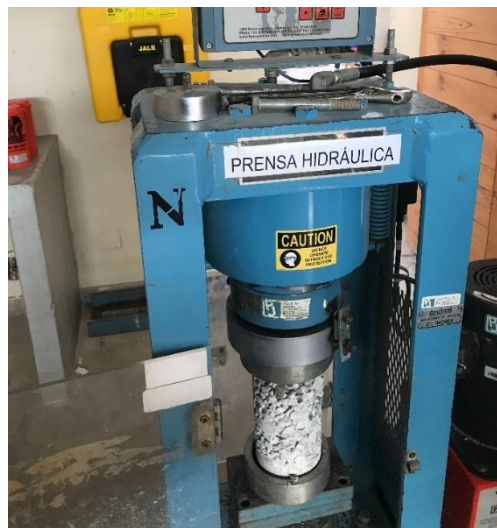
Figura N°1 Ensayo de resistencia a la compresión.
