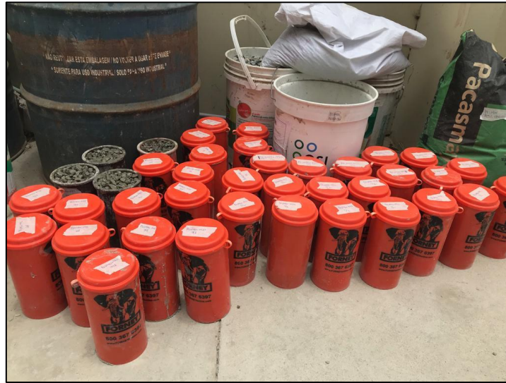
Figura N°24 Especímenes de concreto de 1/2" utilizando probetas Forney.
