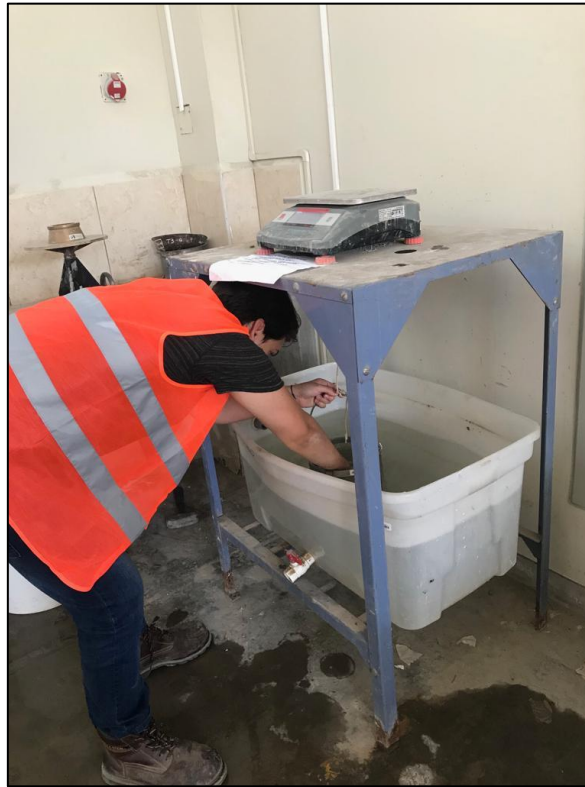
Figura N°18 Agregando el agregado a la malla metálica sumergida.
