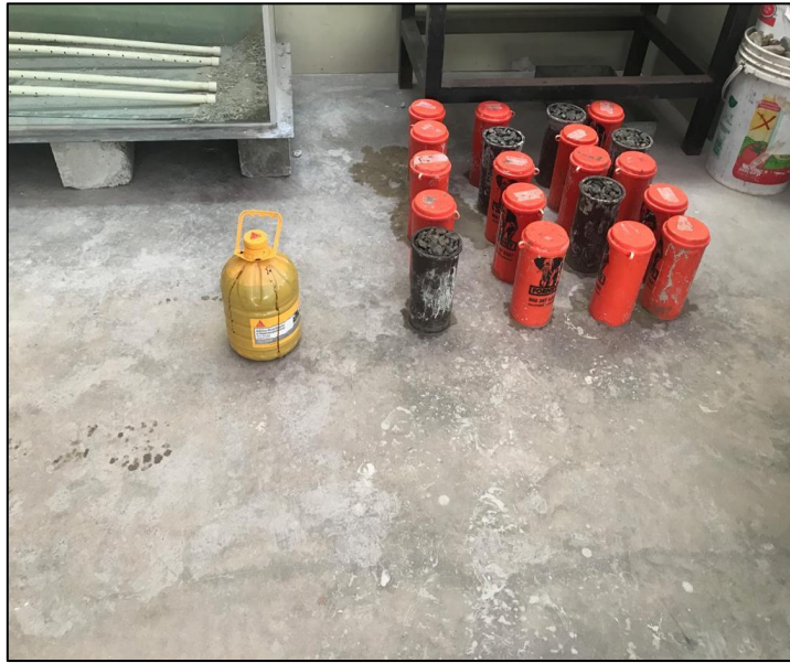
Figura N°29 Especímenes de concreto con aditivo Sika Plastiment HE-98.
