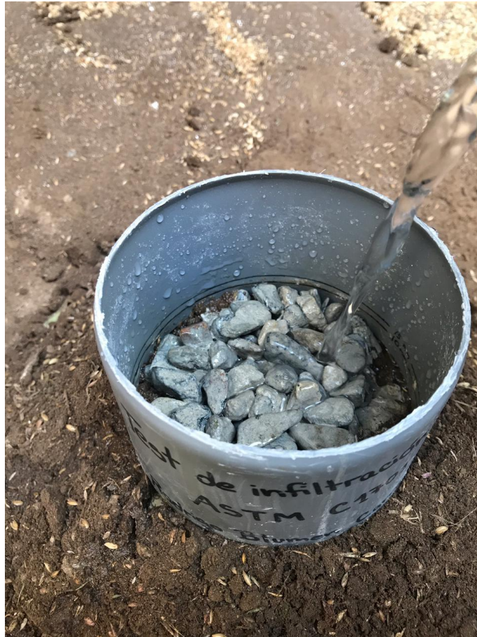
Figura N°33 Registro de infiltración en espécimen de concreto permeable.
