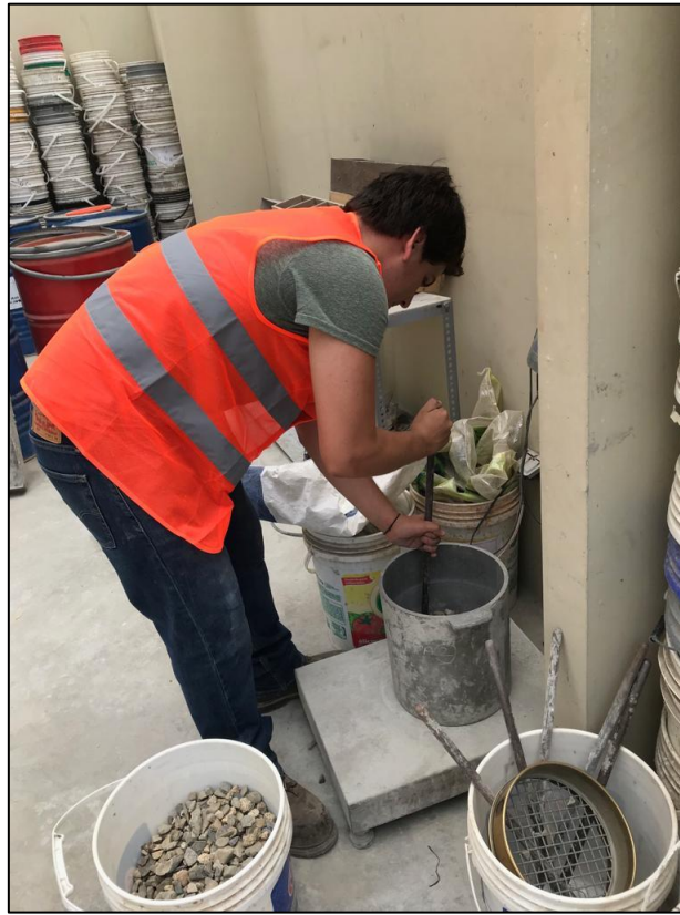
Figura N°15 Compactación del peso unitario compactado.
