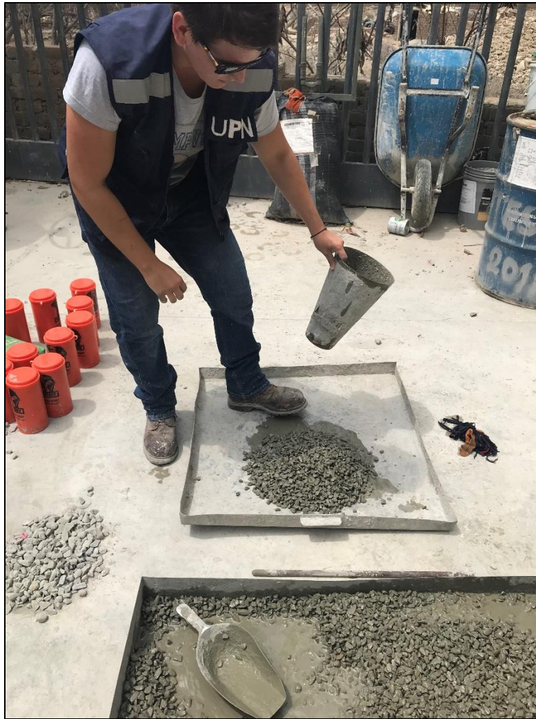
Figura N°27 Verificación del asentamiento del concreto de 3/8".
