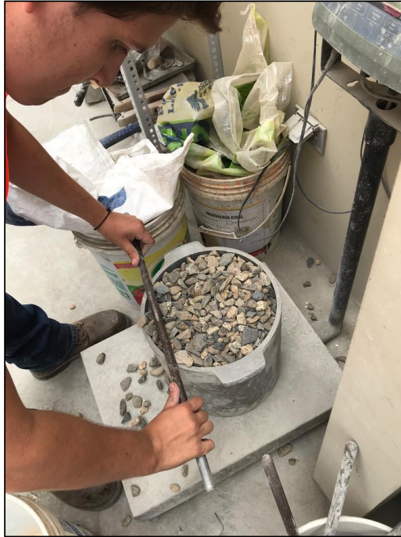
Figura N° 17 Enrasando el agregado con una varilla de acero.
