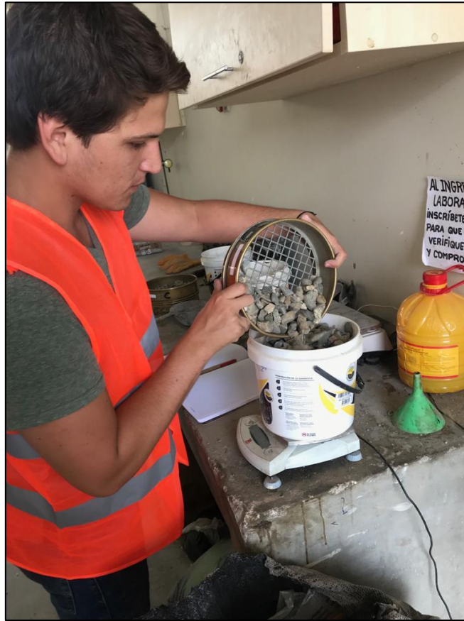
Figura N°13 Separación del agregado grueso de 1/2" y el agregado de 3/8".
