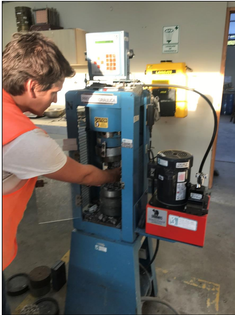
Figura N°30 Realizando el ensayo de resistencia a la compresión del concreto.
