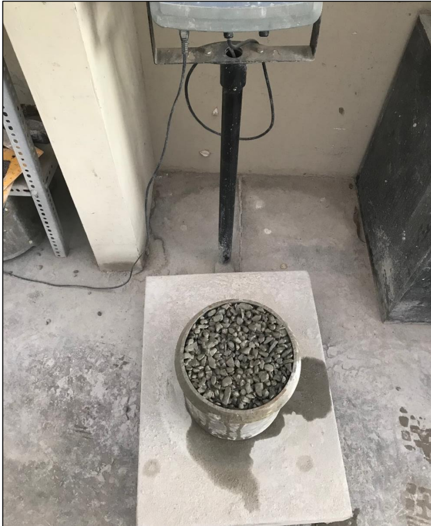
Figura N°21 Registro del peso del concreto en el recipiente de peso unitario.
