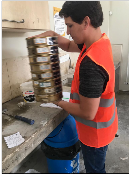
Figura N°16 Tamizado los agregados en los tamices normados.
