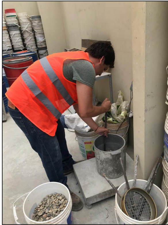
Figura N°22 Compactación para el peso unitario compactado.
