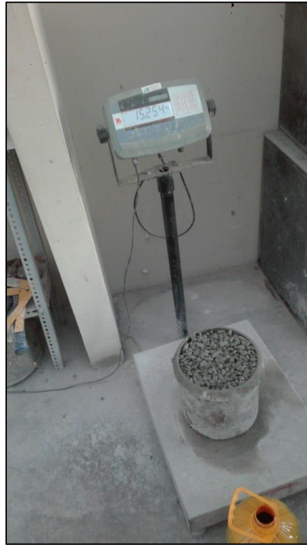
Figura N°26 Registro del peso del concreto en el recipiente de peso unitario.
