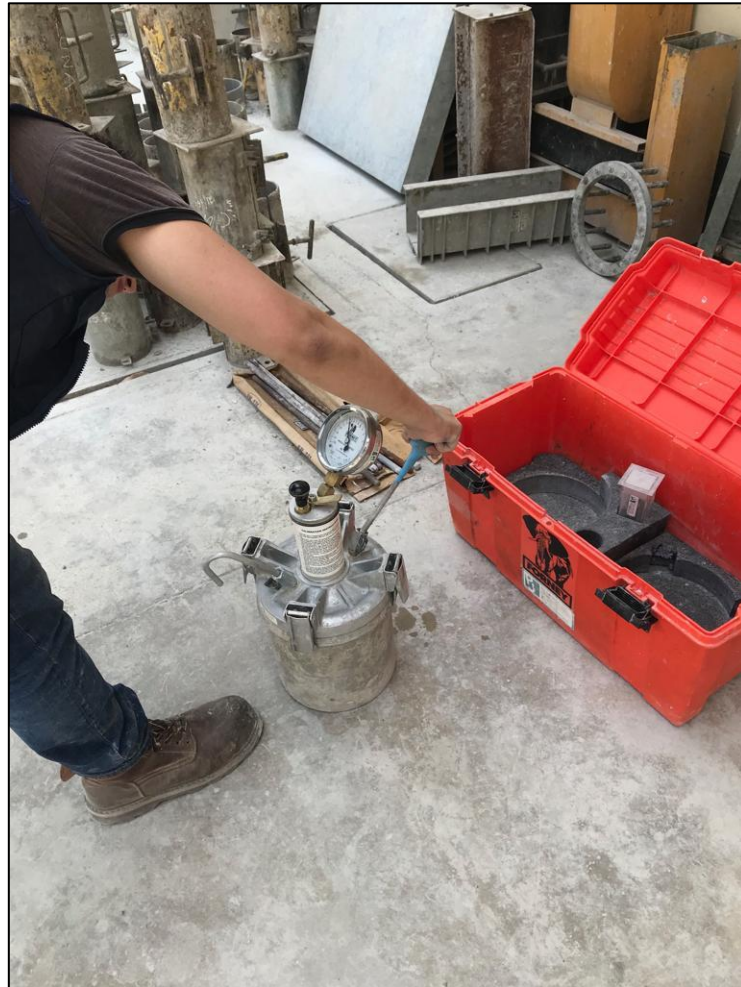
Figura N°23 Realizando el ensayo de contenido de aire del concreto.
