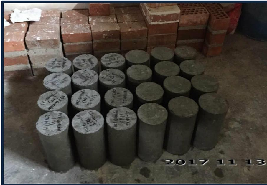
**Foto 26:** Probetas a reventar.
