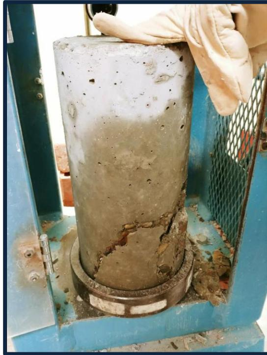
**Foto 36:** Ensayo a compresión a los 14 días (0% vidrio molido).
