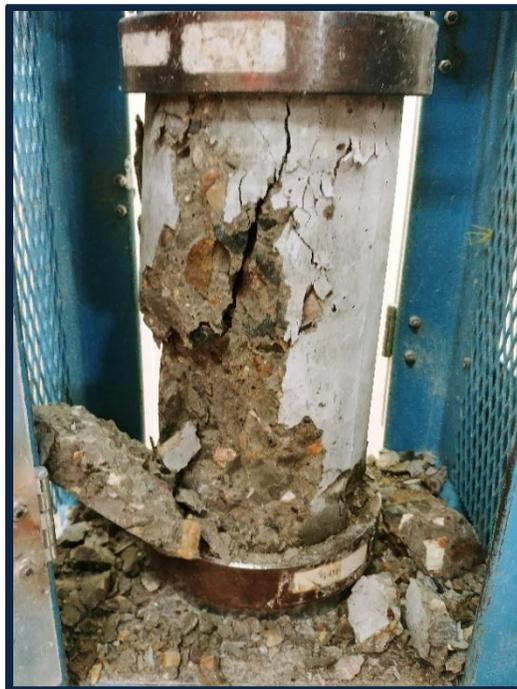
**Foto 51:** Ensayo a compresión a los 28 días (15% vidrio molido).
