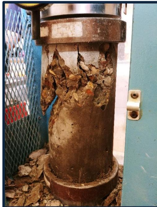
**Foto 45:** Ensayo a compresión a los 28 días (0% vidrio molido).
