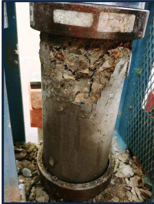
**Foto 48:** Ensayo a compresión a los 28 días (10% vidrio molido).
