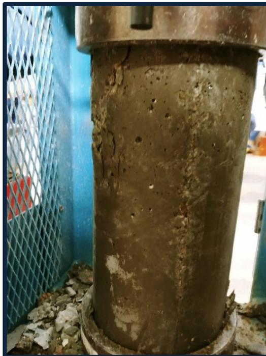
**Foto 31:** Ensayo a compresión a los 7 días (5% vidrio molido).
