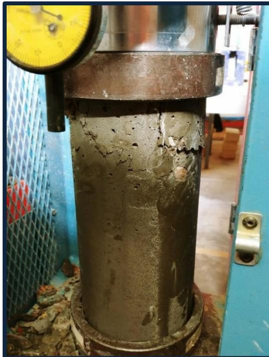
**Foto 33:** Ensayo a compresión a los 7 días (10% vidrio molido).
