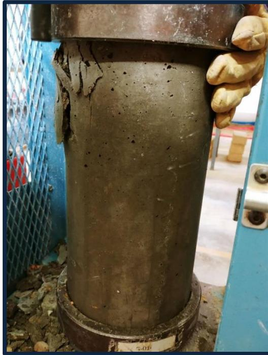
**Foto 32:** Ensayo a compresión a los 7 días (10% vidrio molido).
