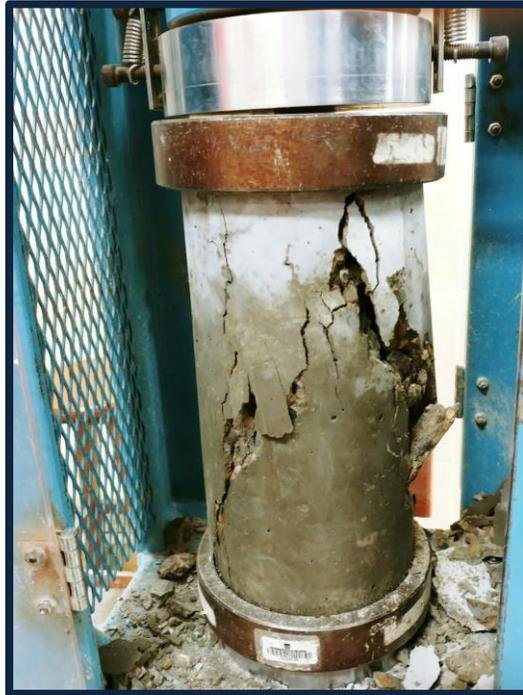
**Foto 42:** Ensayo a compresión a los 14 días (15% vidrio molido).
