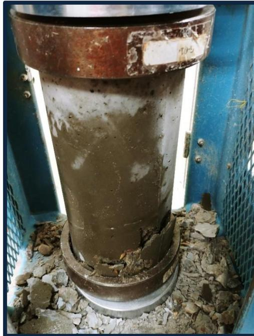
**Foto 40:** Ensayo a compresión a los 14 días (10% vidrio molido).
