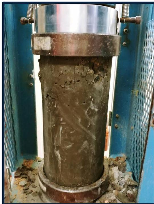
**Foto 29:** Ensayo a compresión a los 7 días (0% vidrio molido).
