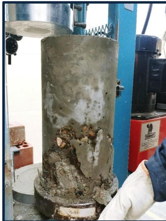
**Foto 37:** Ensayo a compresión a los 14 días (0% vidrio molido).
