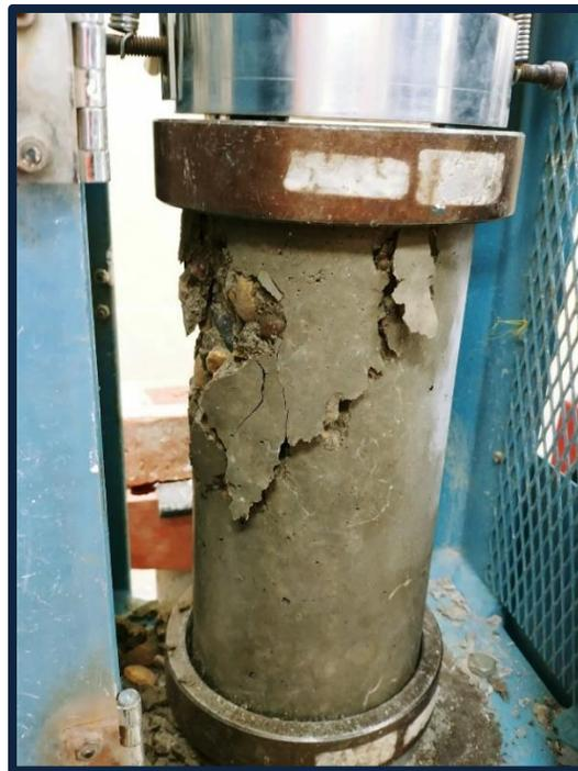
**Foto 39:** Ensayo a compresión a los 14 días (5% vidrio molido).
