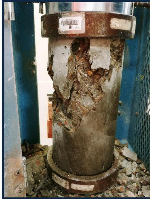
**Foto 44:** Ensayo a compresión a los 28 días (0% vidrio molido).
