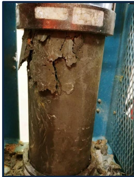
**Foto 35:** Ensayo a compresión a los 7 días (15% vidrio molido).
