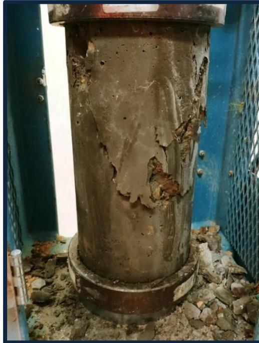
**Foto 34:** Ensayo a compresión a los 7 días (15% vidrio molido).
