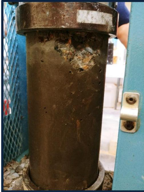
**Foto 50:** Ensayo a compresión a los 28 días (15% vidrio molido).
