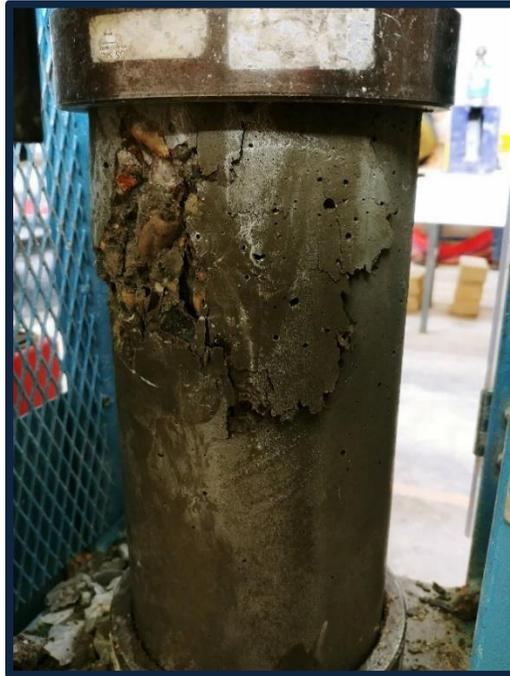
**Foto 30:** Ensayo a compresión a los 7 días (5% vidrio molido).
