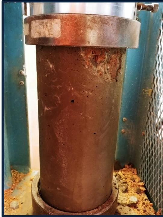
**Foto 28:** Ensayo a compresión a los 7 días (0% vidrio molido).
