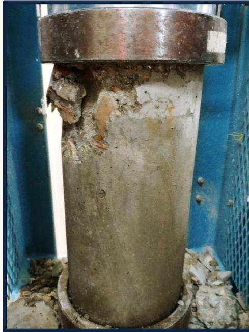
**Foto 46:** Ensayo a compresión a los 28 días (5% vidrio molido).
