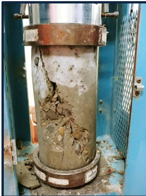
**Foto 41:** Ensayo a compresión a los 14 días (10% vidrio molido).
