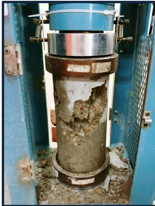
**Foto 43:** Ensayo a compresión a los 14 días (15% vidrio molido).
