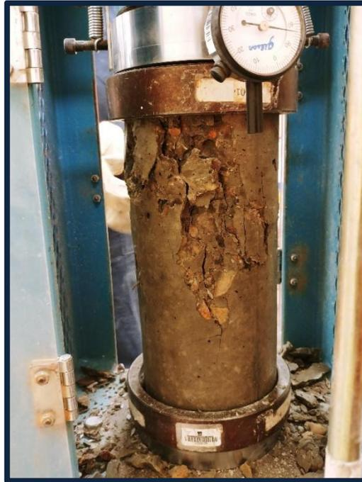
**Foto 38:** Ensayo a compresión a los 14 días (5% vidrio molido).
