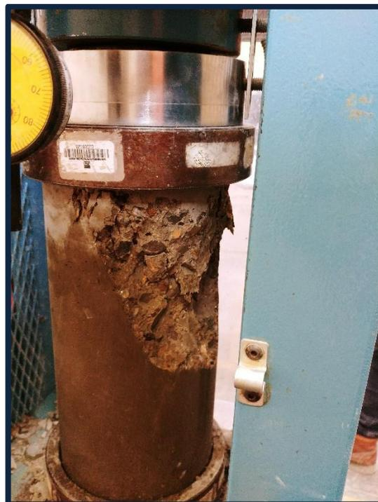
**Foto 49:** Ensayo a compresión a los 28 días (10% vidrio molido).
