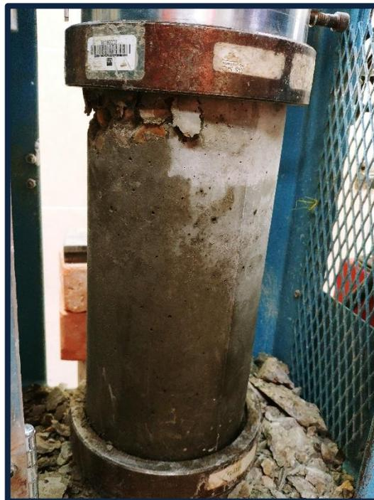
**Foto 47:** Ensayo a compresión a los 28 días (5% vidrio molido).
