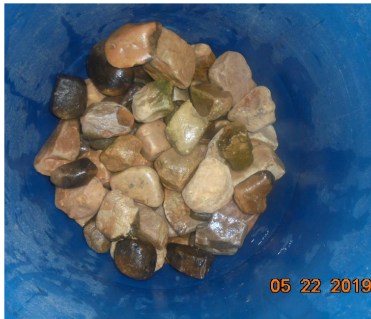
Figura 5. Colocación de la piedra grande \Phi 4" de la quebrada El Tambo (h=0.25 m).
