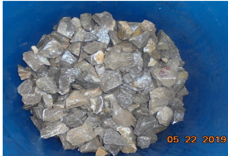
Figura 6. Colocación de la caliza triturada \Phi 3/4" (h=0.15m).
