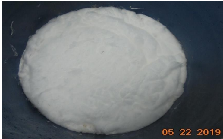
Figura 9. Colocación de la faja de algodón (h=0.03 m).
