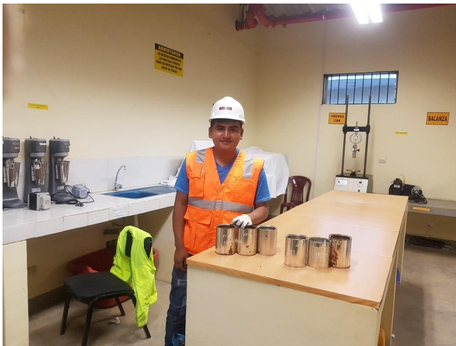
Fotografía N° 4 Contenido de humedad de los agregados.
