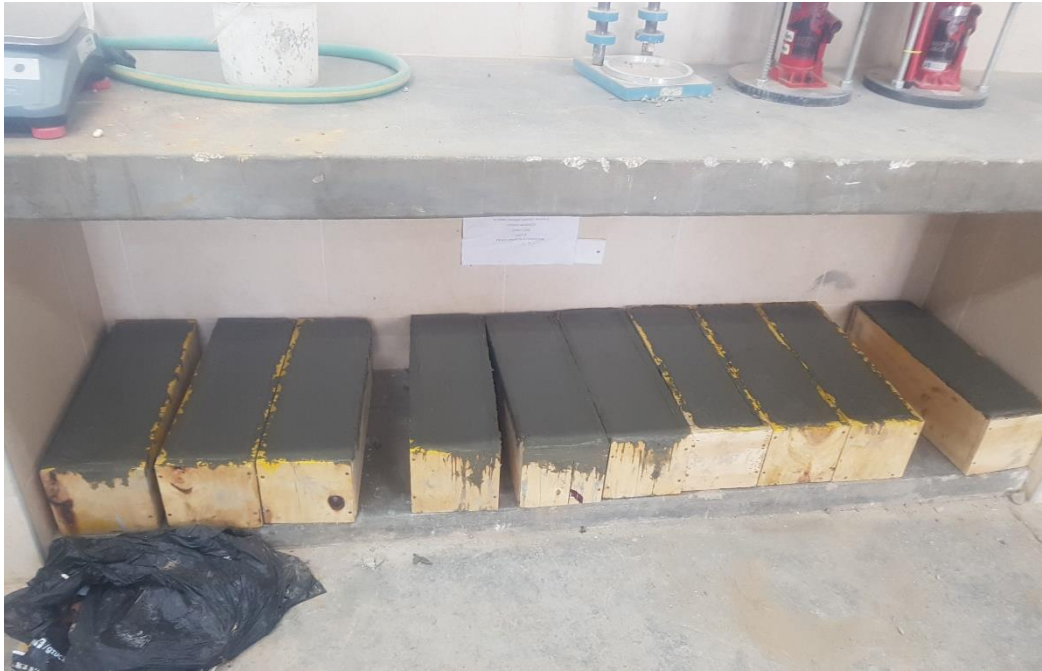
Fotografía N° 11. Elaboración de vigas de concreto simple.
