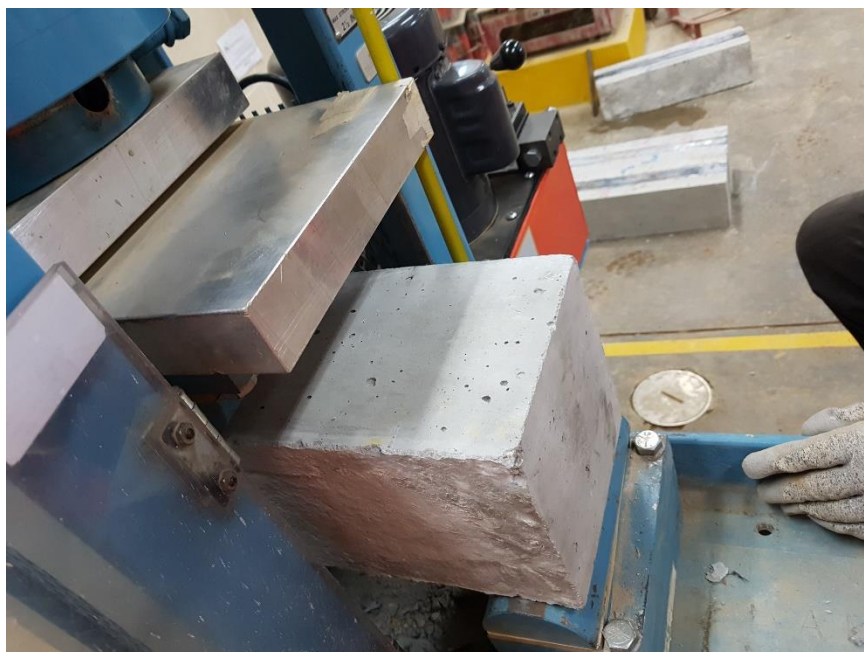
Fotografía N° 18 Rotura de vigas de concreto simple sin y con reforzamiento de fibra de carbono.
