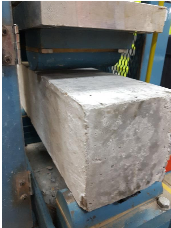
Fotografía N° 17 Rotura de vigas de concreto simple sin y con reforzamiento de fibra de carbono.
