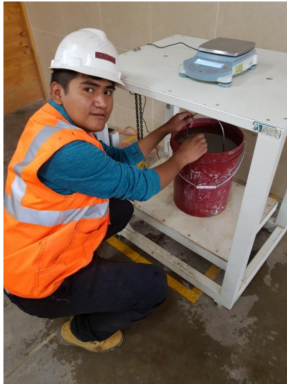
Fotografía N° 6 Ensayo para determinar la gravedad específica y la absorción de agregados gruesos.
