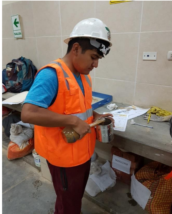
Fotografía N° 5. Ensayo para determinar la gravedad específica y la absorción de agregados finos.
