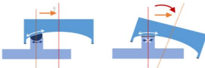
Figura 7. Función de la articulación en aisladores FPS.
