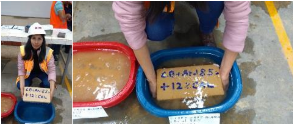
Imagen 24: Sumersión en tinas llenas de agua de las unidades enteras de BTC para el ensayo de grado de absorción de agua
