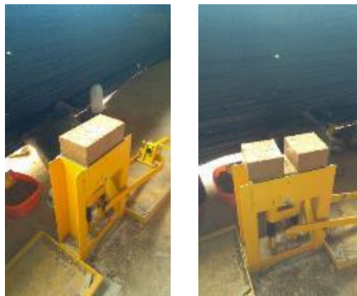
Imagen 17: BTC elaborados en la máquina CINVA RAM
