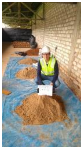
Imagen 14: Preparación de los suelos y de las mezclas de suelo estabilizadas con arena y cal
