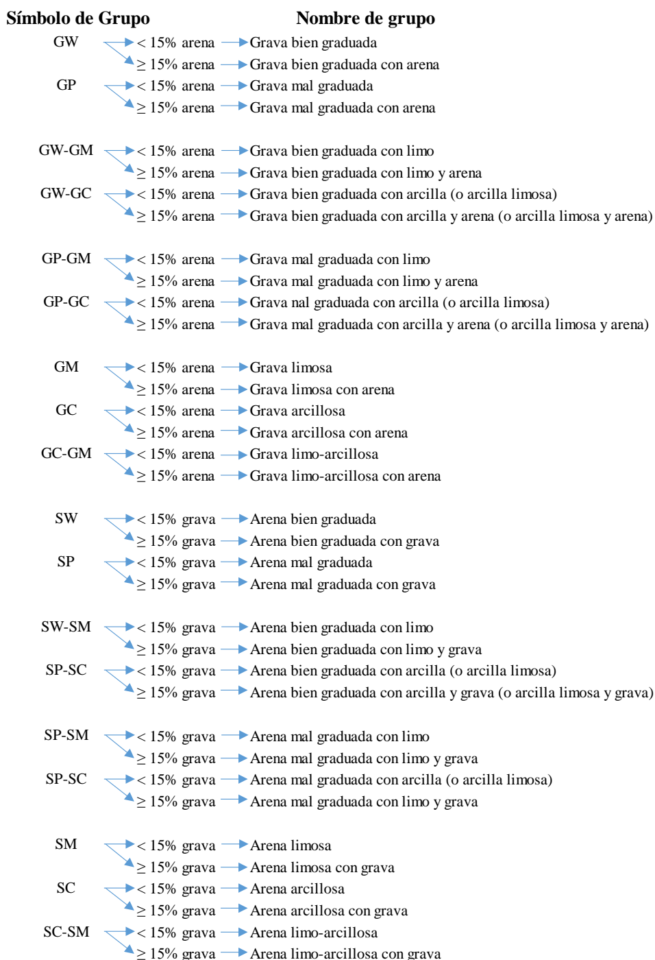
Figura 11: Diagrama de flujo para nombres de grupo de suelos gruesos tipo grava y arenosos Fuente: ASTM (1998)
