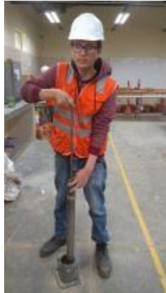
Imagen 9: Compactación con martillo del suelo húmedo en el molde tipo A
