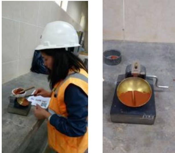
Imagen 6: Colocación de una capa de suelo húmedo en la copa de Casagrande para seguidamente hacer la ranura
