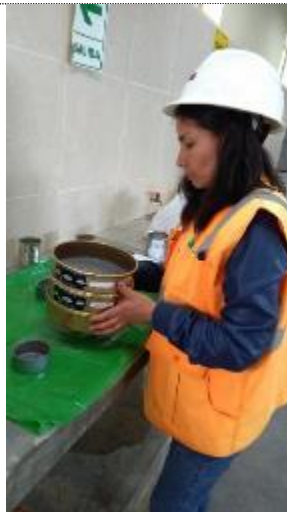
Imagen 4: Tamizado de la muestra seca después de ser retirada del horno
