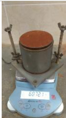
Imagen 10: Peso de la plataforma, molde y suelo húmedo compactado para la determinación de la densidad húmeda
