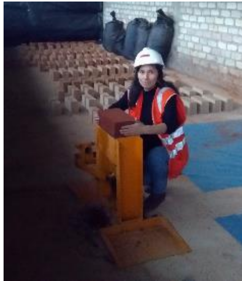
Imagen 18: Extracción del BTC de la máquina CINVA RAM para su posterior almacenaje
