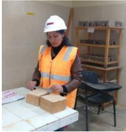
Imagen 20: Toma de medidas de las medias unidades de BTC para el ensayo de resistencia a compresión
