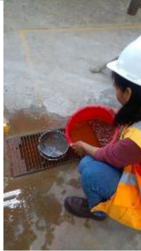
Imagen 3: Lavado de la muestra de suelo en la malla N°200
