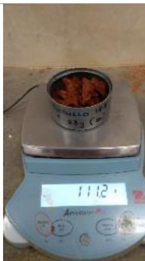
Imagen 11: Peso de una muestra de suelo compactado en el molde para determinar su contenido de humedad
