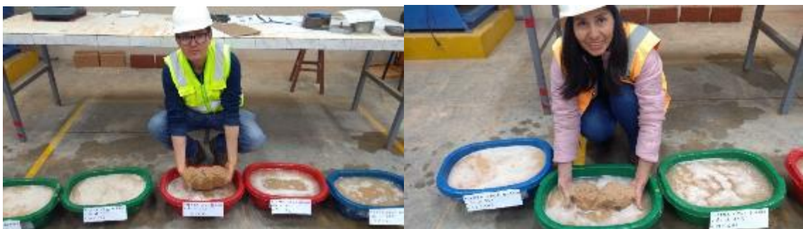
Imagen 25: Verificación de que ninguna de las unidades de BTC pasaron el ensayo de grado de absorción de agua pues se desmoronaron completamente al contacto con esta.
