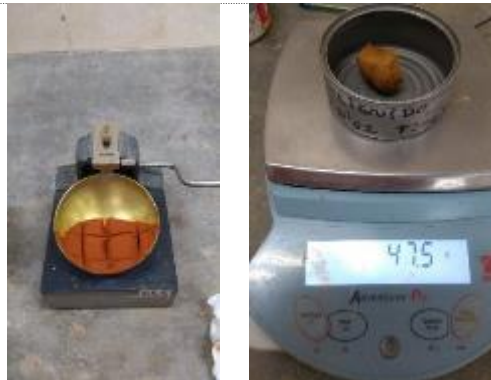
Imagen 7: Retiro de la parte central del suelo que fallo a un determinado número de golpes en la copa de Casagrande para luego pesarlo y encontrar su contenido de humedad
