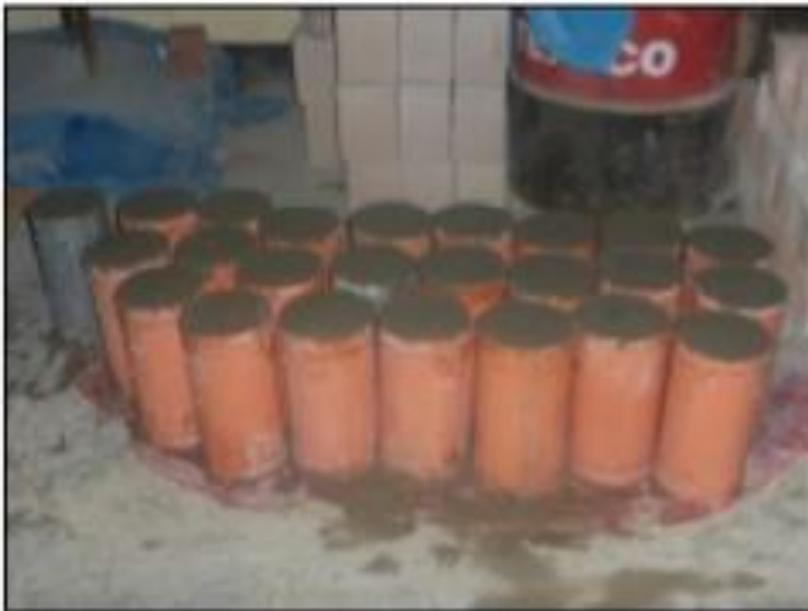
**Fotografía N°9. Probetas listas para el ensayo a compresión.**
