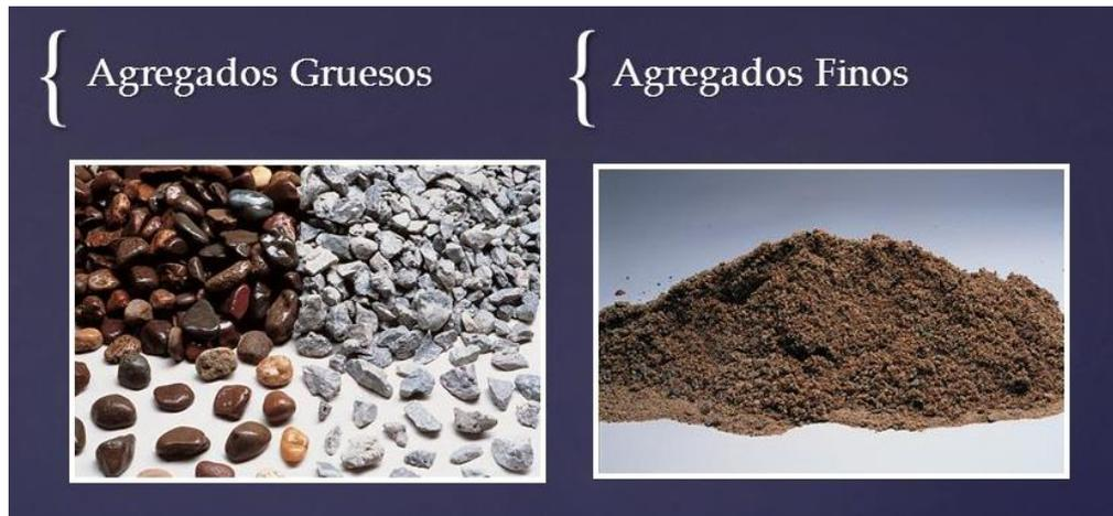
**Fotografía N°2. Material usado para la determinación del peso específico del agregado fino.**
