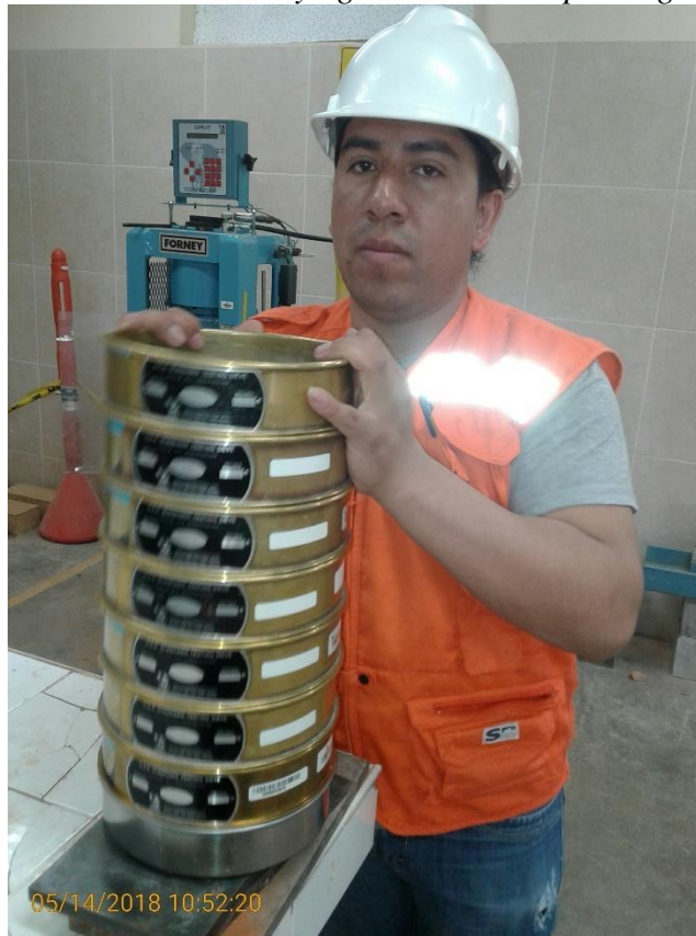
FOTOGRAFIA 6: Elaboración de ensayo granulométrico para agregado fino.
