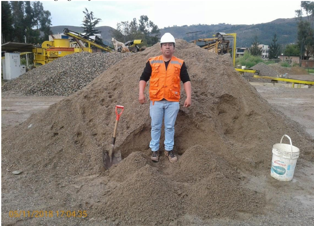
FOTOGRAFIA 5: Cuarteo del agregado fino en cantera.
