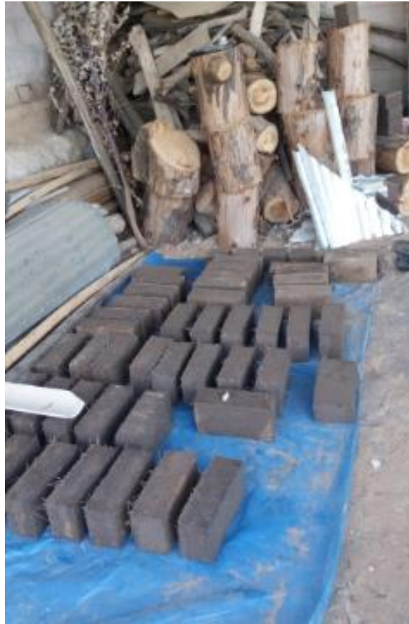
Fotografía N° 30: Adobes en proceso de secado natural de 28 días
