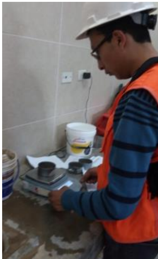
Fotografía N° 25: Pesaje de las taras del ensayo de contenido de humedad
