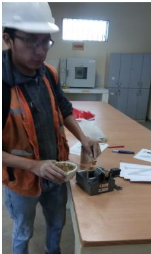
Fotografía N° 27: Ensayo de límite plástico
