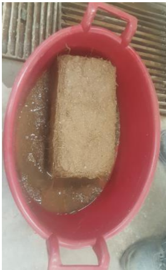
Fotografía N° 37: Adobe con 0.3% de incorporación de fibra nylon de cáñamo antes de ser sumergido en agua
