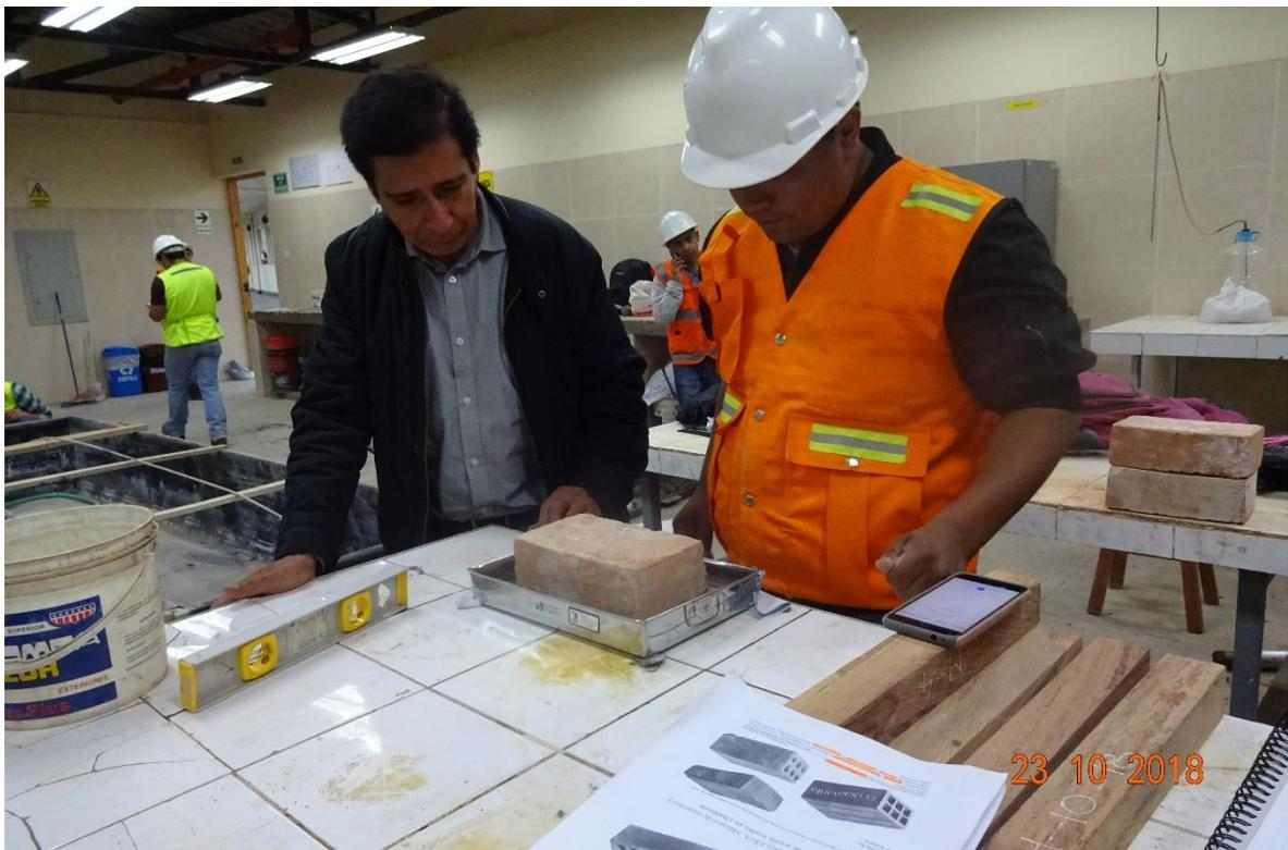
*Fotografía 30: Se dejó sumergir durante un minuto la unidad de albañilería, con la supervisión de mi asesor.*
