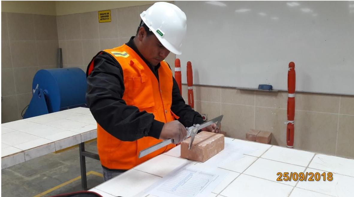
*Fotografía 9: Realizando la medida de longitud con vernier de cada espécimen.*
