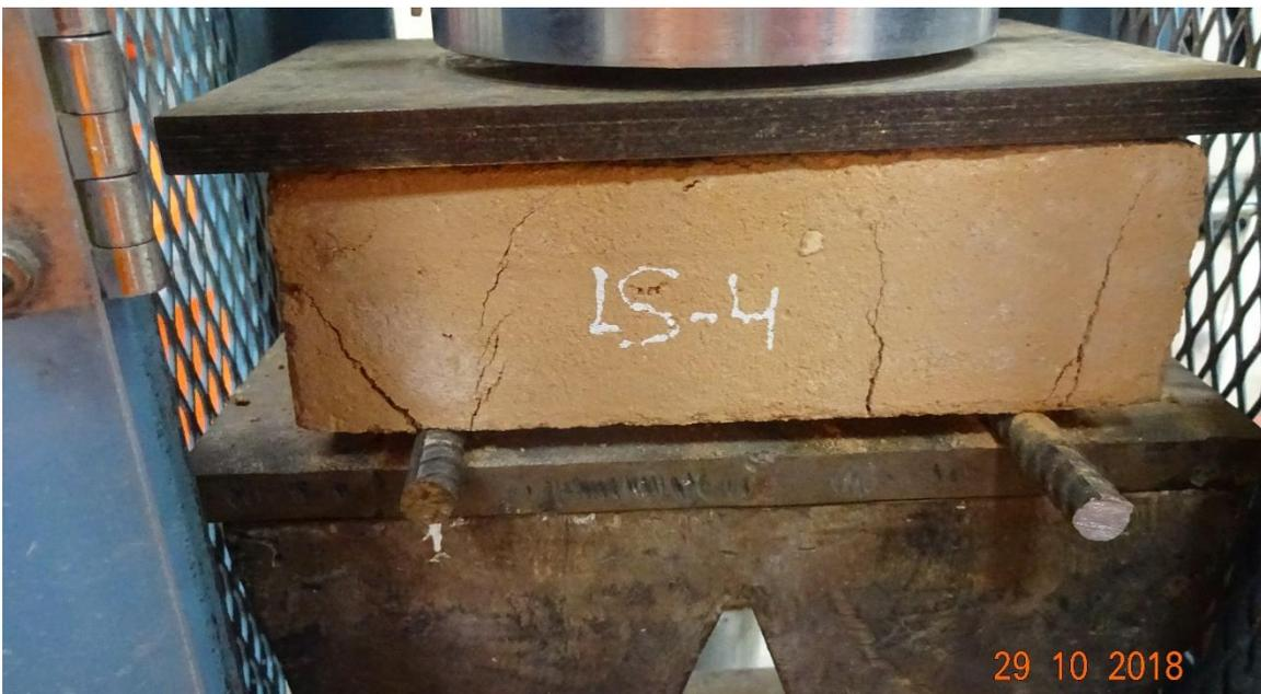
Fotografía 22: Falla en ensayo a tracción de la ladrillera “Sánchez”.
