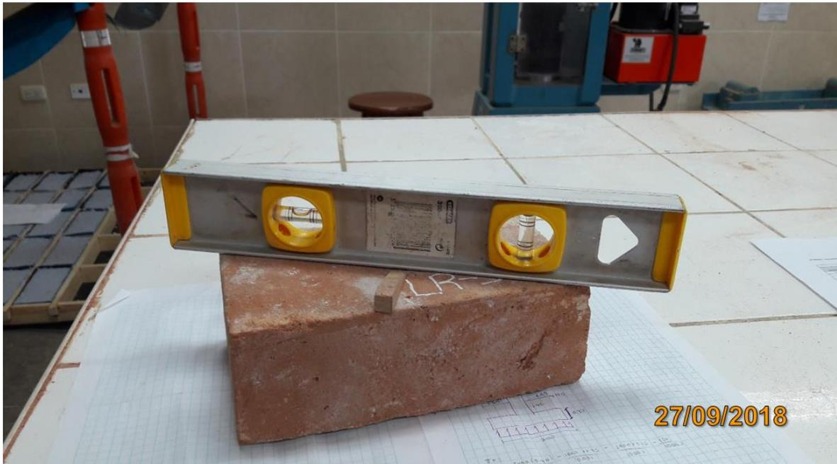
*Fotografía 11: Utilizando el nivel de carpintero para obtener el resultado cóncavo*
