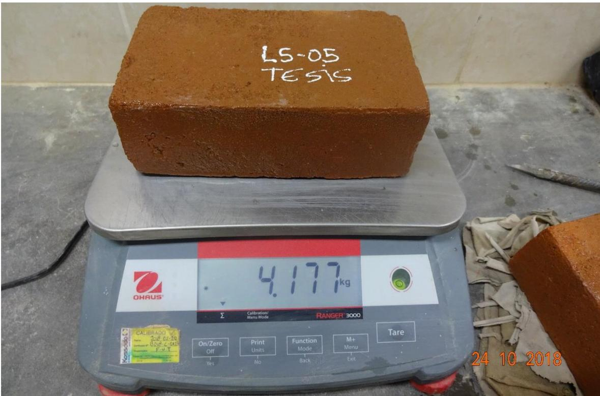
*Fotografía 36: Se retiró del agua y se pesó cada unidad de albañilería.*
