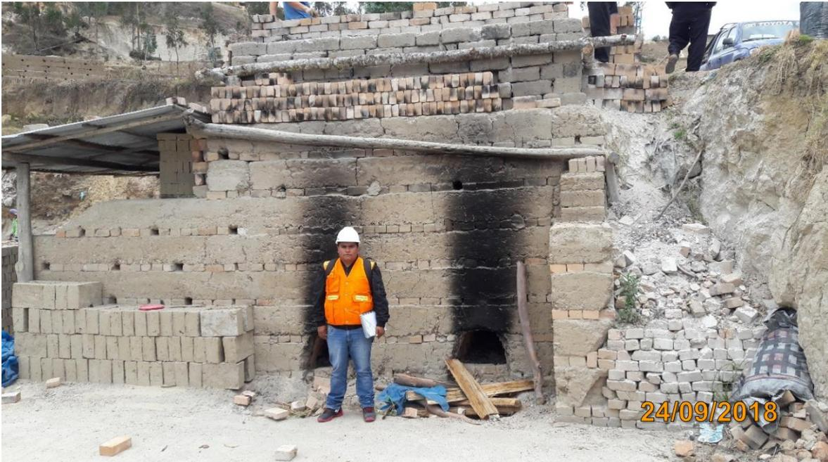
*Fotografía 5: Carga del horno con dos canaletas o sopletes.*
