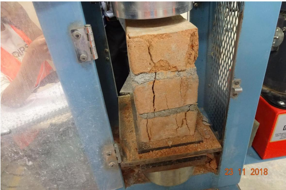
*Fotografía 46: Falla de resistencia a compresión en pilas de la ladrillera “Sánchez”*
