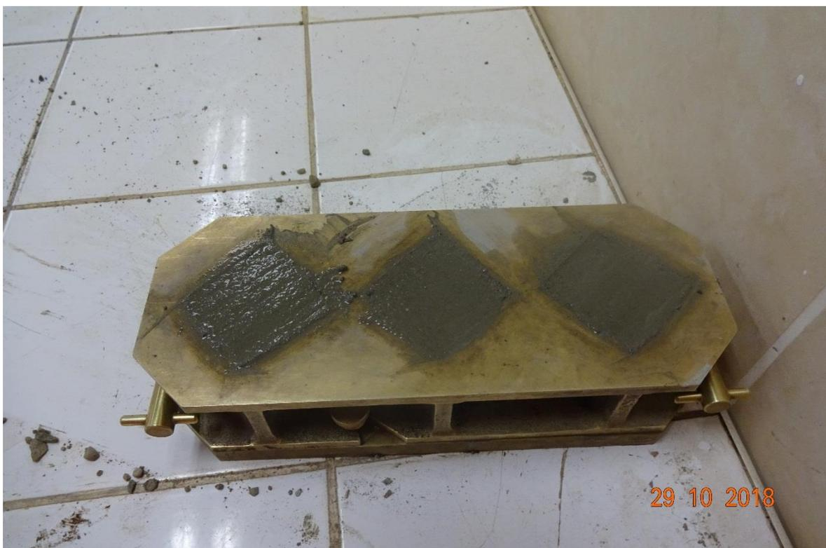
*Fotografía 50: Construcción de cubitos de concreto de 5x5x5 cm.*
