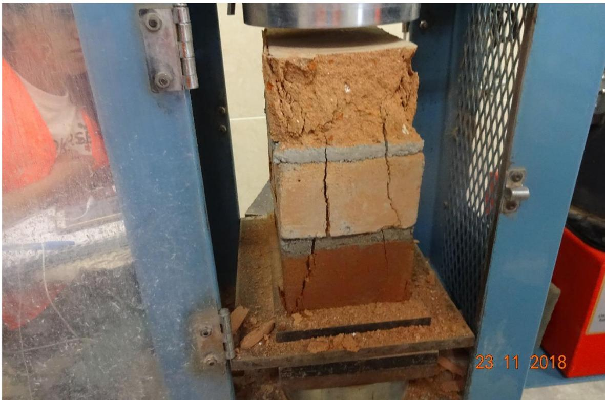
*Fotografía 48: Falla de resistencia a compresión en pilas de la ladrillera “Rodríguez”*
