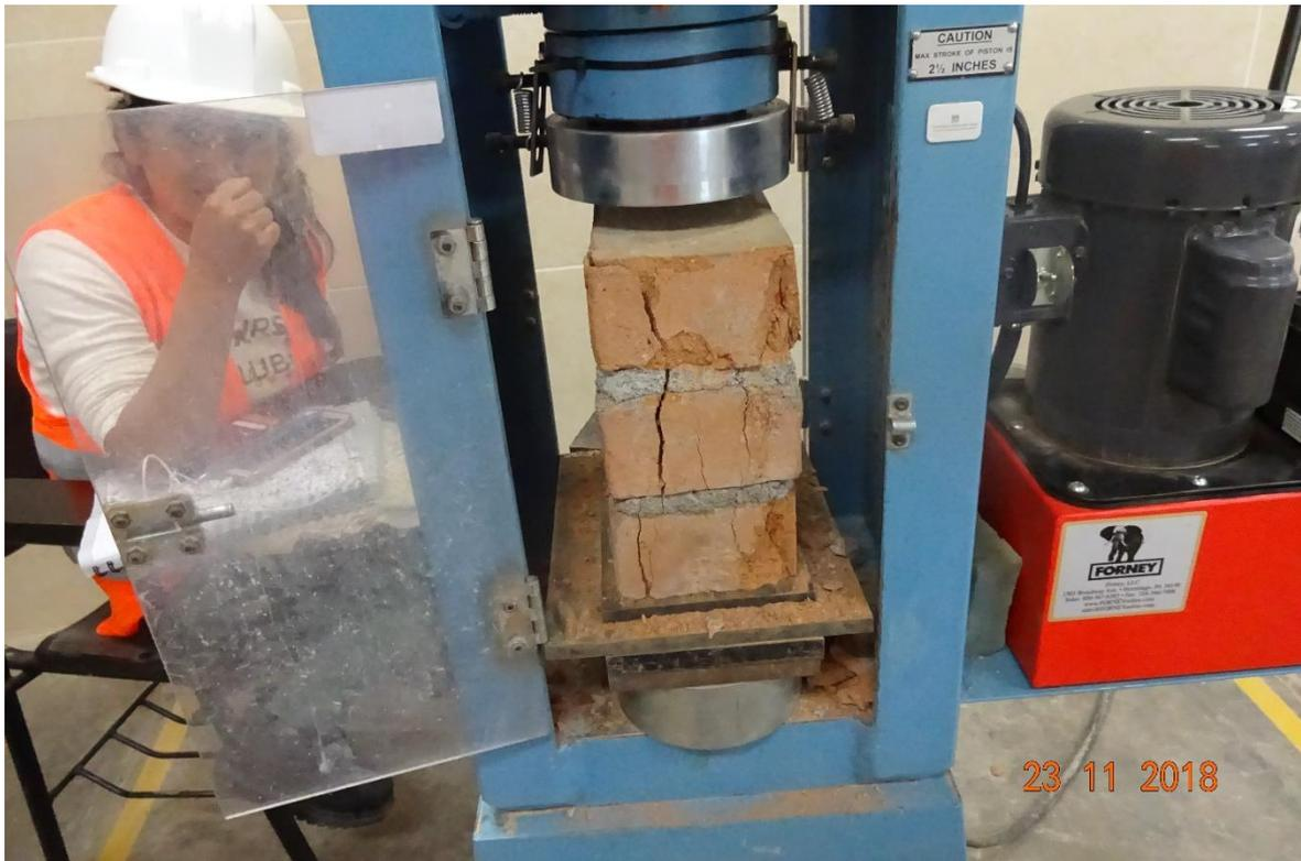
*Fotografía 47: Falla de resistencia a compresión en pilas de la ladrillera “Infante”*
