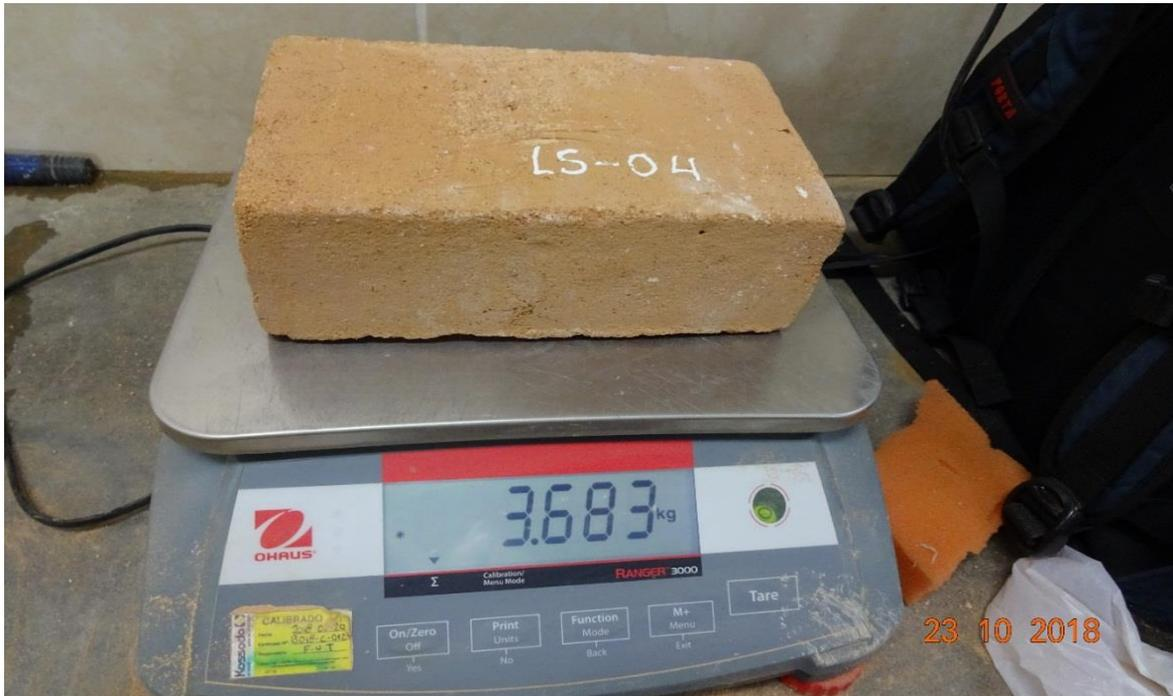
Fotografía 27: Peso seco de las unidades de albañilería de cada ladrillera.
