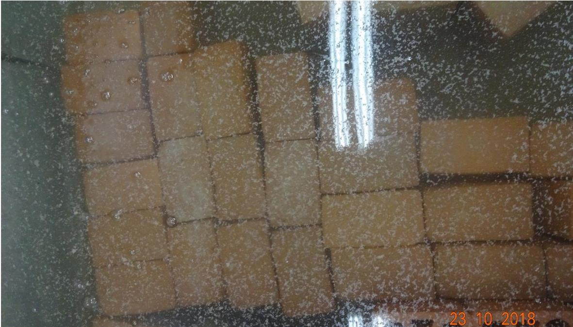
*Fotografía 33: Unidades sumergidas totalmente durante 24 horas en el recipiente de agua.*
