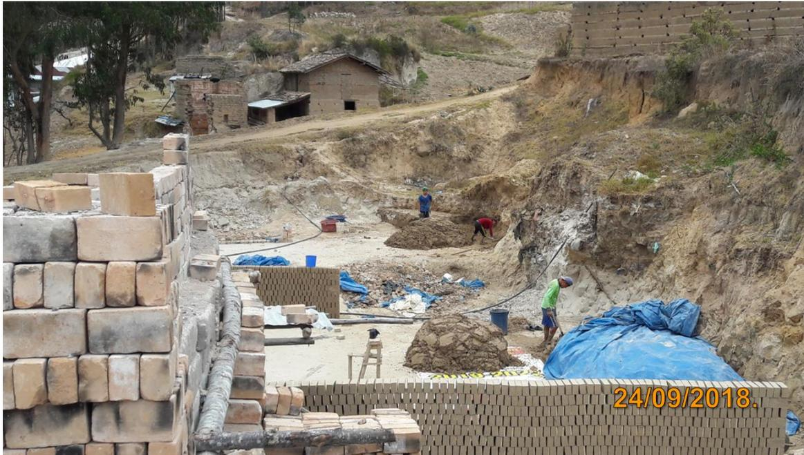
*Fotografía 1 : Extracción de arcilla con pico y pala*
