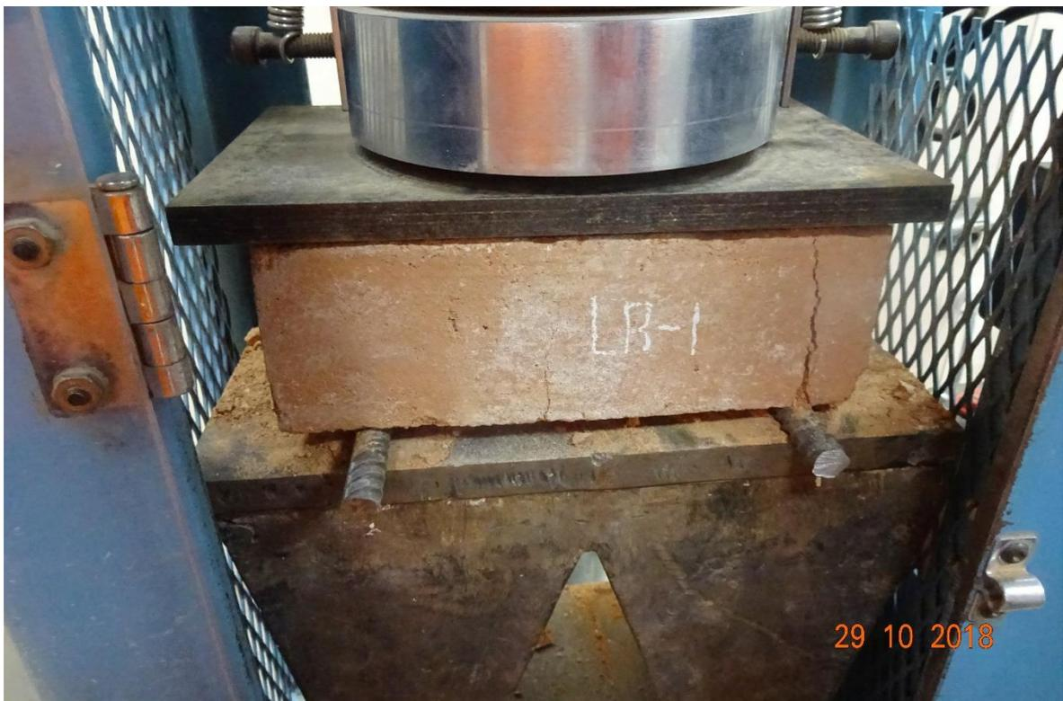
*Fotografía 24: Falla en ensayo a tracción de la ladrillera "Rodríguez".*
