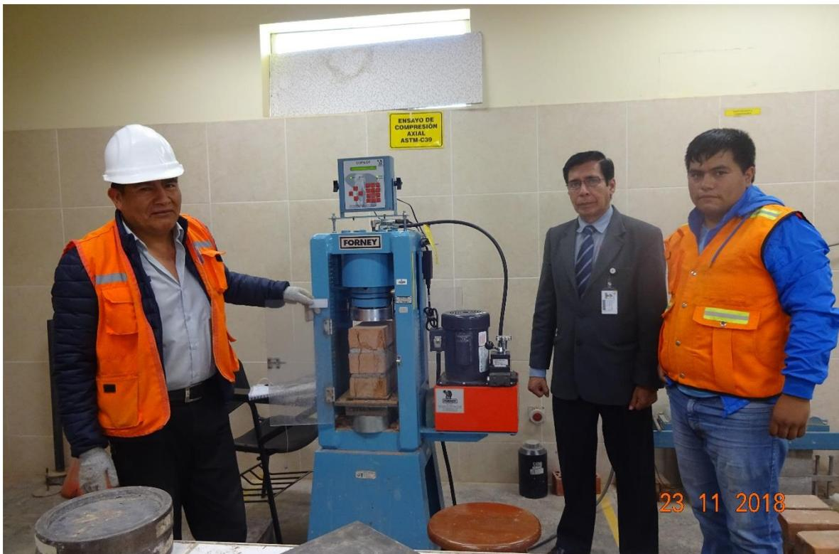
*Fotografía 44: Ensayo de resistencia a compresión de pilas con la supervisión de mi asesor*
