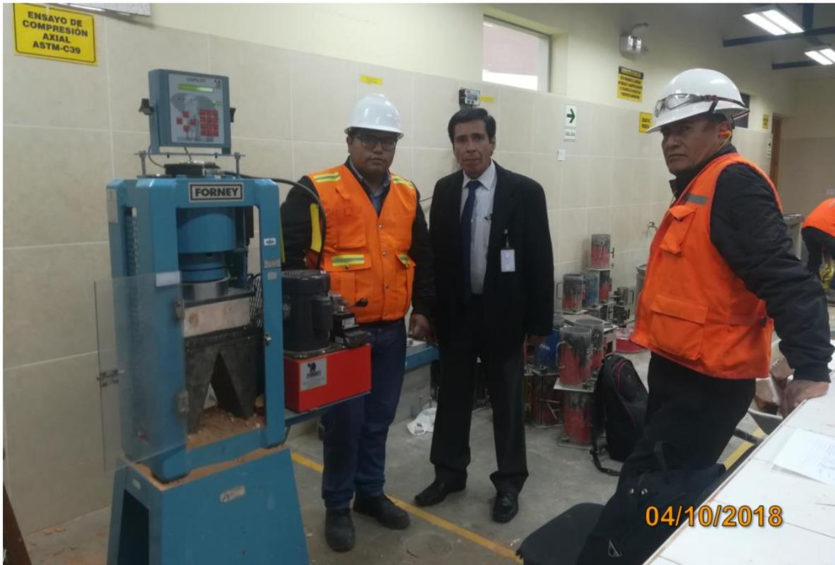
*Fotografía 17: Ensayo de resistencia a compresión de la unidad de Albañilería ( $f^b$ ) con la supervisión de mi asesor.*
