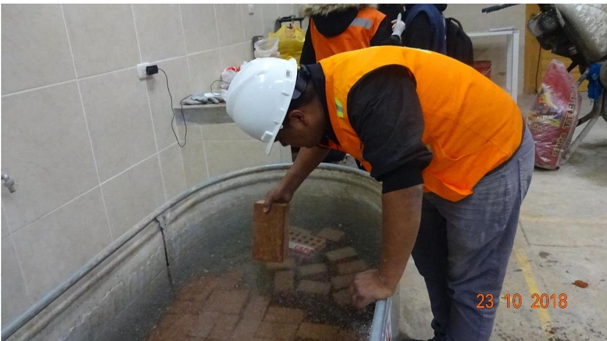
*Fotografía 34: Se introdujeron todas las unidades de albañilería dentro del agua.*
