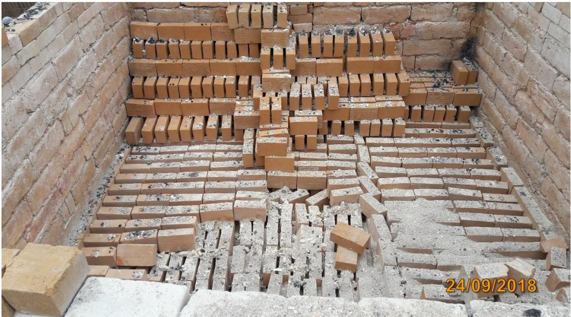
*Fotografía 6: Cocción de los ladrillos, interior del horno, cada 6 capas de ladrillo se coloca el Carbón de piedra.*
