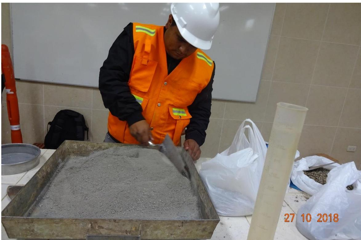
Fotografía 38: Mezcla de mortero cemento=1, cal=1/4, arena=3.
