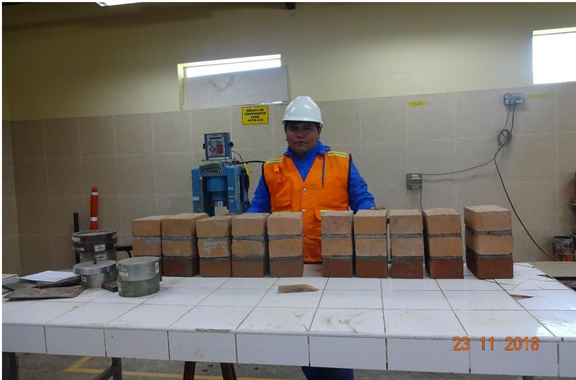
*Fotografía 43: Pilas para realizar el ensayo de resistencia a compresión en pilas*
