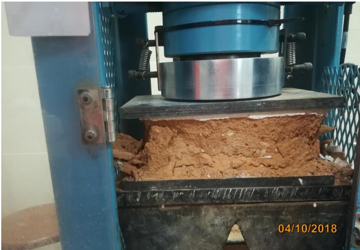
*Fotografía 20: Fallas de la unidad de albañilería de la ladrillera “Rodríguez”*
