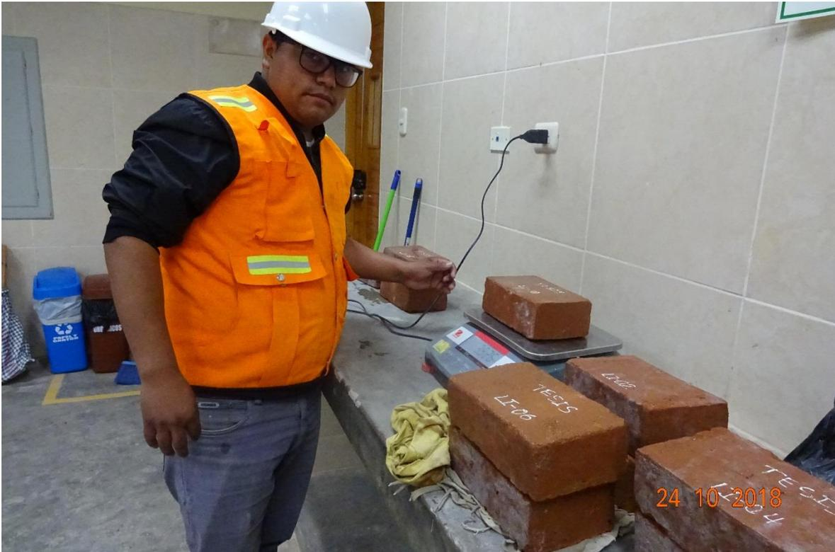
*Fotografía 35: Se retiró del agua y se pesó cada unidad de albañilería.*
