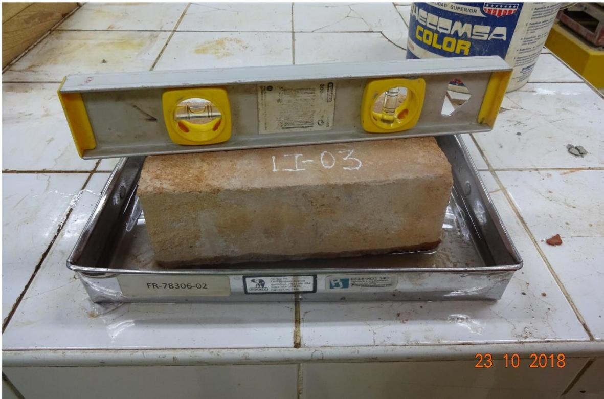
Fotografía 31: Finalmente se saca la unidad de albañilería y se pesa.
