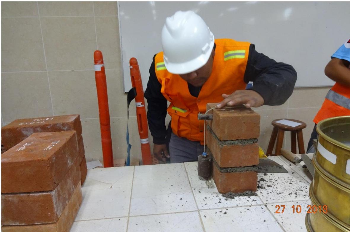
*Fotografía 41: Nivelación de pila con plomada.*
