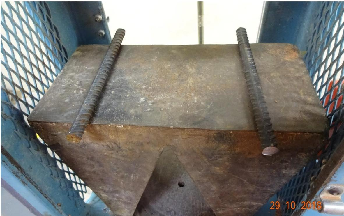
Fotografía 21: Ensayo a tracción apoyada en dos barras de aceros de 3/8.
