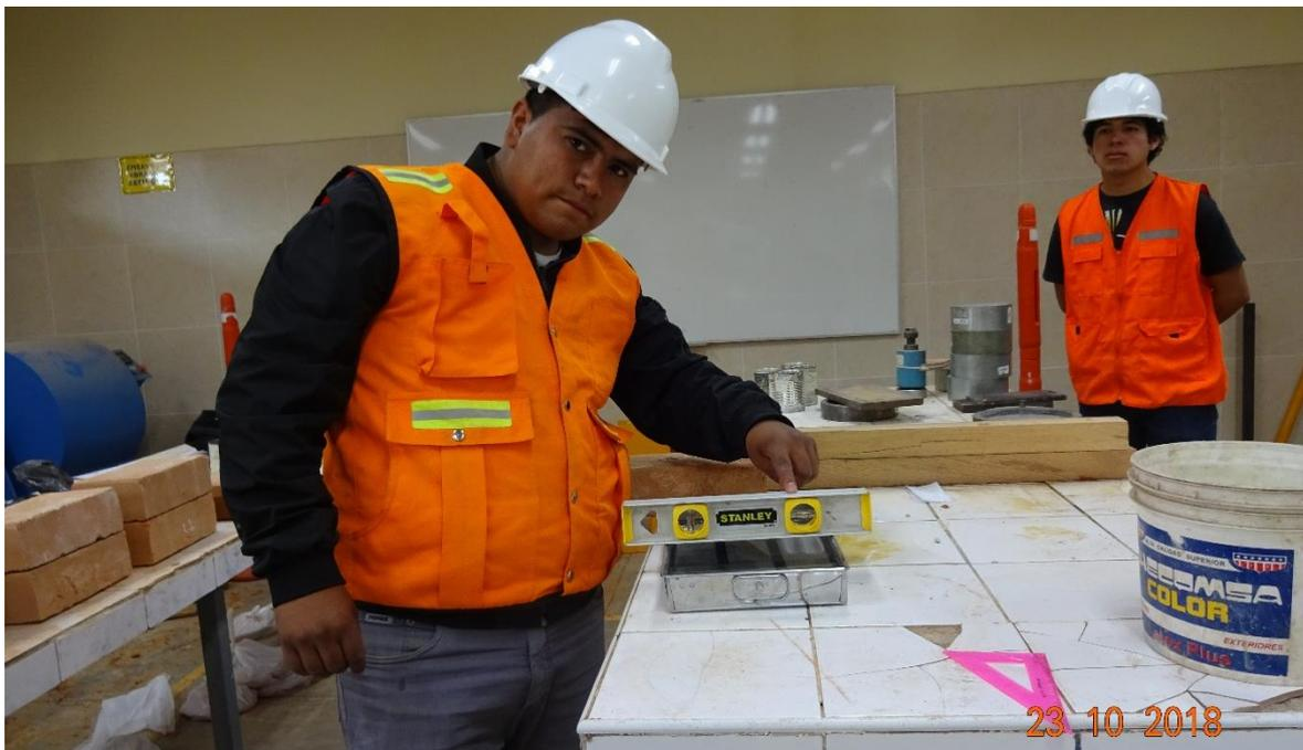
Fotografía 28: Se Utilizó un recipiente totalmente plano donde se coloca dos soportes de acero para el ladrillo y se niveló.
