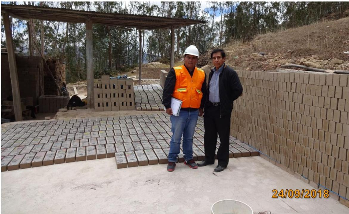
*Fotografía 4: Secado de ladrillos almacenados en un terreno espacioso y plano, cubierto con calaminas para protección de la lluvia.*
