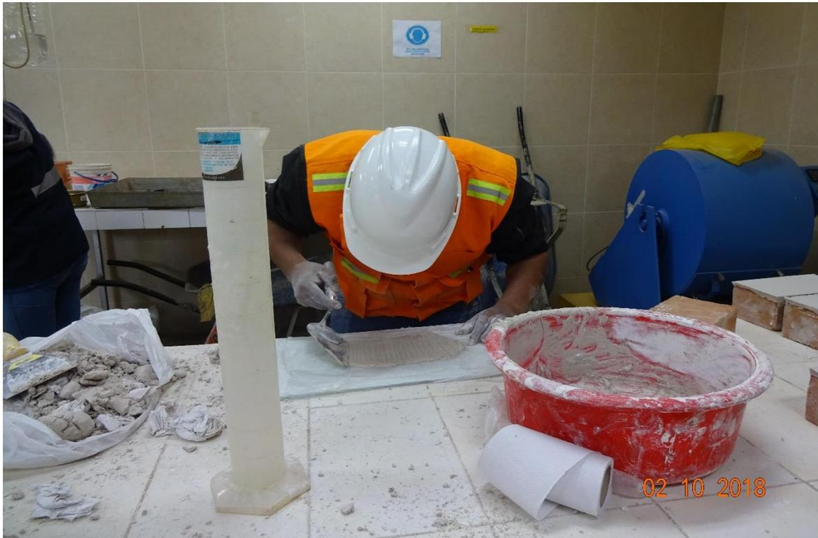
*Fotografía 13: Preparando la mezcla de las unidades de albañilería con yeso.*
