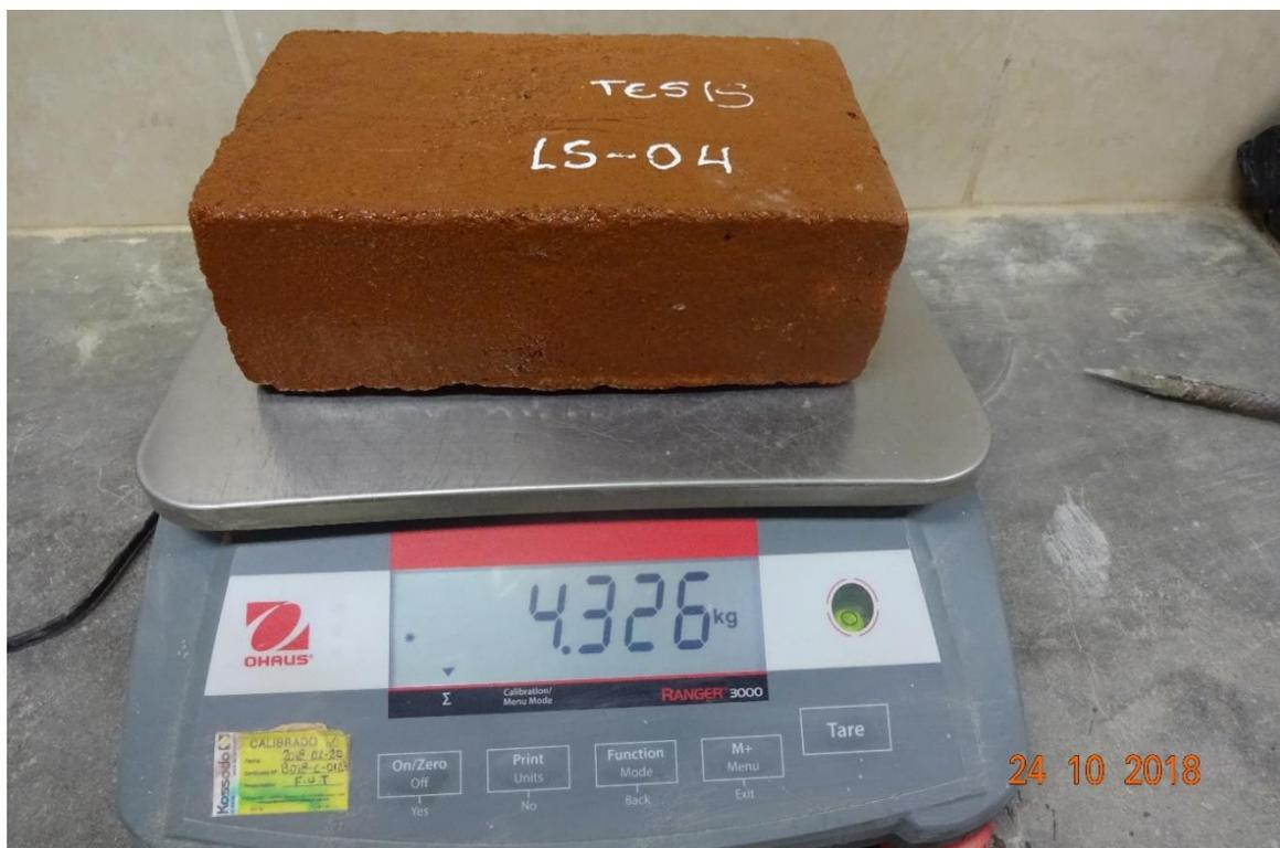
*Fotografía 26: Peso del espécimen saturado sumergido por 24 horas*
