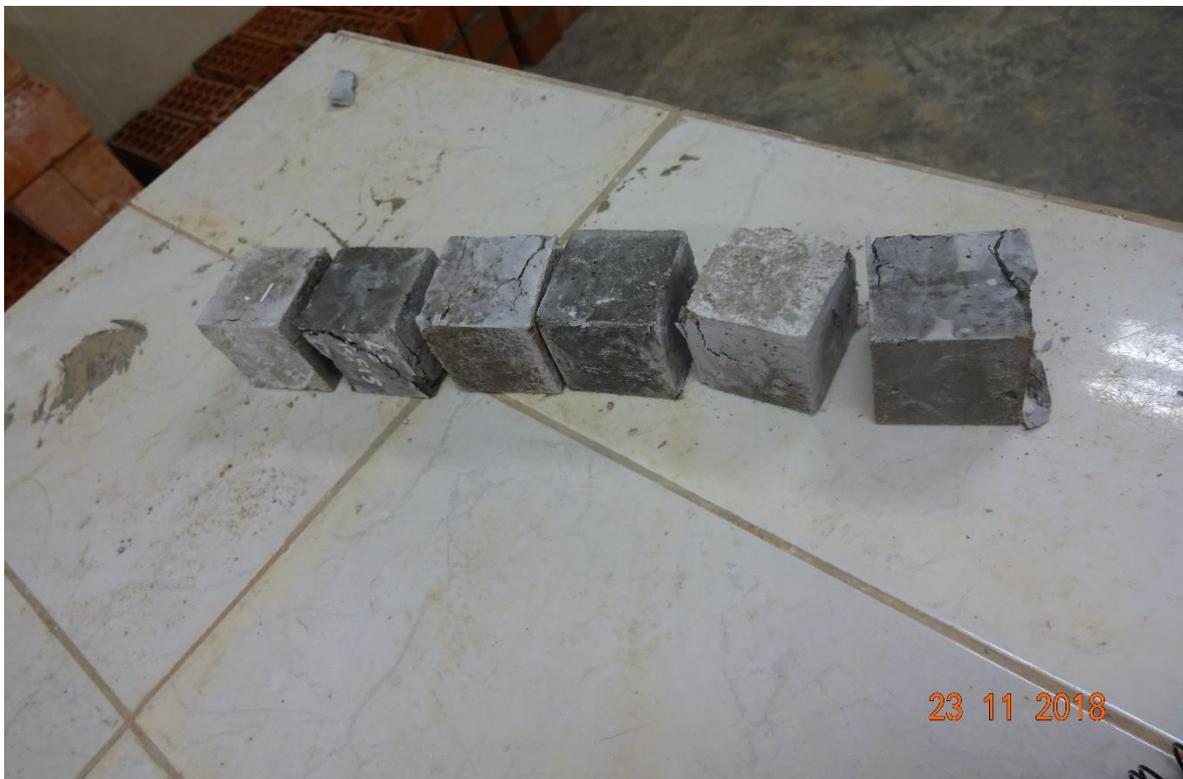
*Fotografía 52: Fallas de resistencia a compresión en cubos de mortero.*
