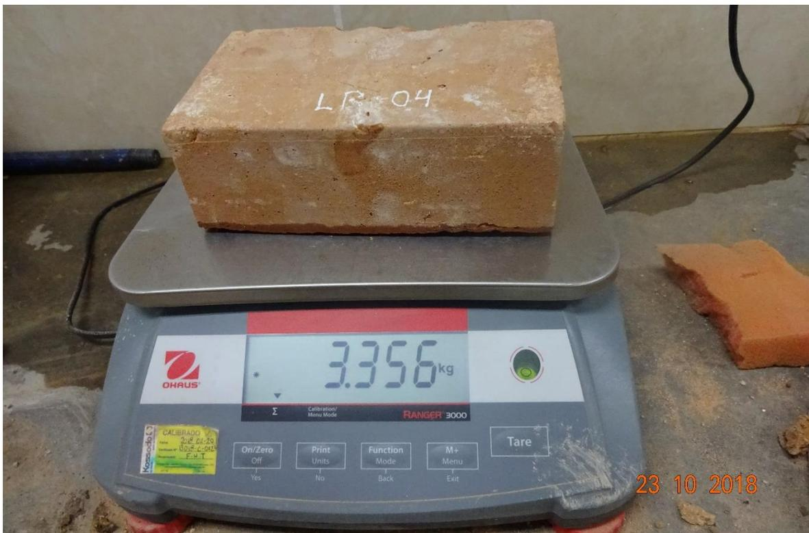
Fotografía 32: Tomamos los datos del peso de la muestra húmeda.
