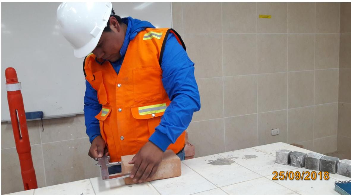
*Fotografía 10: Realizando la medida de altura con vernier de cada espécimen.*
