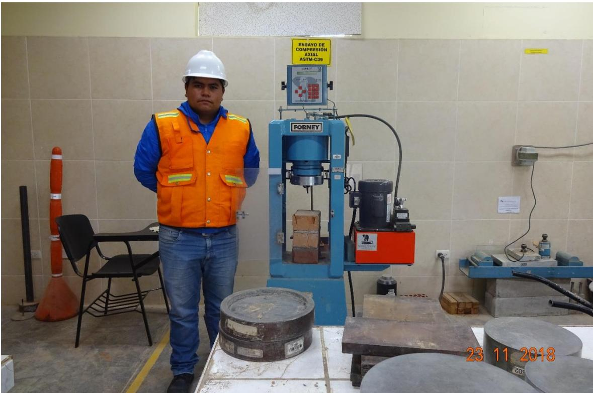
*Fotografía 45: Ensayo de resistencia a compresión de pilas.*
