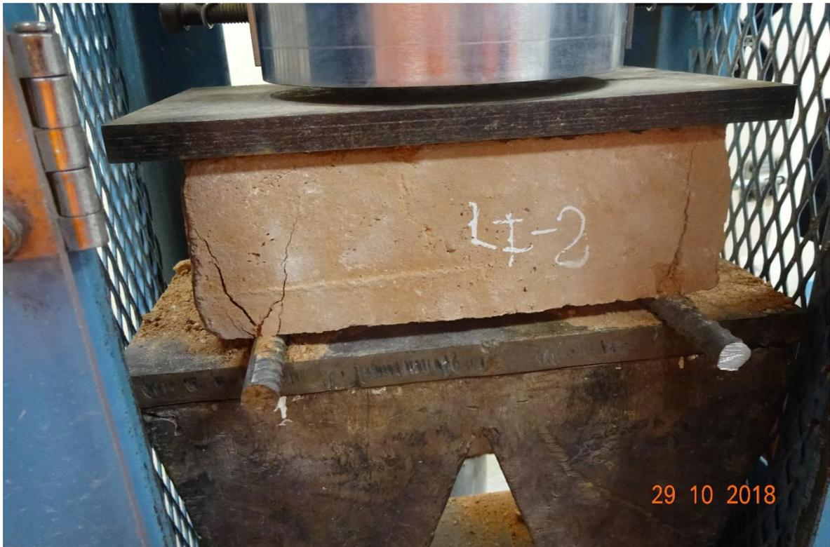
*Fotografía 23: Falla en ensayo a tracción de la ladrillera "Infante".*
