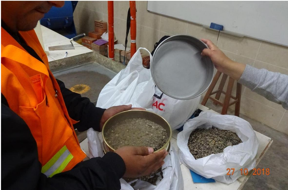
Fotografía 37: Tamizado de la arena gruesa en el tamiz N°4 para el mortero de las pilas.
