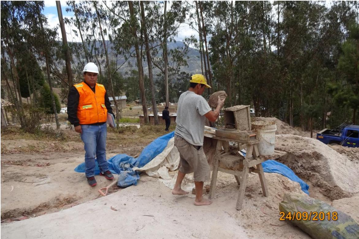
*Fotografía 3: Moldeo y labranza del ladrillo.*
