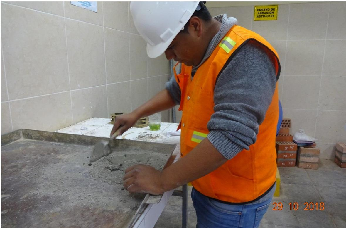
*Fotografía 49: Mezcla de mortero para cubitos, cemento, cal y arena gruesa.*
