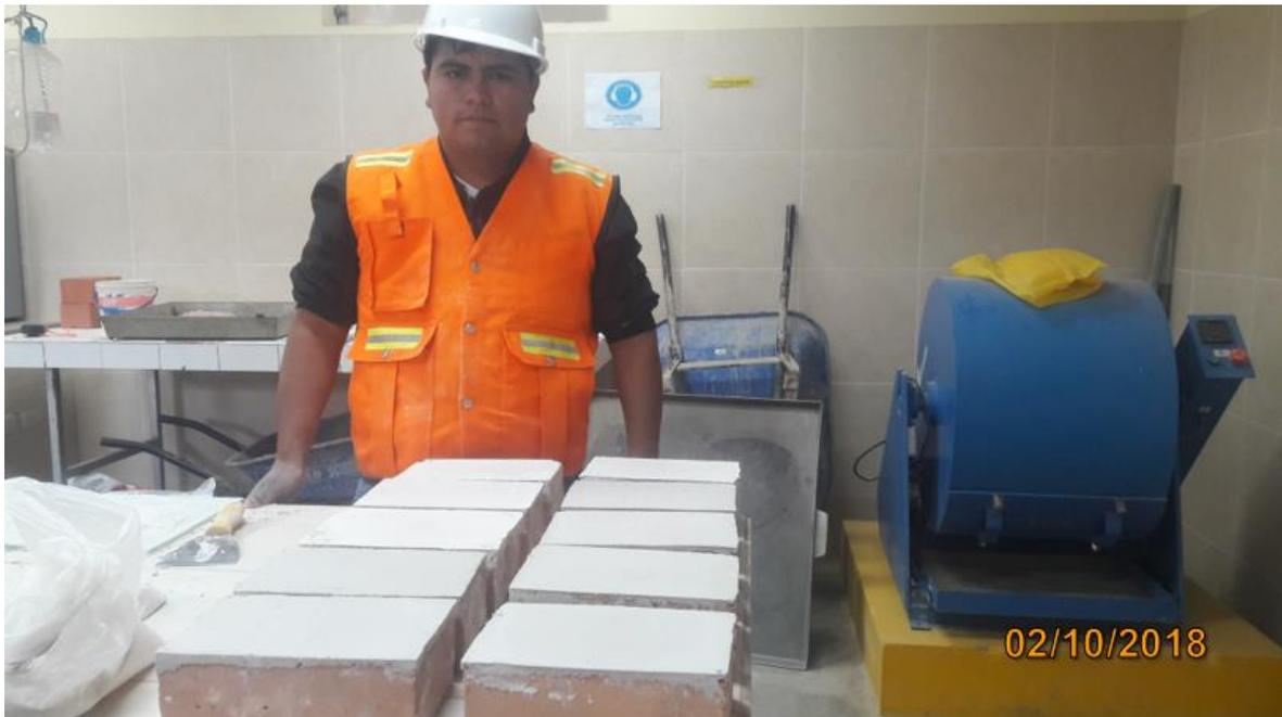
*Fotografía 15: Enrasado terminado de las unidades de albañilería con yeso.*
