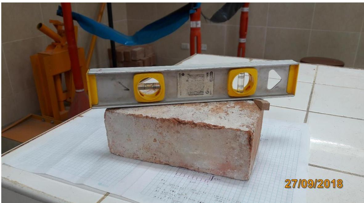
*Fotografía 12: Utilizando el nivel de carpintero para obtener el resultado convexo*
