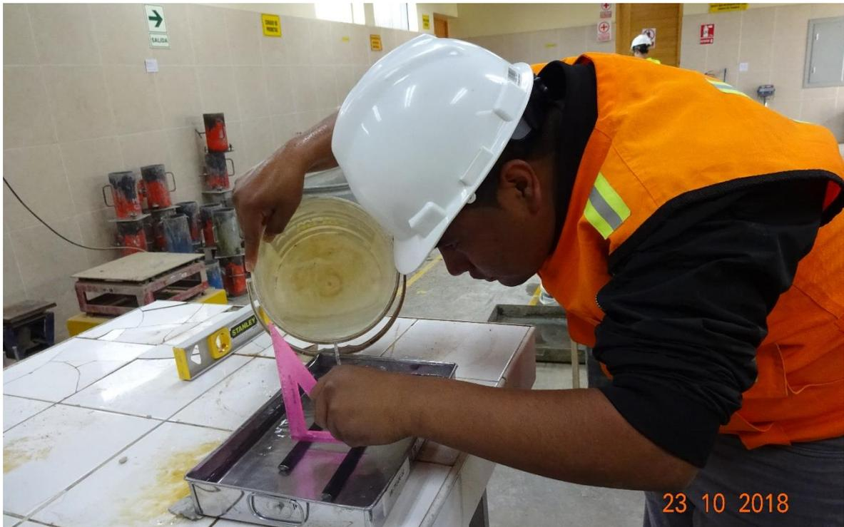
*Fotografía 29: Se adicionó agua al recipiente con una precisión de 3mm sobre los apoyos.*
