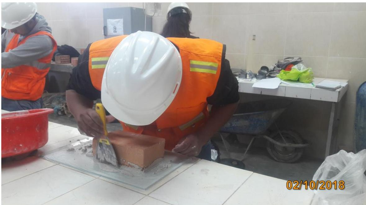
*Fotografía 14: Enrasado de las unidades de albañilería con yeso.*
