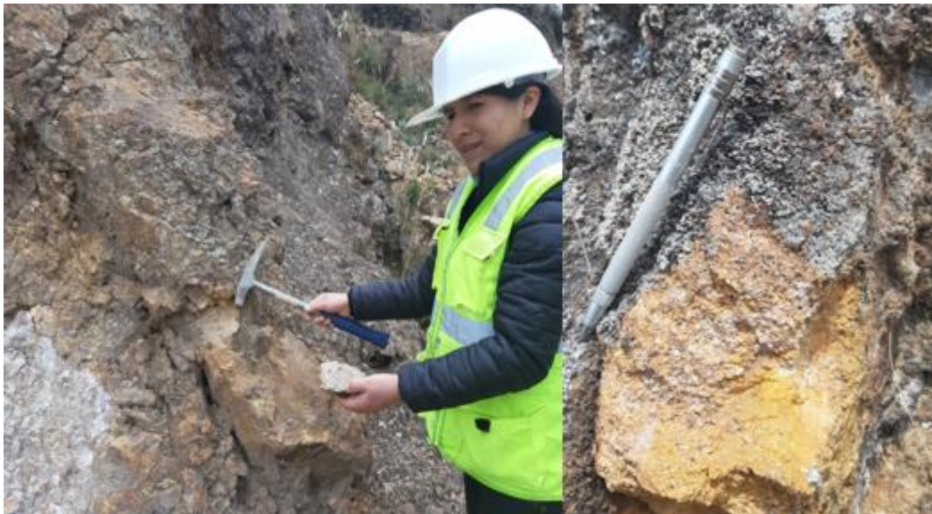
Foto 6. Toma de muestras de mano de las rocas que afloran en la zona para luego realizar una clasificación macroscópica e identificar el tipo de litología. Ubicación (E:765553 N:9252030).
