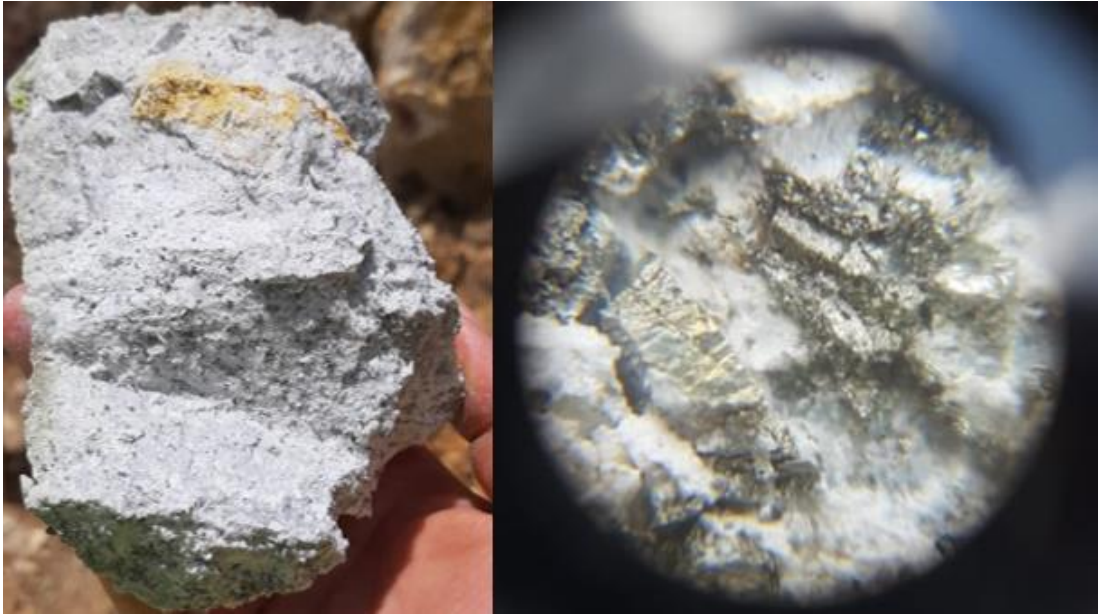
Foto 2. A la izquierda se observa una muestra de mano de roca de composición dacítica con un 70% de plagioclasas, 20% de cuarzo y un 10% de feldespatos según el análisis macroscópico además de minerales máficos de hornblenda y biotita. A la derecha se observa la muestra vista a la lupa de 30x donde se observa cristales de pirita ( \text{FeS}_2 ). Ubicación (E:765460; N:9251901).
