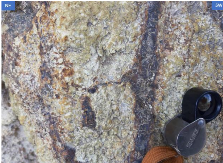
Foto 3. Afloramiento de roca de composición dacítica, donde se observa que los cristales están sufriendo un proceso de Oxidación y Argilización, que son características de un yacimiento de alta sulfuración. Ubicación (E:765697 N:9252079).
