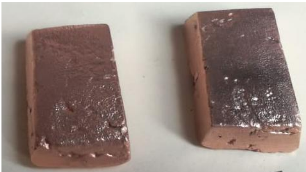
Figura 19. Muestras de cobre de 300 gr. Resultantes del reciclaje de cobre en el horno de crisol estacionario diseñado y construido.
