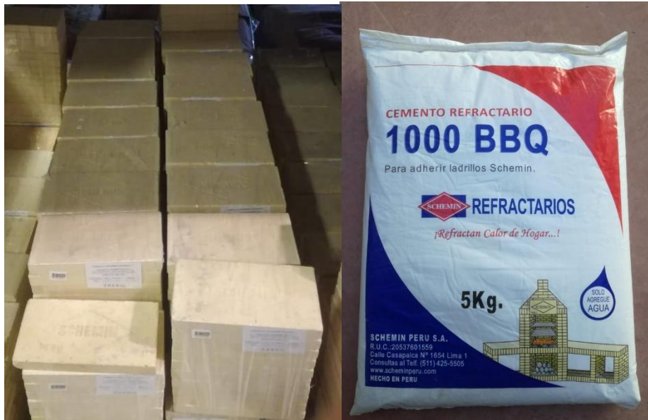
Figura 16. Ladrillos y Cemento refractario empleados para la construcción. Los materiales refractarios son elaborados por la empresa SCHEMIN PERU S.A. y fueron elegidos principalmente a su gran capacidad para soportar temperaturas sobre los 1000 grados centígrados y a su fácil adquisición en el mercado local debido a su presencia en distintas ferreterías y grandes tiendas por departamento como PROMART y SODIMAC.
