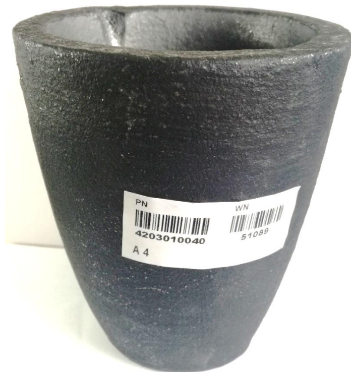
Figura 17. Crisol de Grafito tamaño A4 que soporta una temperatura máxima de 1400°C. El crisol se ha seleccionado tomando en cuenta los parámetros de diseños previamente descritos como la cantidad del metal a fundir y la necesidad de que este no reaccione con el metal, los fundentes y desgasificadores. Se eligieron los crisoles de Grafito por ser neutros y no reaccionan con el aluminio ni el cobre.
