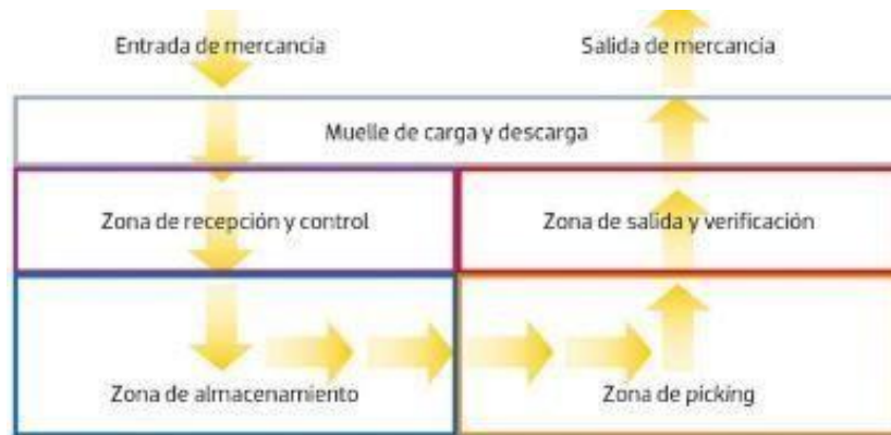
Figura n.º 1.10: Diseño de una distribución de planta en forma de "U".
