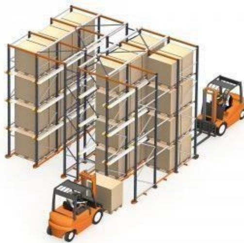
Figura n.º 1.14: Esquema de estantería Drive - Thought
