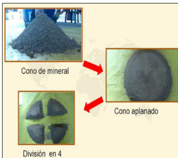
Figura 6. Homogenizado y cuarteo del mineral
