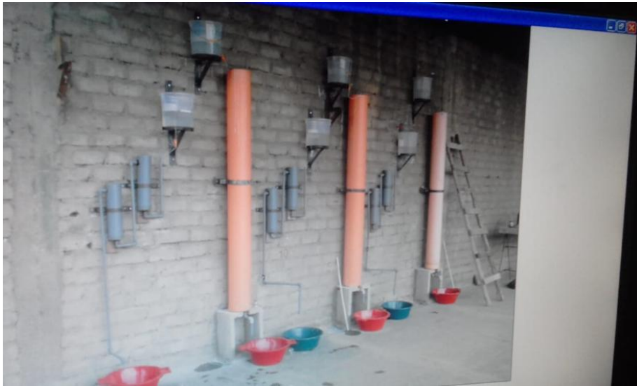
Equipos de columnas de lixiviación
