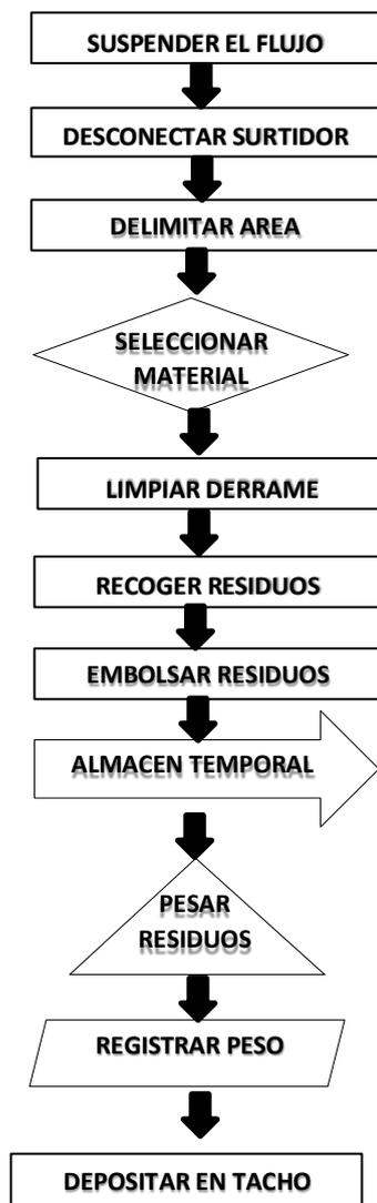
Figura 31. Procedimiento Contención de derrames de combustible
