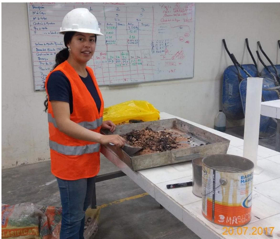
**Figura 23:** Preparación del material para ensayo de compactación.
