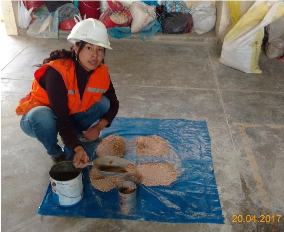
*Figura 21:* Cuarteo del material para ensayo granulométrico.
