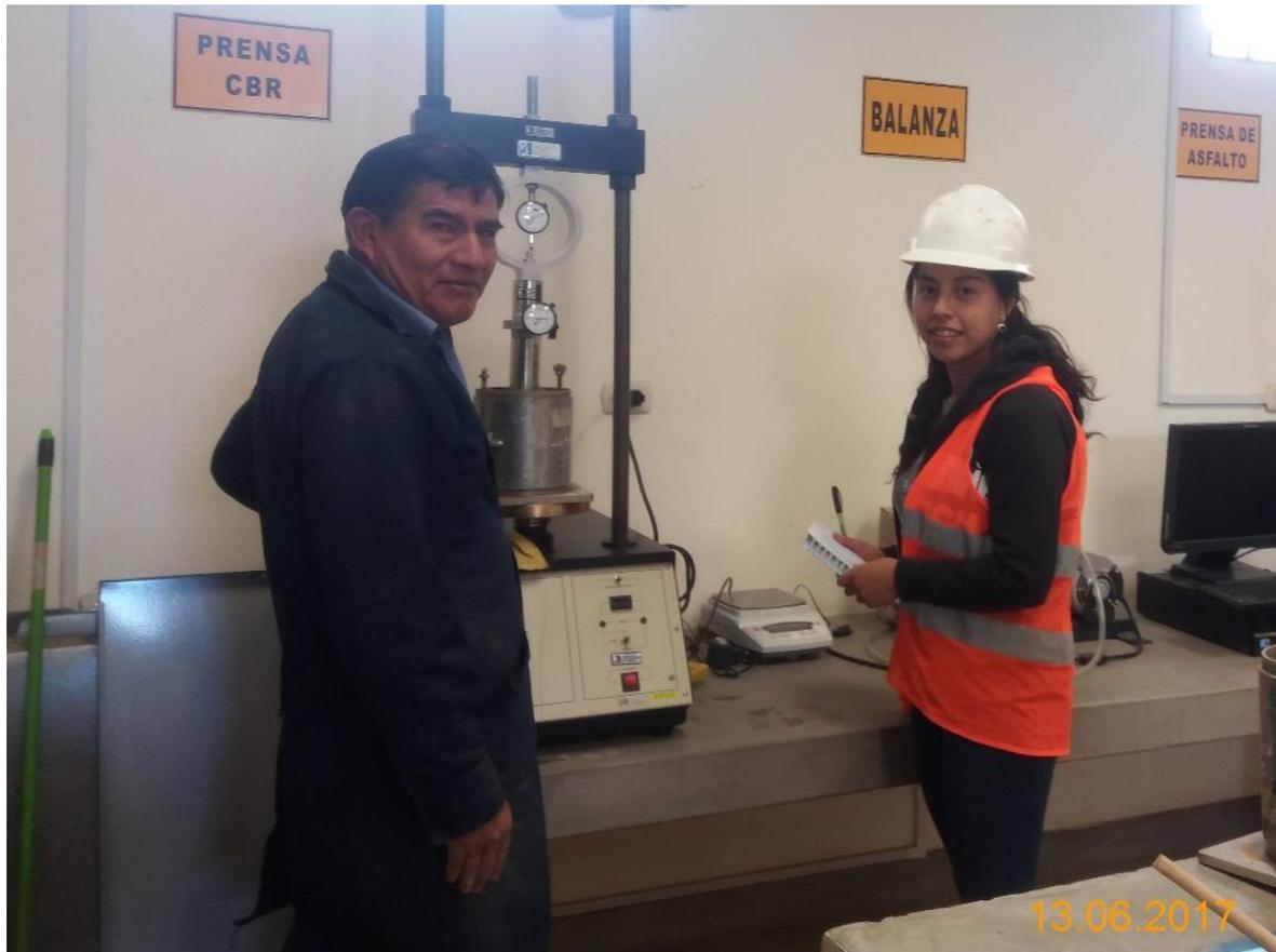
*Figura 26:* Ensayo de CBR.
