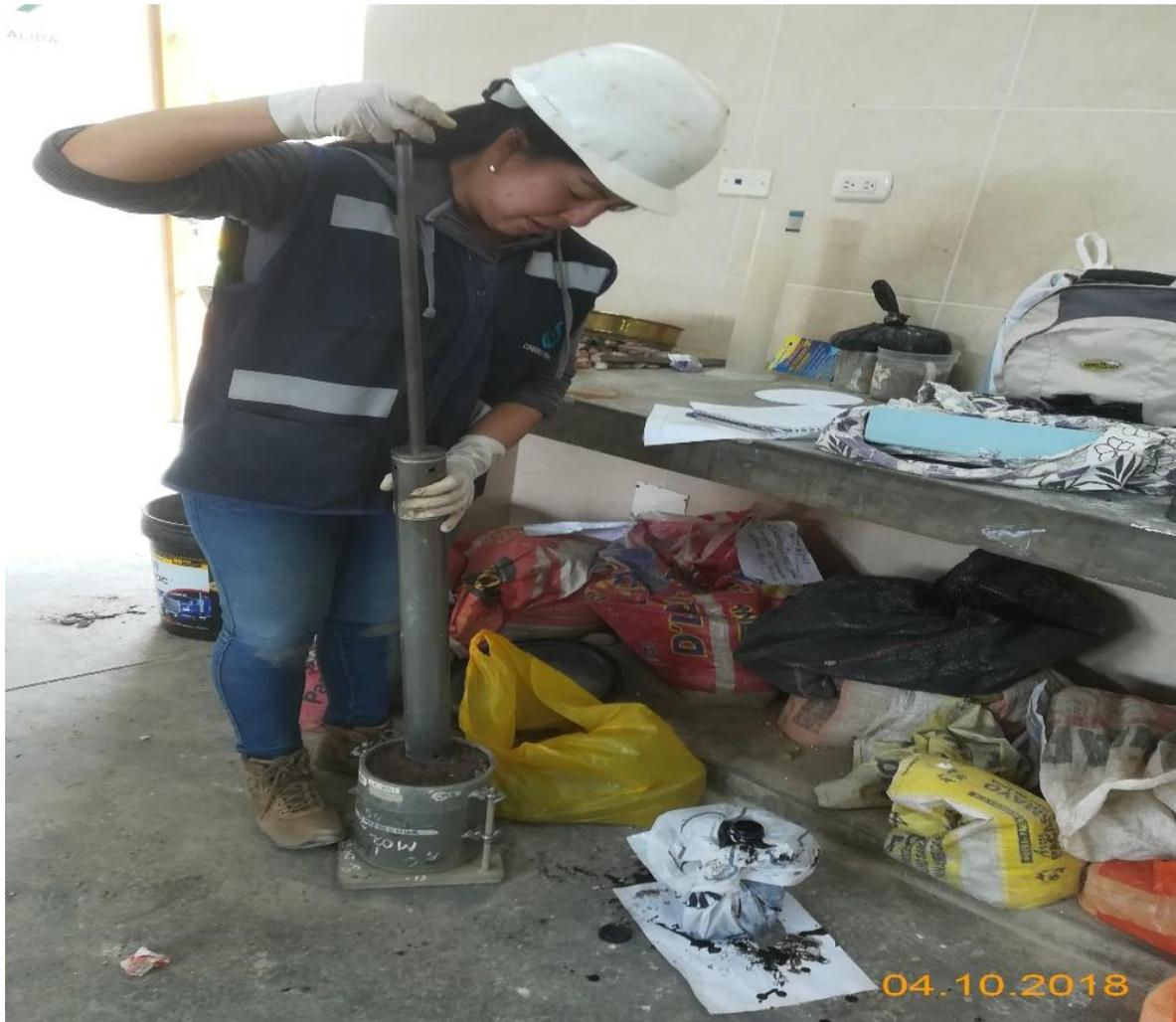
*Figura 24:* Ensayo de compactación.
