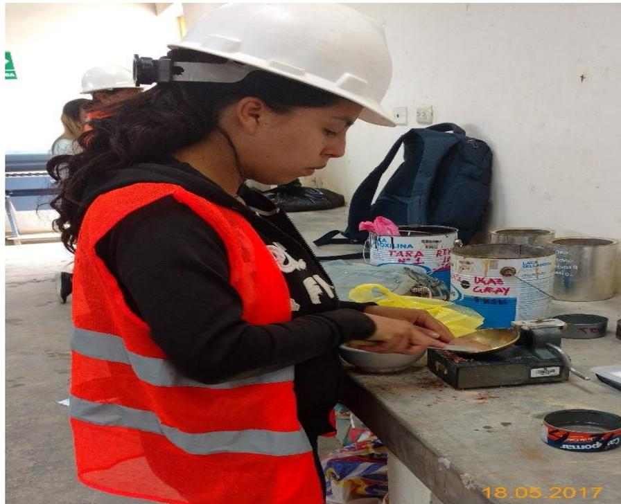
*Figura 14:* Determinación del límite plástico e índice de plasticidad.
