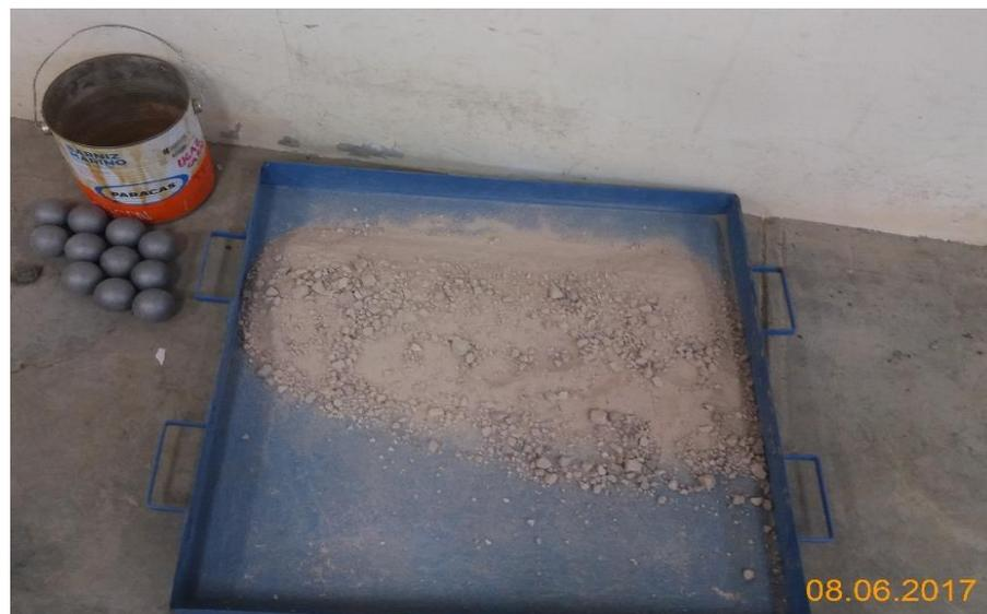
*Figura 15:* Ensayo de Abrasión Los Ángeles
