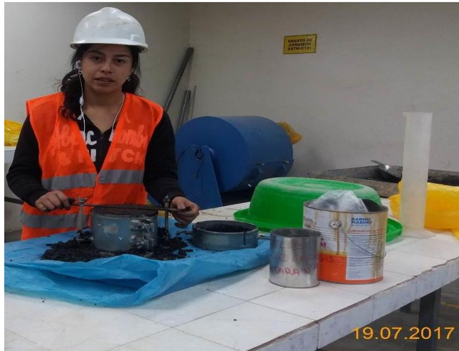
*Figura 16:* Compactación del suelo usando la energía modificada.
