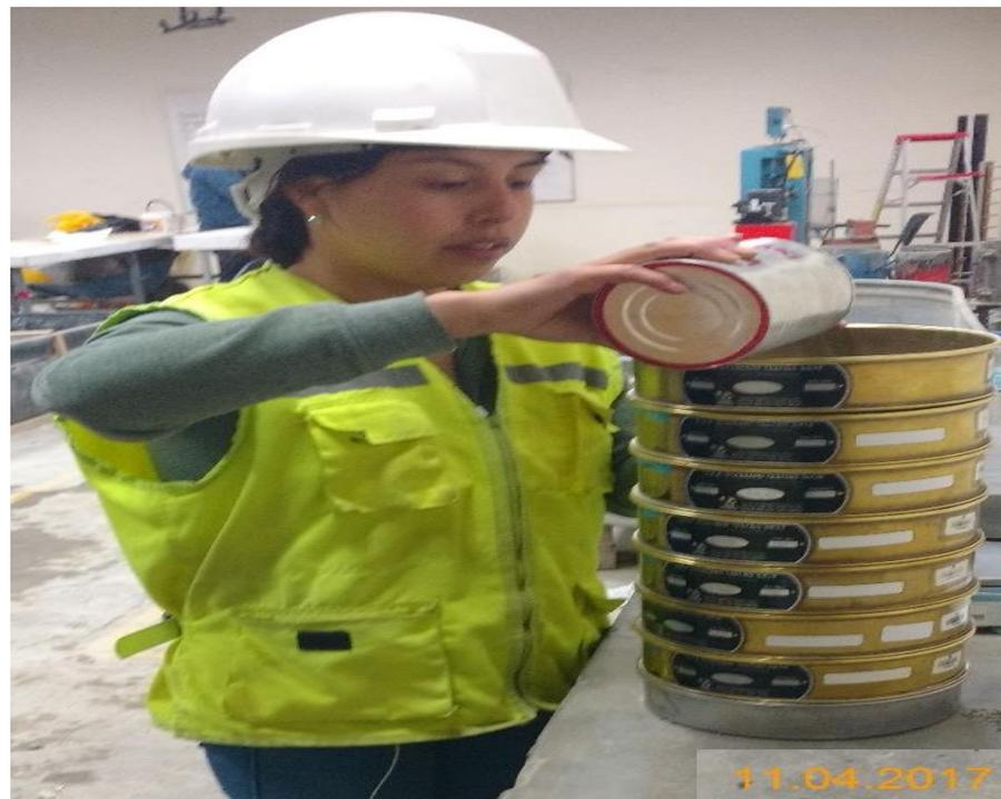
*Figura 13:* Tamizado del material.
