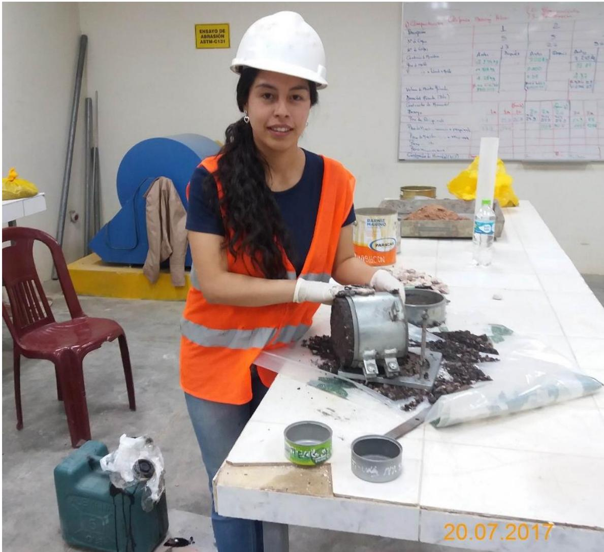
*Figura 25:* Extracción de muestras del material compactado en molde.
