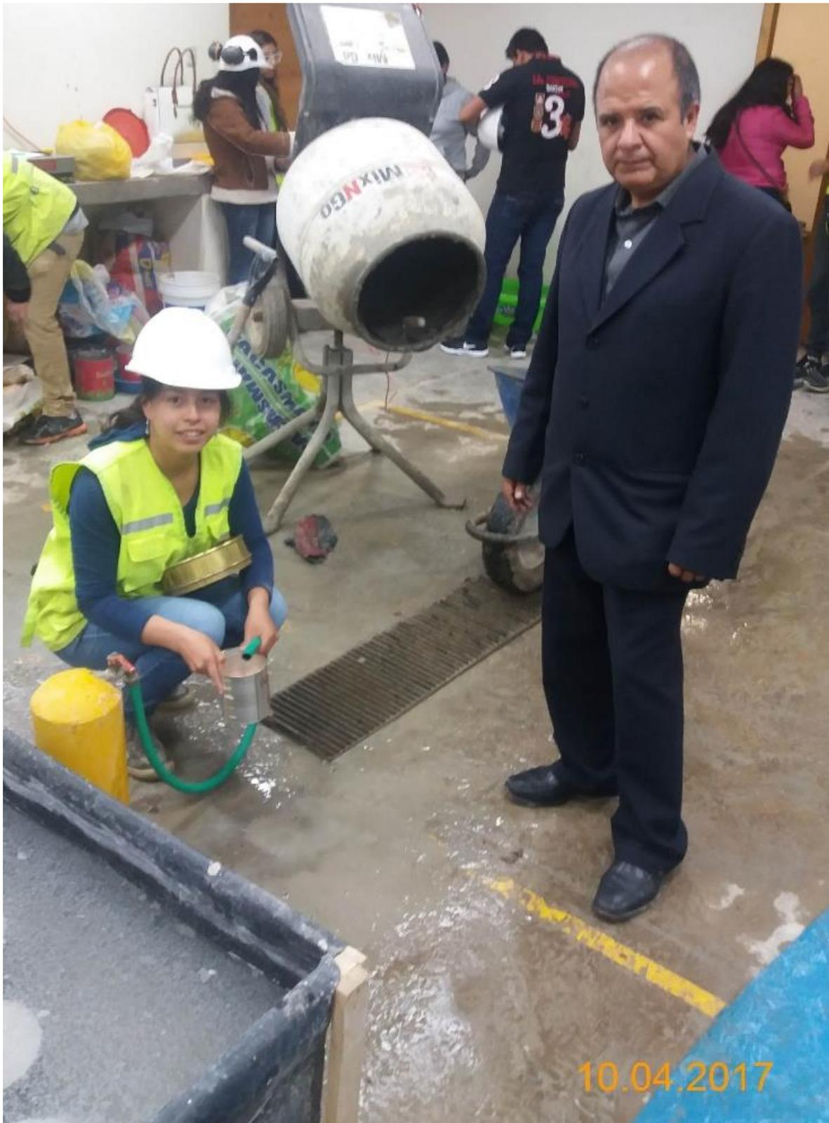
*Figura 22:* Lavado de material para ensayo granulométrico.
