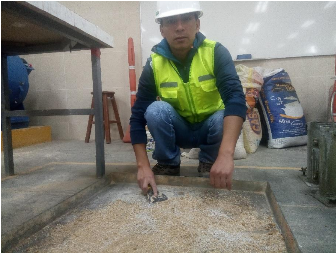
Fotografía 10. Preparación de material con adición para próctor.
