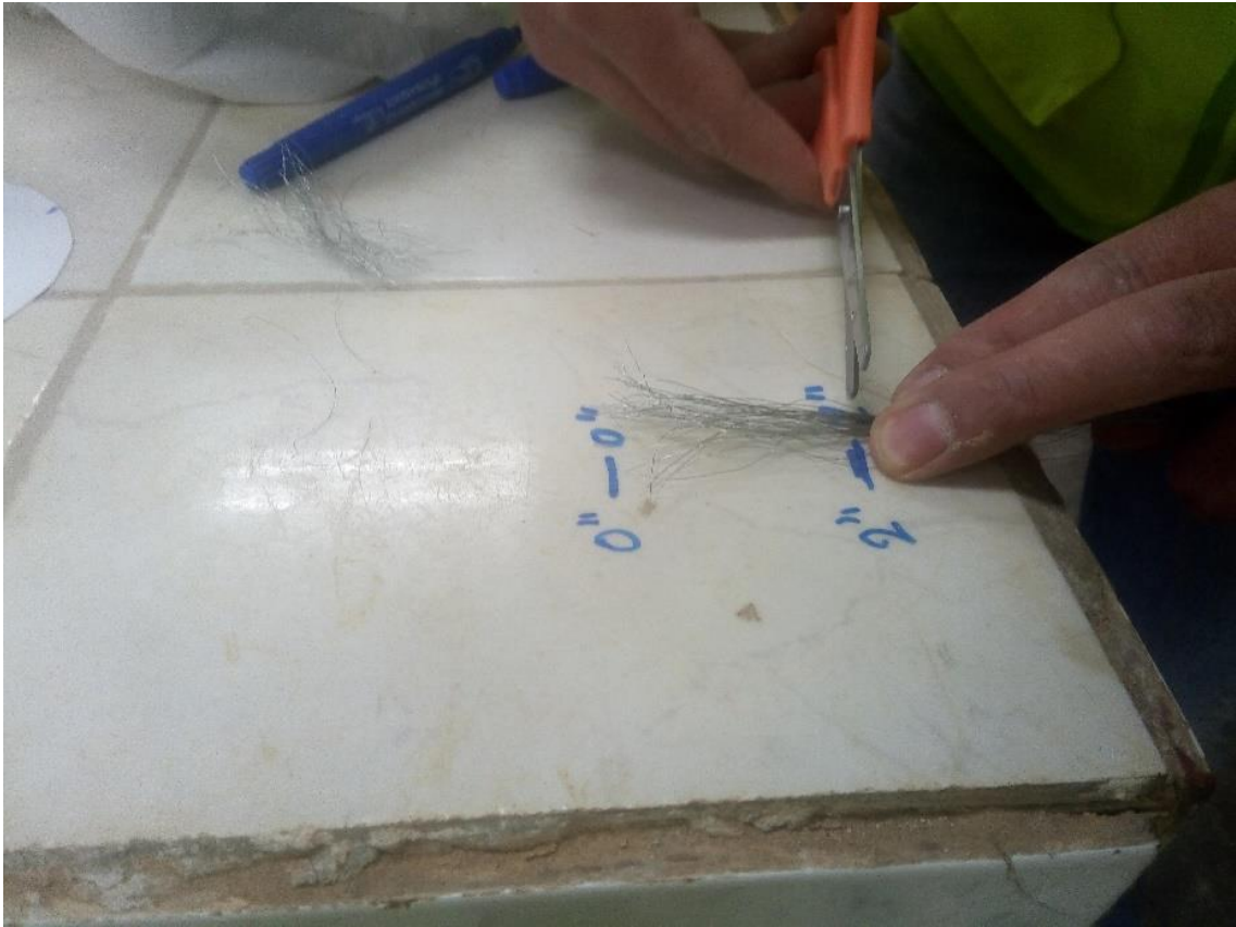
Fotografía 11. Preparación de adición filamentos de malla.
