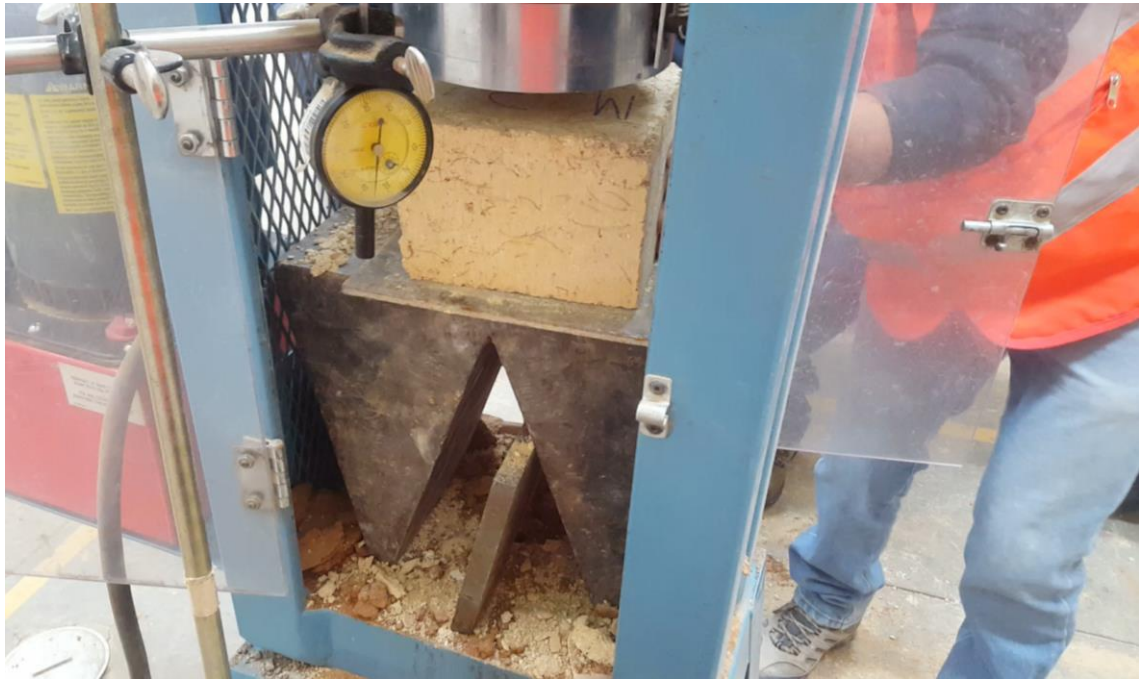
Fotografía 16. Ensayo a compresión de adobes.
