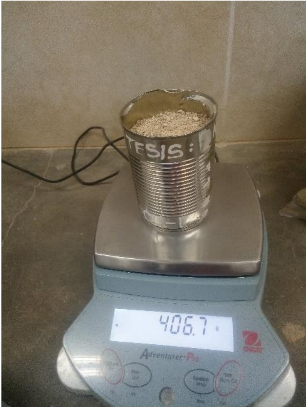
Fotografía 6. Contenido de humedad.
