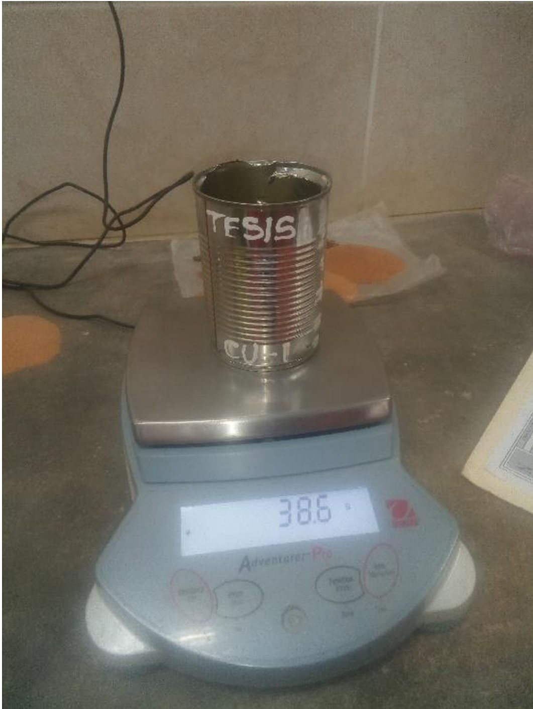
Fotografía 4. Contenido de humedad.
