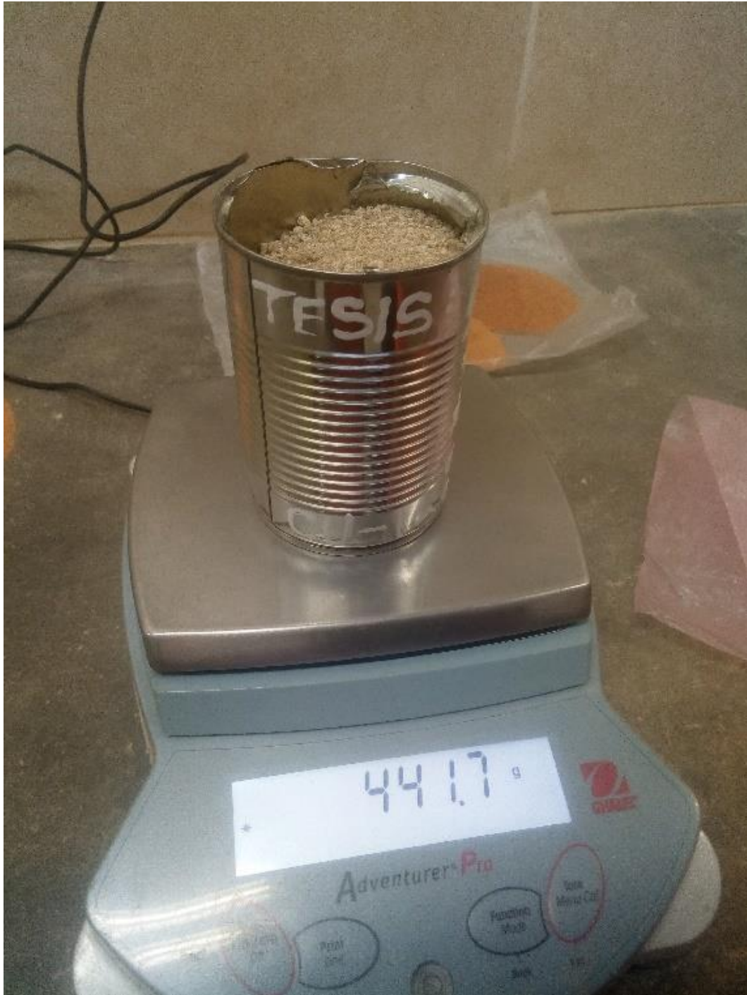
Fotografía 5. Contenido de humedad.
