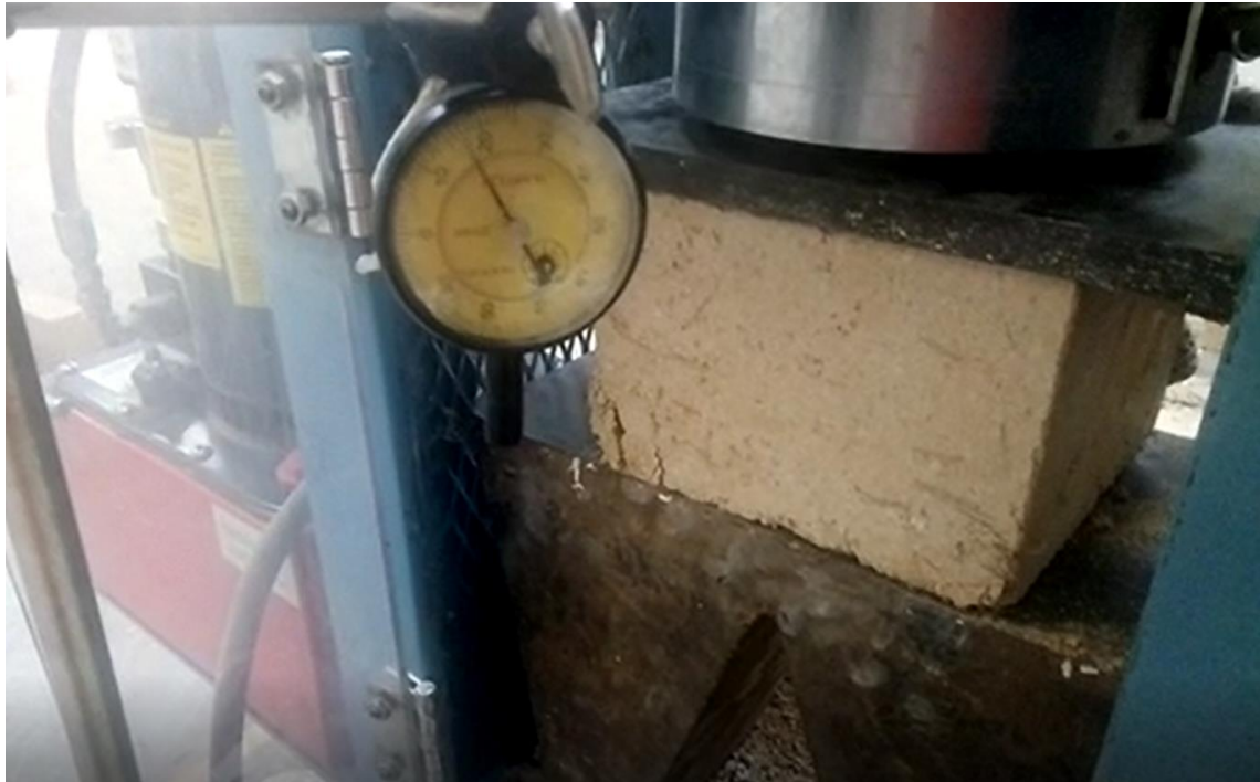
Fotografía 17. Ensayo a compresión de adobes.
