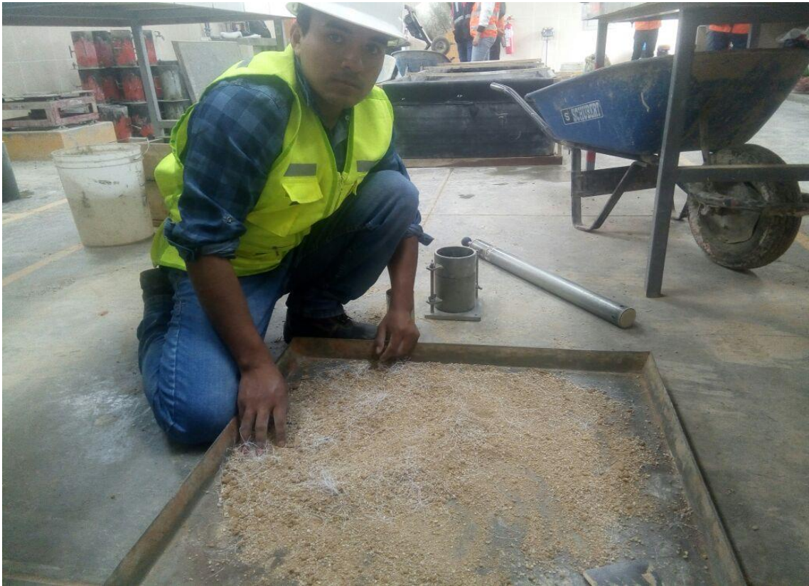
Figura 29 Mezclando la muestra para realizar Proctor
