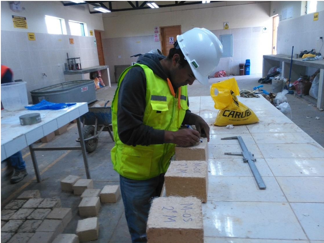
Figura 36 Marcando los bloques de adobe para su identificación, para someterlo a compresión.
