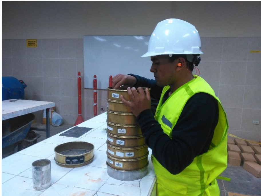
Figura 9 Realizando la granulometría del material lavado después de secarse en el horno
