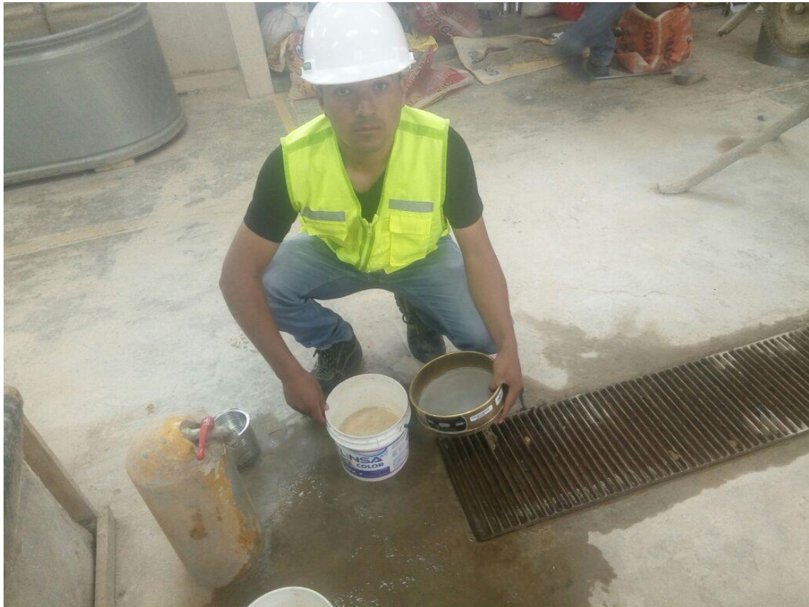
Figura 26 Realizando el lavado del material seco con la malla N° 200
