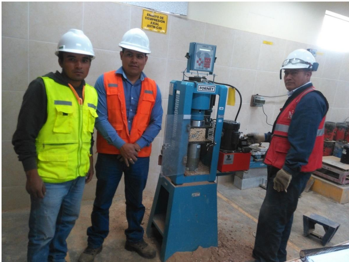
Figura 38 Ensayo a compresión del bloque de adobe en mitades, en presencia de mis asesor de tesis
