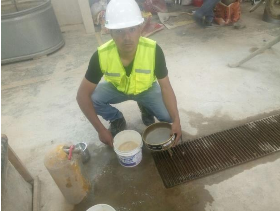
Figura 7 Realizando la granulometría método de lavado
