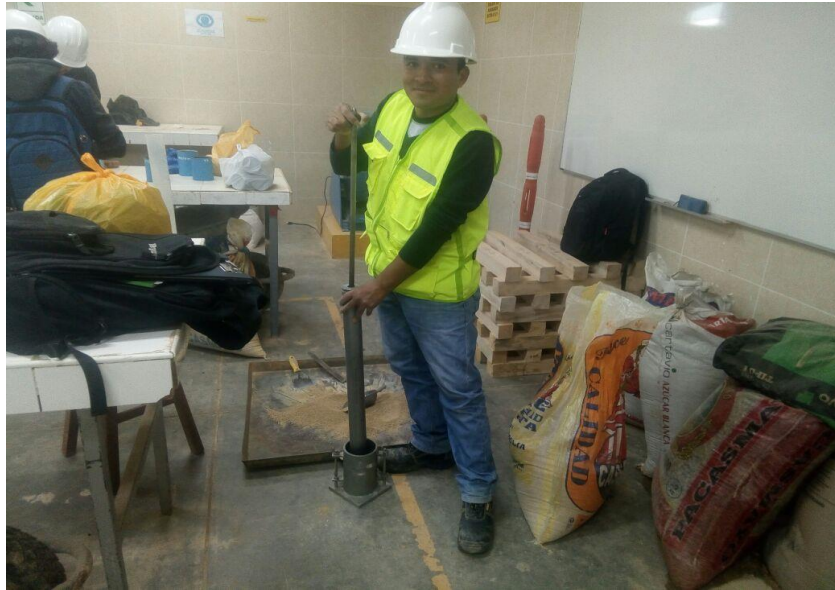
Figura 14 Compactación proctor modificado
