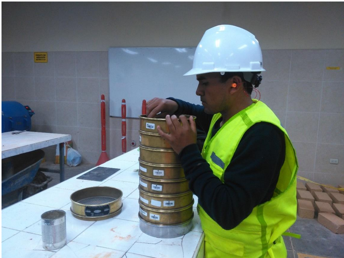
Figura 27 Realizando la granulometría del material lavado después de secar al horno
