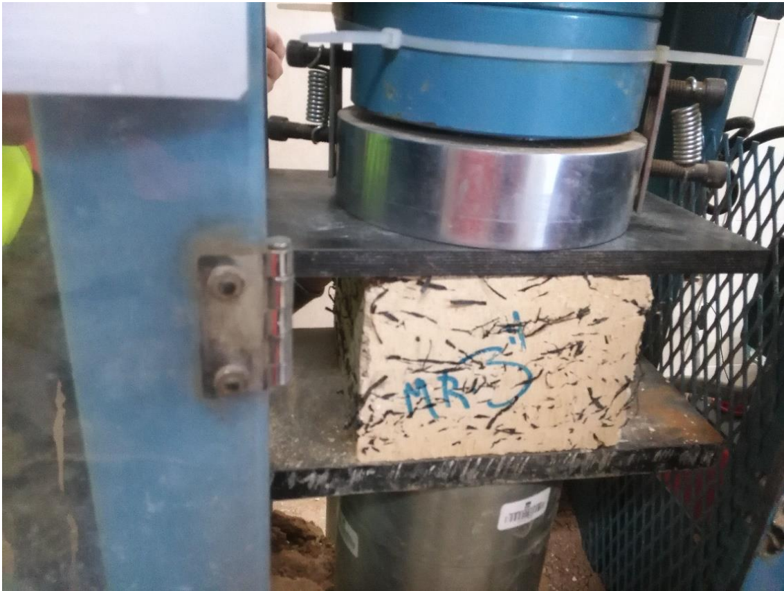
Figura 37 Ensayo de muestra a compresión en mitades con filamentos de malla raschel con 3” de longitud.
