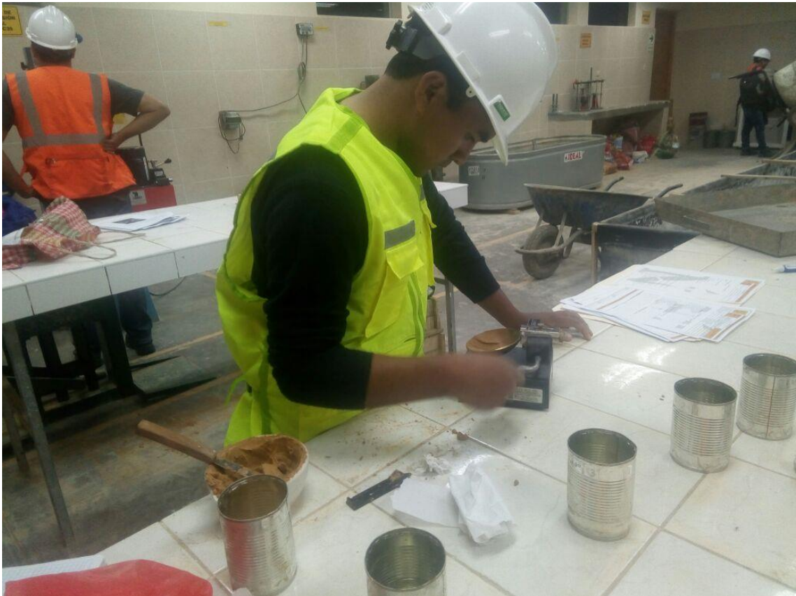
Figura 28 Realizando el límite líquido y plástico.
