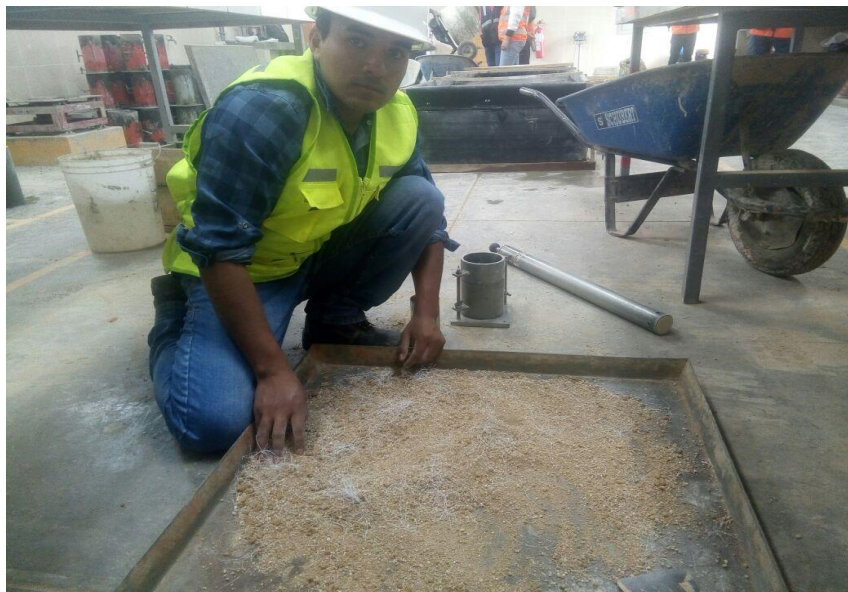
Figura 13 Mesclando el material con el porcentaje adecuado
