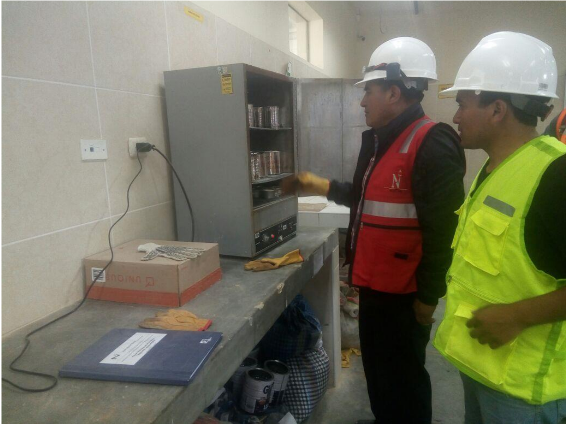
Figura 25 Muestra secada al horno para contenido de humedad durante 24 horas
