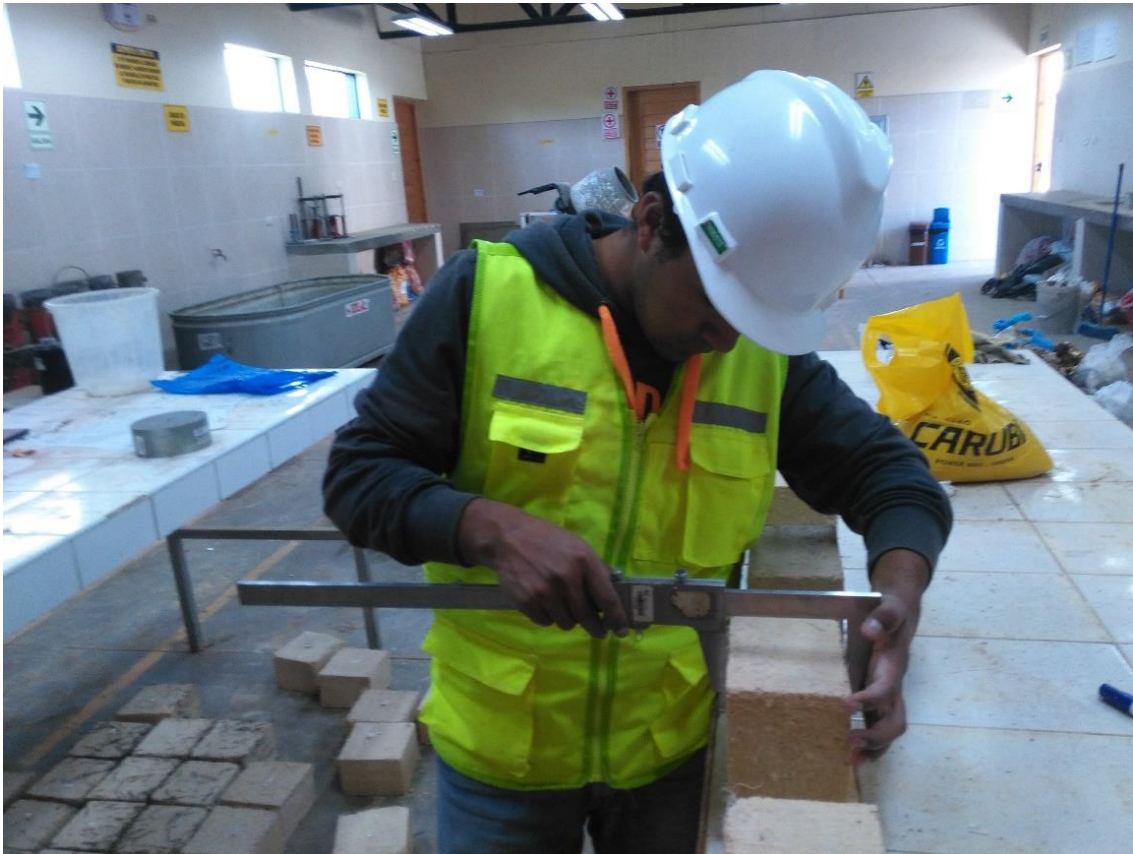
Figura 35 Sacando medidas exactas con el vernier de los bloques de adobe
