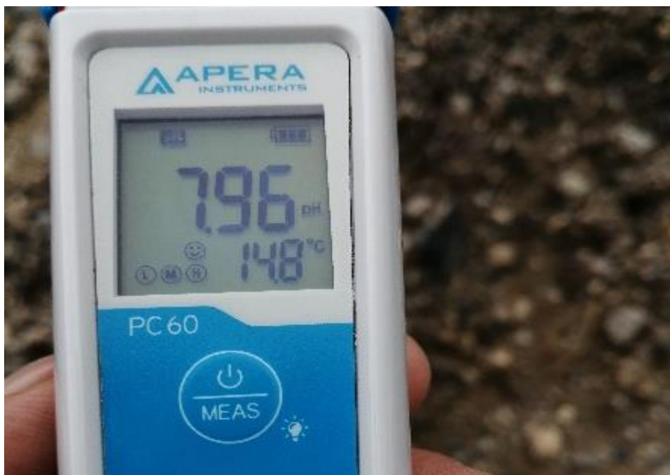
Foto 6. Medición del pH, en 200 mts. Aguas arriba con equipo Multiparámetro.
