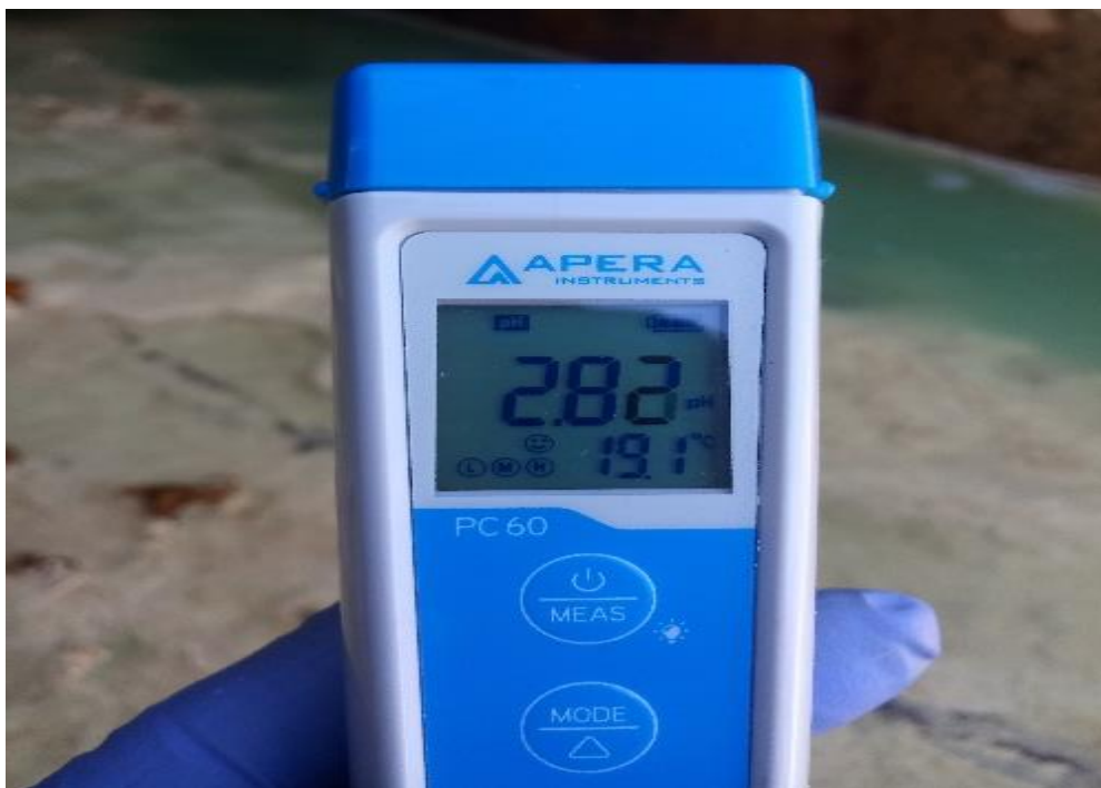
Foto 4. Medición del pH, en boca mina con equipo Multiparámetro.
