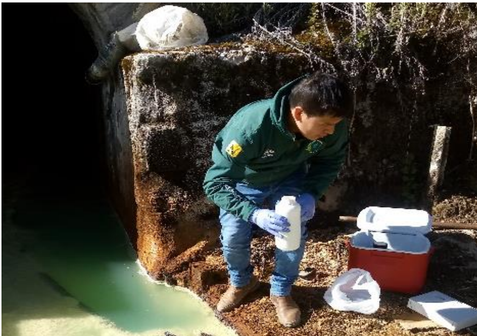
Foto 8. Toma de muestra en el drenaje ácido del Socavón Prosperidad.
