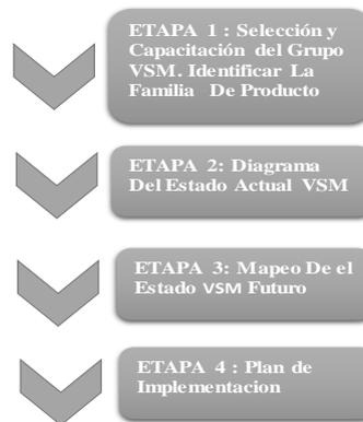
*Figura 8.* Procedimiento de Value Stream Mapping (VSM)
