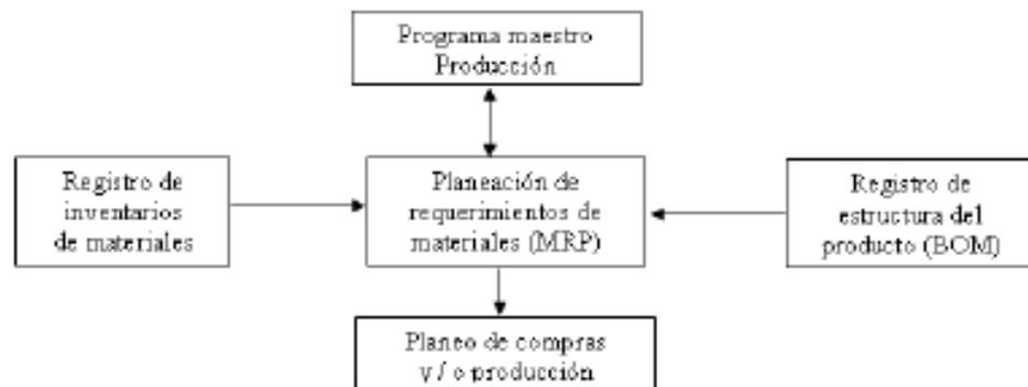
**Figura 5.** Sistema de planeación de requerimiento de materiales
