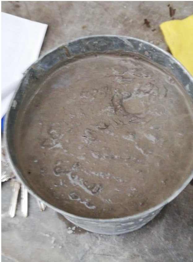
Figura 39 Molde con la cantidad adecuada de mortero de concreto
