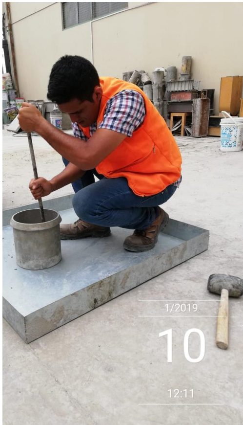
Figura 33 Compactado del agregado grueso para el ensayo de peso unitario
