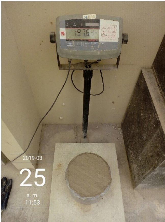
Figura 37 Peso del concreto fresco, muestra Z al 2.0 %
