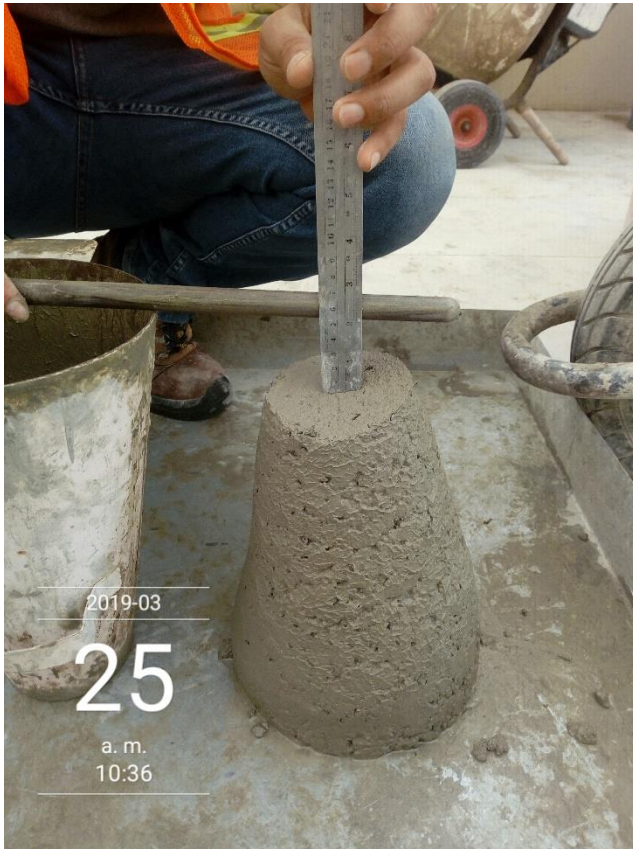
Figura 35 Asentamiento del concreto fresco, muestra Sika al 2.0 %
