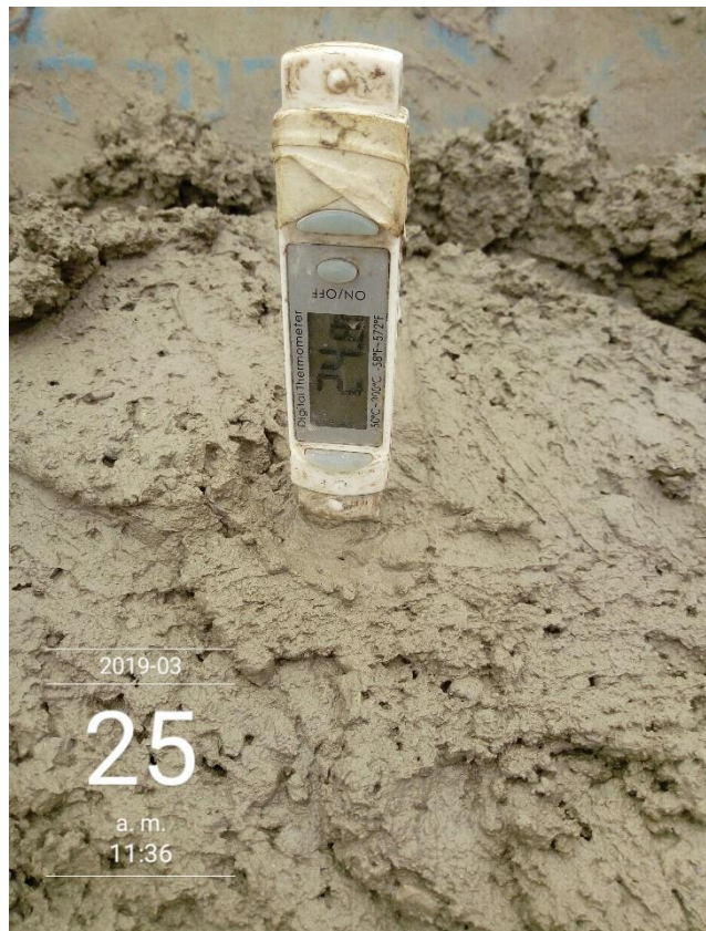
Figura 36 Temperatura del concreto fresco, muestra Sika al 2.0 %
