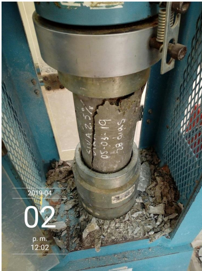
Figura 47 Tipo de falla del testigo de concreto, muestra Sika al 2.5 %
