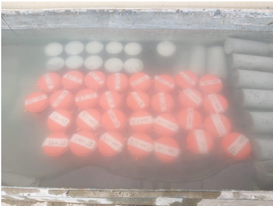
Figura 44 Consideración especial, los moldes plásticos sumergidos en agua
