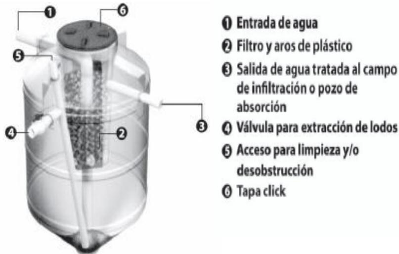
*Componentes del Biodigestor*
