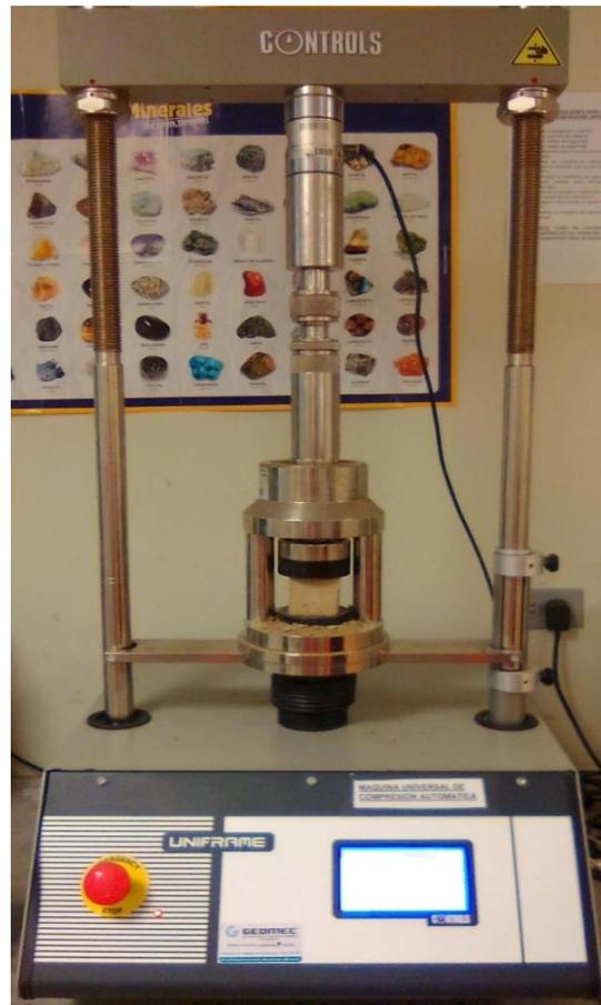
Figura 38: Máquina de ensayos universal CONTROLS: Ensayo de compresión
