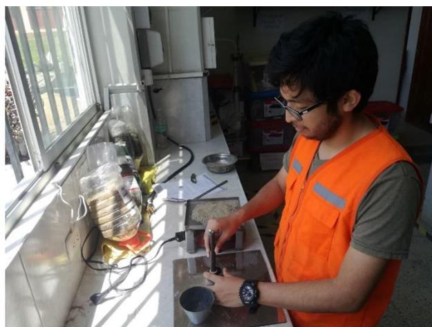
Figura 45: Llenado del cono por 3 capas, ensayo del peso específico
