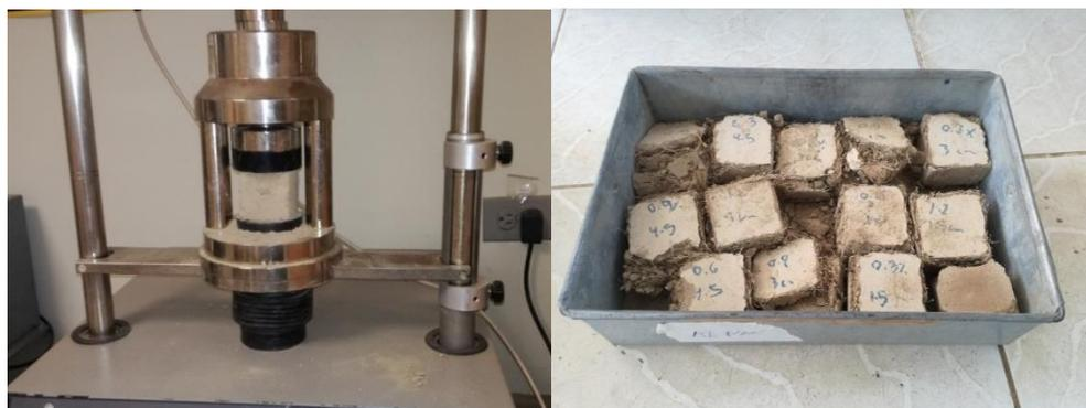
Figura 39: Probeta con fibra natural ensaya a compresión
