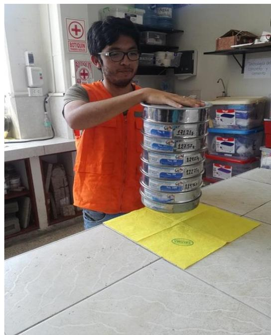
Figura 42: Ensayo granulométrico de la materia prima (suelos finos, arena gruesa y cal)
