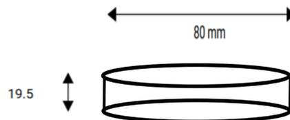
Figura 14: Probeta para la contracción volumétrica
