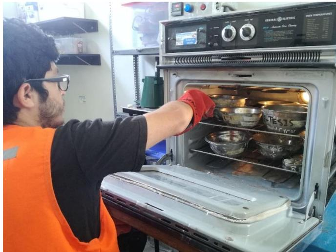
Figura 44: Ensayo de porcentaje de humedad a una temperatura de 110°C
