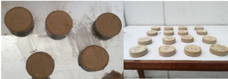
Figura 40: Conformación de probetas cilíndricas para el ensayo de contracción
