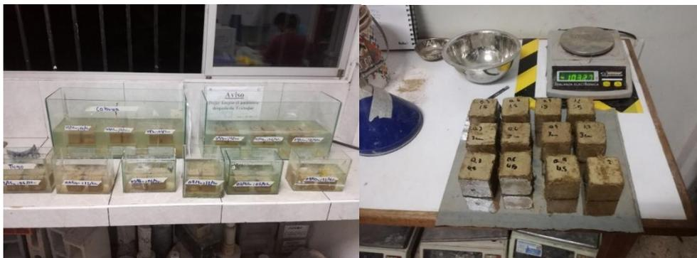
Figura 41: Probetas sumergidas en agua durante 2 días
