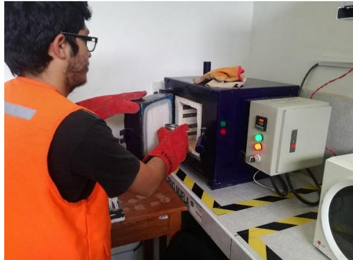
Figura 43: Ensayo de materia orgánica a una temperatura de 450°C
