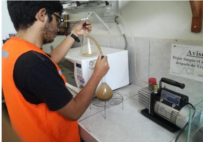
Figura 47: Extracción del aire de la muestra para el ensayo de gravedad específica
