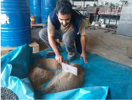
Figura 52 Cuarteo de agregado fino
