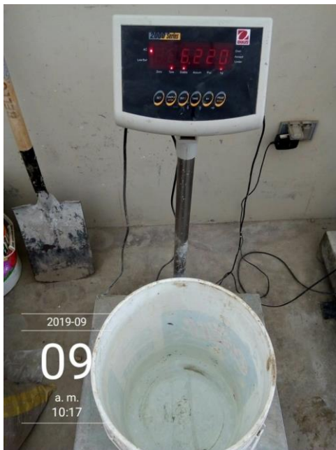
Figura 57 Control de peso de agua de acuerdo con el diseño de mezcla establecido
