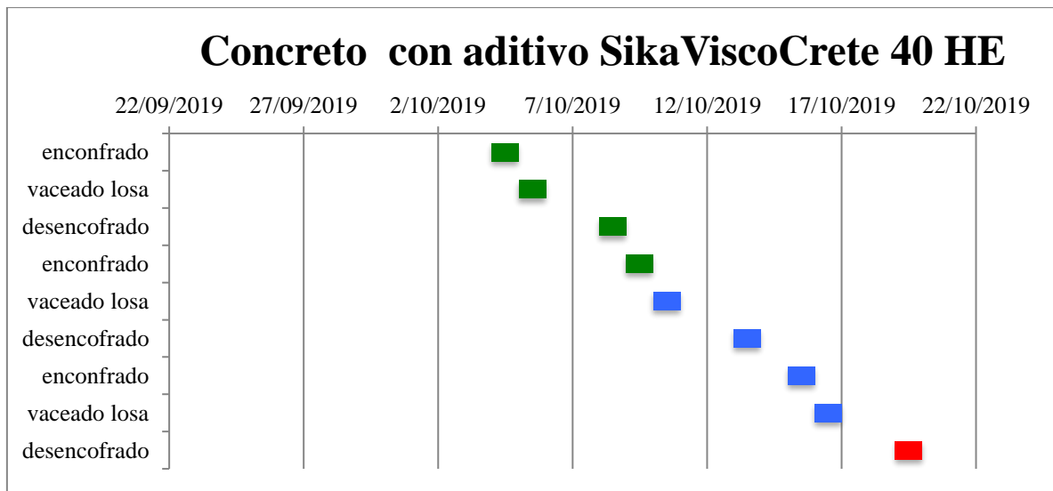
Figura 51 Diagrama de Gantt, para una vivienda de 3 pisos (solo considerando vaciado de losas)
