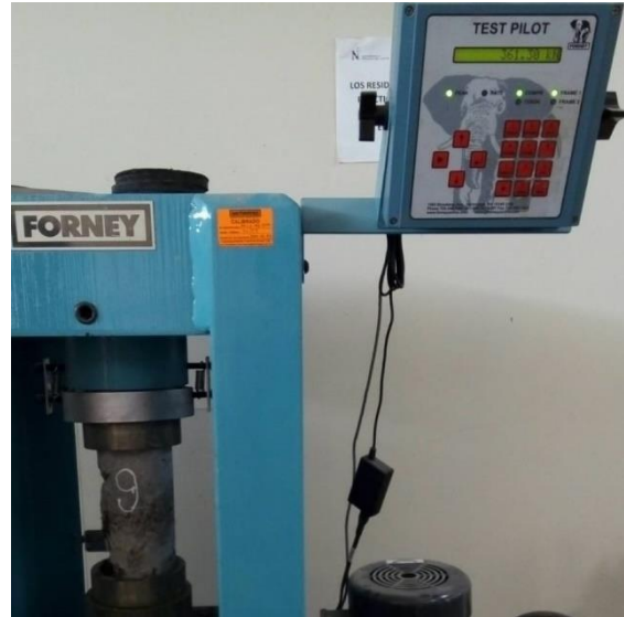
Figura 64 Resistencia a la compresión de 361.30 Kn
