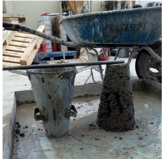
Figura 60. Toma de medida de Slump de 0".
