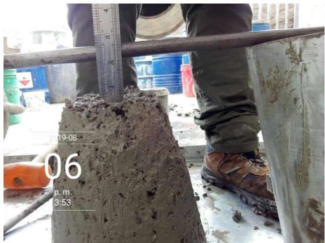
Figura 62. Toma de medida de Slump de 2".
