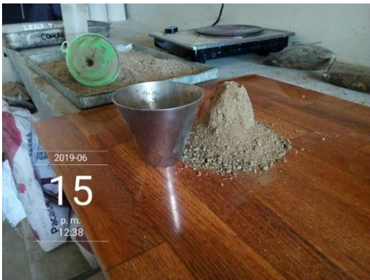
Figura 54 Prueba de cono para comprobar que la muestra está en estado s.s.s.
