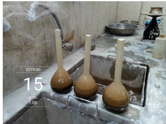
Figura 55. Fiolas en reposo para ensayo de peso específico.
