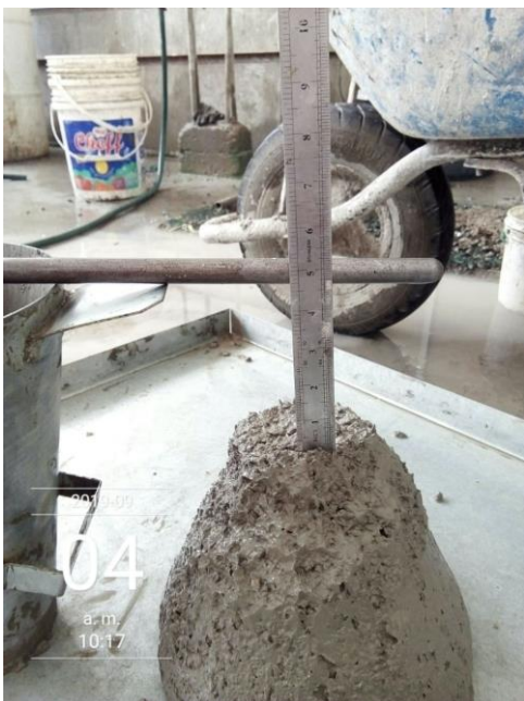
Figura 61. Toma de medida de Slump de 4.7".
