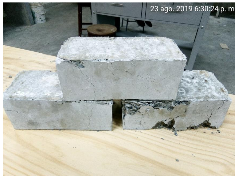
Figura 6: Adoquines sometidos a compresión
