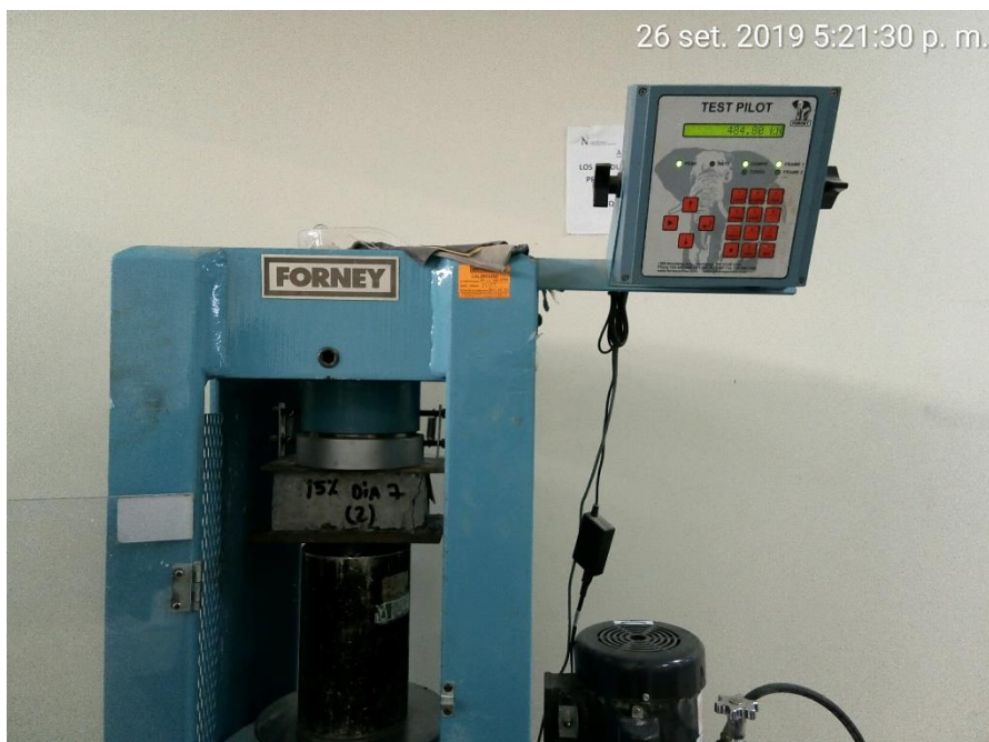
Figura 14: Adoquines de 15 % de adición de ceniza sometido a compresión
