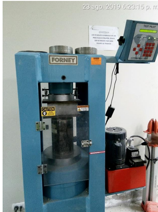
Figura 5: Adoquín puesto a resistencia a compresión
