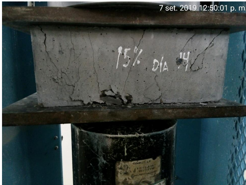
Figura 11: Falla lateral de adoquín después del ensayo de compresión
