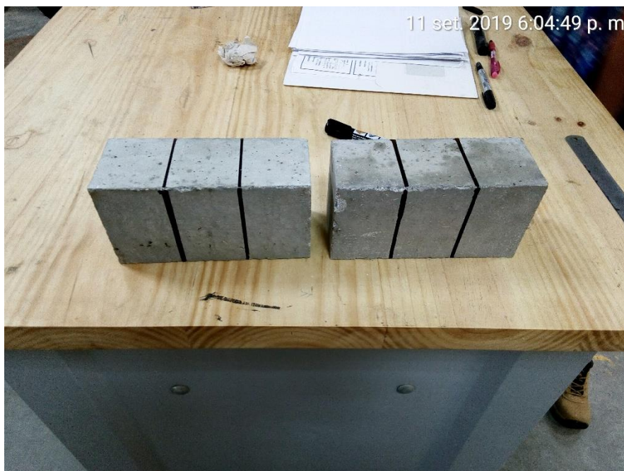
Figura 12: Cortes de probetas para ensayo de succión
