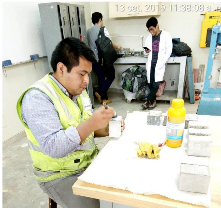
Figura 15: adoquines siendo impermeables con sika impermur para ensayo a succión
